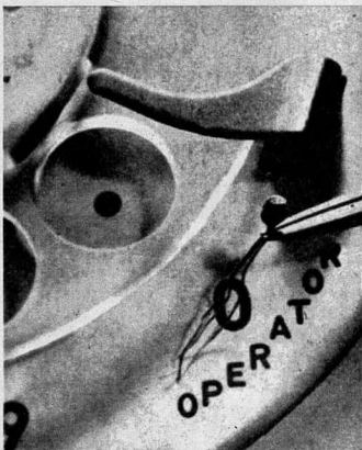
Il minuscolo microfono realizzato dalla Raytheon è dotato di una sensibilità compresa fra 0,01 e 120.000 cicli al secondo.
