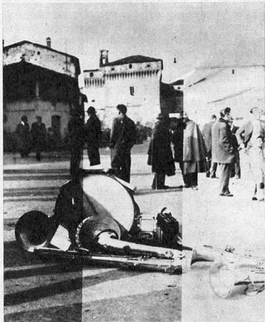
Fig. 6 - Esponendo successivamente tre uguali settori di un negativo con tempi diversi si ottiene una stampa di prova che indicherà l'esatto tempo di esposizione per una giusta densità.
