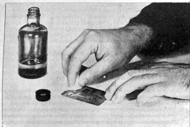
Fig. 7 - 8 - 9 - Per eliminare l'inchiostro e mettere in luce il rame si opera con l'apposito «solvente». Poi, mediante un trapano a mano, munito di punta da 1 mm., si praticano i fori in cui vanno ancorati i terminali dei componenti.
