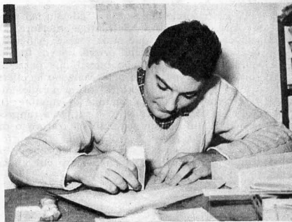
Fig. 2 - Tutti i pezzi di legno, prima di essere uniti tra di loro, vanno accuratamente lisciati ai bordi mediante impiego di cartavetrata.
