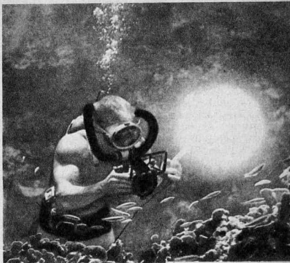
Fig. 2 - Questo tipo di camera stagna è sprovvisto dei piani alari che, pur essendo molto utili, non sono strettamente necessari.
