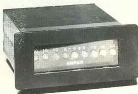
Foto 3 - Lo strumento racchiuso nell'apposito contenitore plastico, le cui ridotte dimensioni permettono una agevole installazione a bordo dell'autovettura.
