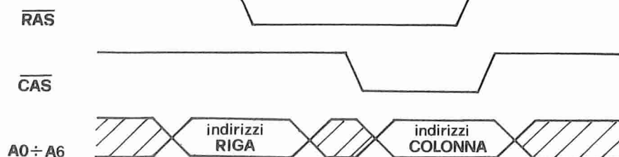
Fig. 7 - Temporizzazione dei segnali \overline{RAS} e \overline{CAS} , riferiti agli indirizzi A_0 - A_6 . Sulle linee di indirizzo devono essere presentati prima i bit configurati in modo da individuare la riga e poi, in un tempo successivo (a intervallo molto breve) i bit che individuano la colonna. Se ad esempio occorre indirizzare la cella 1500 ( 1024 + 256 + 128 + 64 + 16 + 8 + 4 , cioè numero binario 00-0101-1101-1100 organizzato su 14 bit), l'indirizzo binario è spezzato in due parti: 101-1100 che è la parte bassa ed individua la riga, 00-0101-1 che è la parte alta ed individua la colonna.
