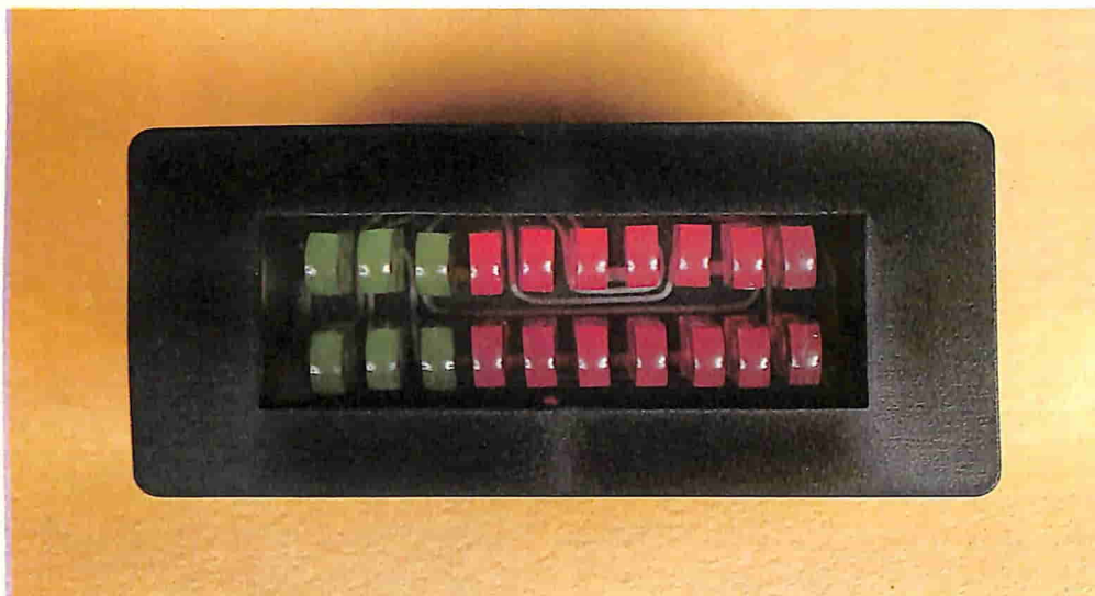
Vista del VU meter alloggiato nel contenitore GPE 023.
