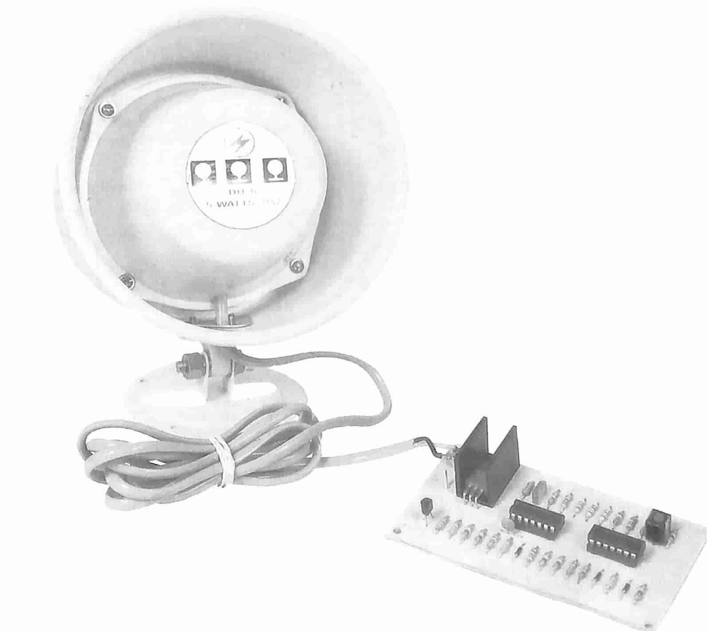
Scheda MK 220 collegata ad una sirena avente le caratteristiche da noi consigliate.
