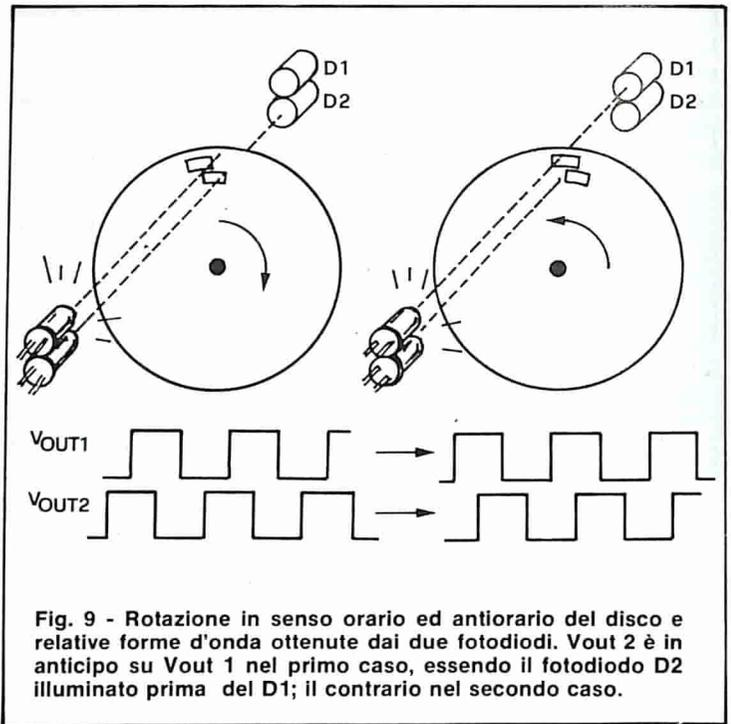
Fig. 9 - Rotazione in senso orario ed antiorario del disco e relative forme d'onda ottenute dai due fotodiodi.  $V_{out 2}$  è in anticipo su  $V_{out 1}$  nel primo caso, essendo il fotodiode D2 illuminato prima del D1; il contrario nel secondo caso.
