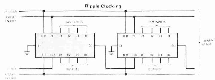
Fig. 9/b - Collegamento in cascata dei contatori 4029.
