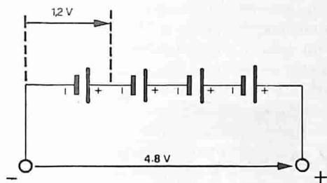
Fig. 6 - Serie di quattro pile da 1,2 V per ottenere 4,8 V.
