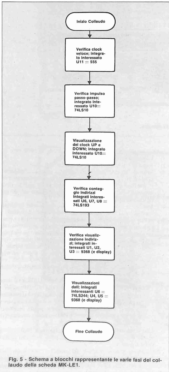
Fig. 5 - Schema a blocchi rappresentante le varie fasi del collaudo della scheda MK-LE1.
