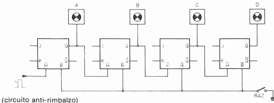
Fig. 1 - Realizzazione di un contatore con due SN 7473
