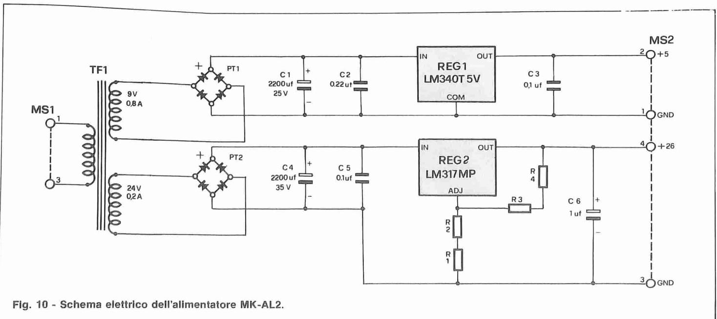
Fig. 10 - Schema elettrico dell'alimentatore MK-AL2.
