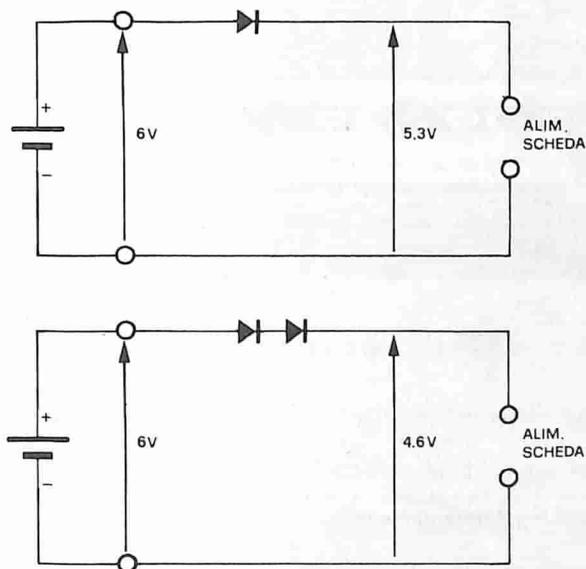
Fig. 7 - Abbassamento di tensione per poter alimentare la scheda MK-GT1 con una pila da 6 V.
