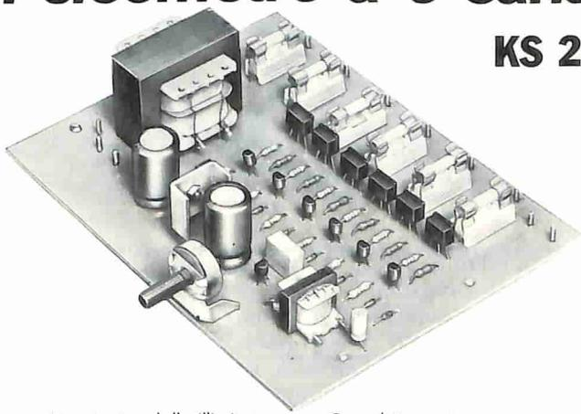
Un circuito dalle illimitate applicazioni, che funziona come VU-meter a scala lineare con luci di potenza fino a 300 W per canale 1800 W in totale.
