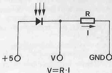
Fig. 3 - Circuito esemplificativo per ottenere un segnale in tensione del fotodiiodo.
