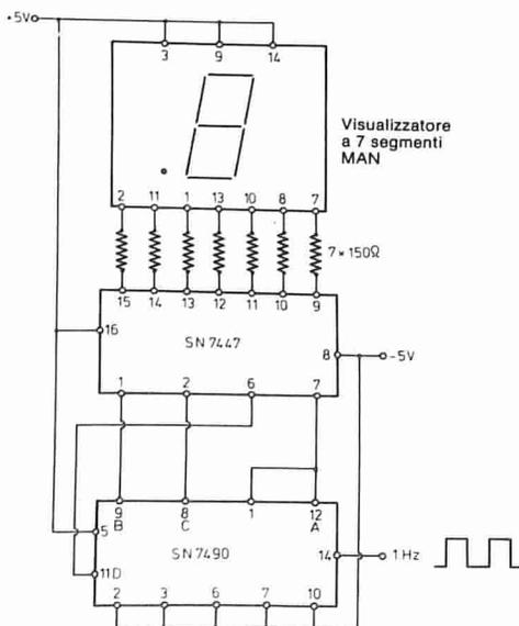
Fig. 10 - Circuitazione di un contatore per 10.
