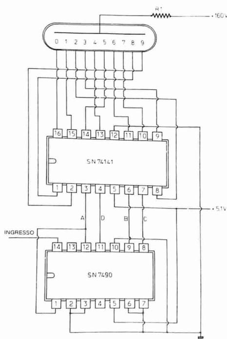
Fig. 4 - Realizzazione circuitale di un decodificatore con tubi Nixie.
