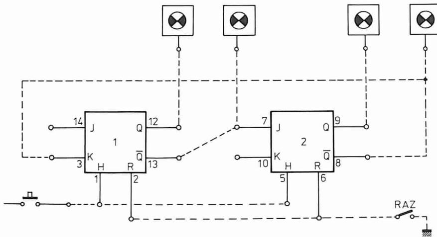
Fig. 2 - Circuito di contatore per tre
