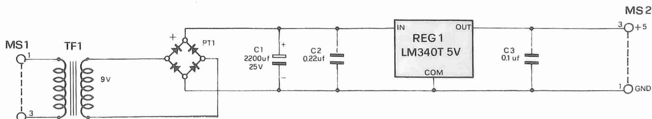
Fig. 8 - Schema elettrico dell'alimentatore MK-AL1.
