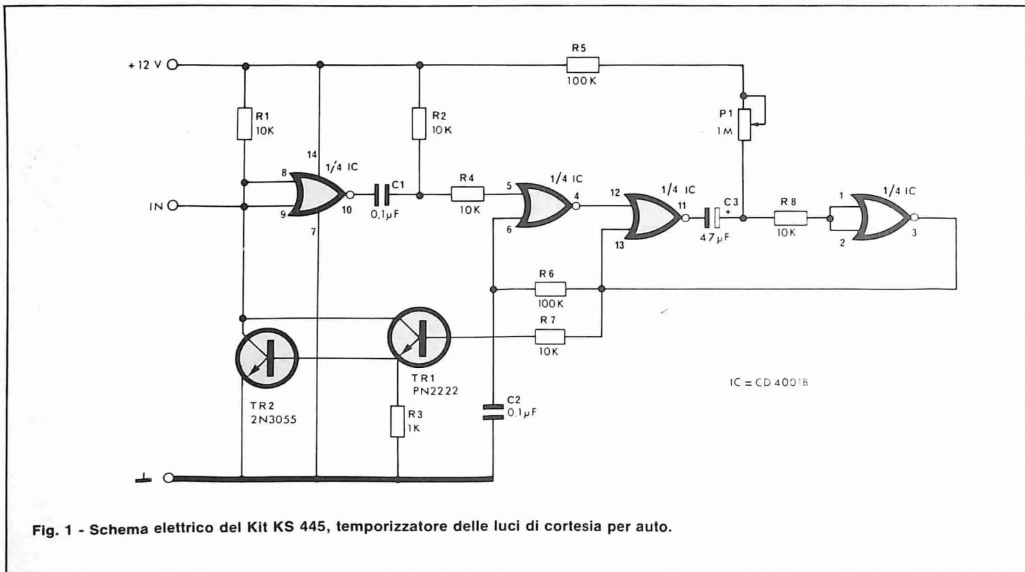
Fig. 1 - Schema elettrico del Kit KS 445, temporizzatore delle luci di cortesia per auto.
