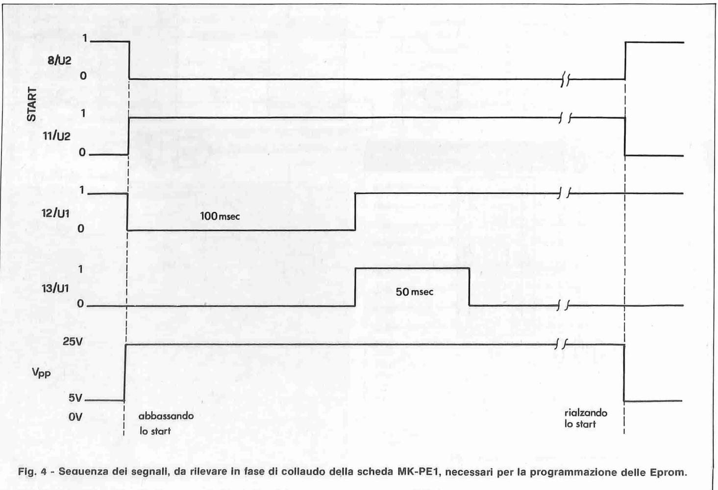
Fig. 4 - Sequenza dei segnali, da rilevare in fase di collaudo della scheda MK-PE1, necessari per la programmazione delle Eprom.
