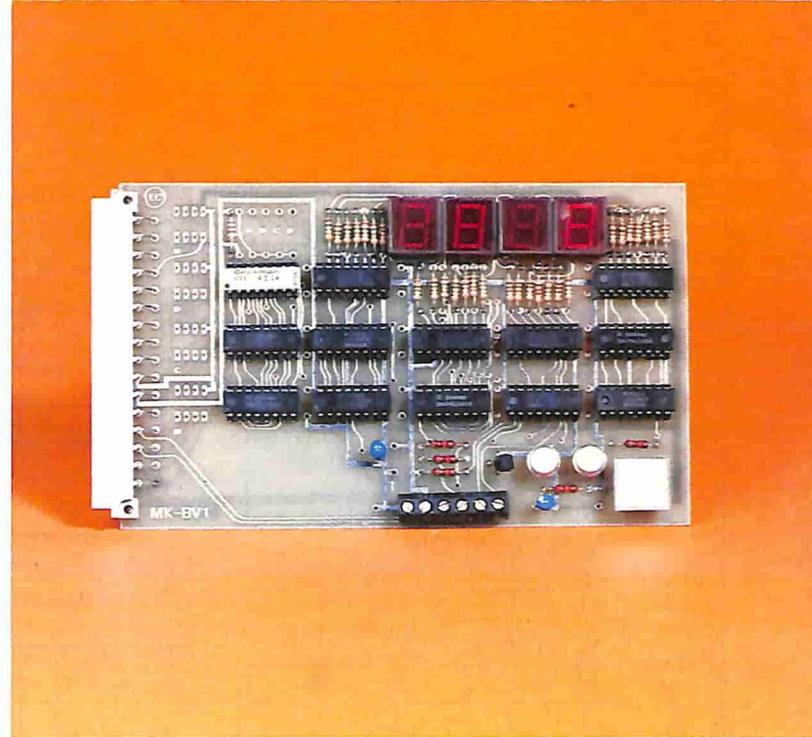
Scheda MK-BV1 con connettore per collegamento impostatori.
