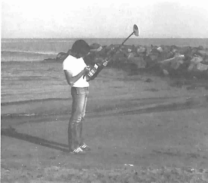
**Fig. 8 - Effettuate le diverse regolazioni "in loco" ci si deve accertare che l'indice sia rimasto "centrato" e che il segnale audio sia al giusto livello. In caso contrario si dovrà ripristinare la miglior sintonia.**
