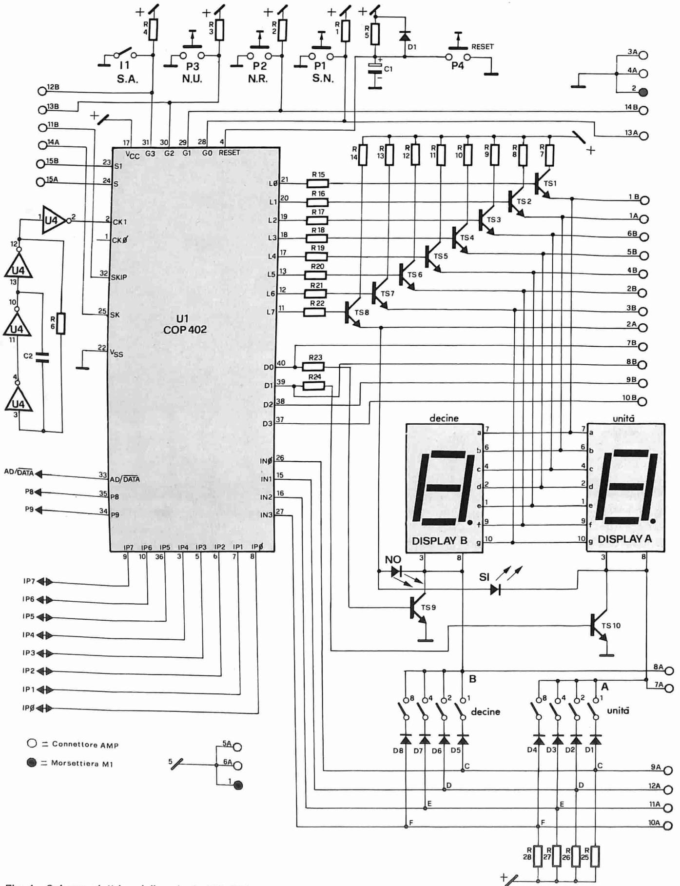
Fig. 1 - Schema elettrico della scheda MK-GT1.
