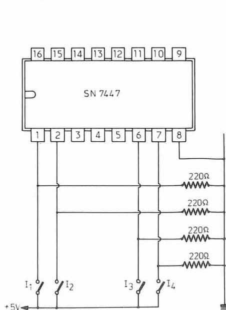
Fig. 8 - Collegamenti da effettuarsi sul box per realizzare la figura 7.
