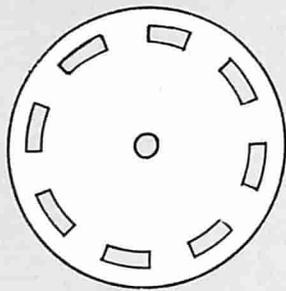
Fig. 1 - Disco rotante contenuto in encoder.
