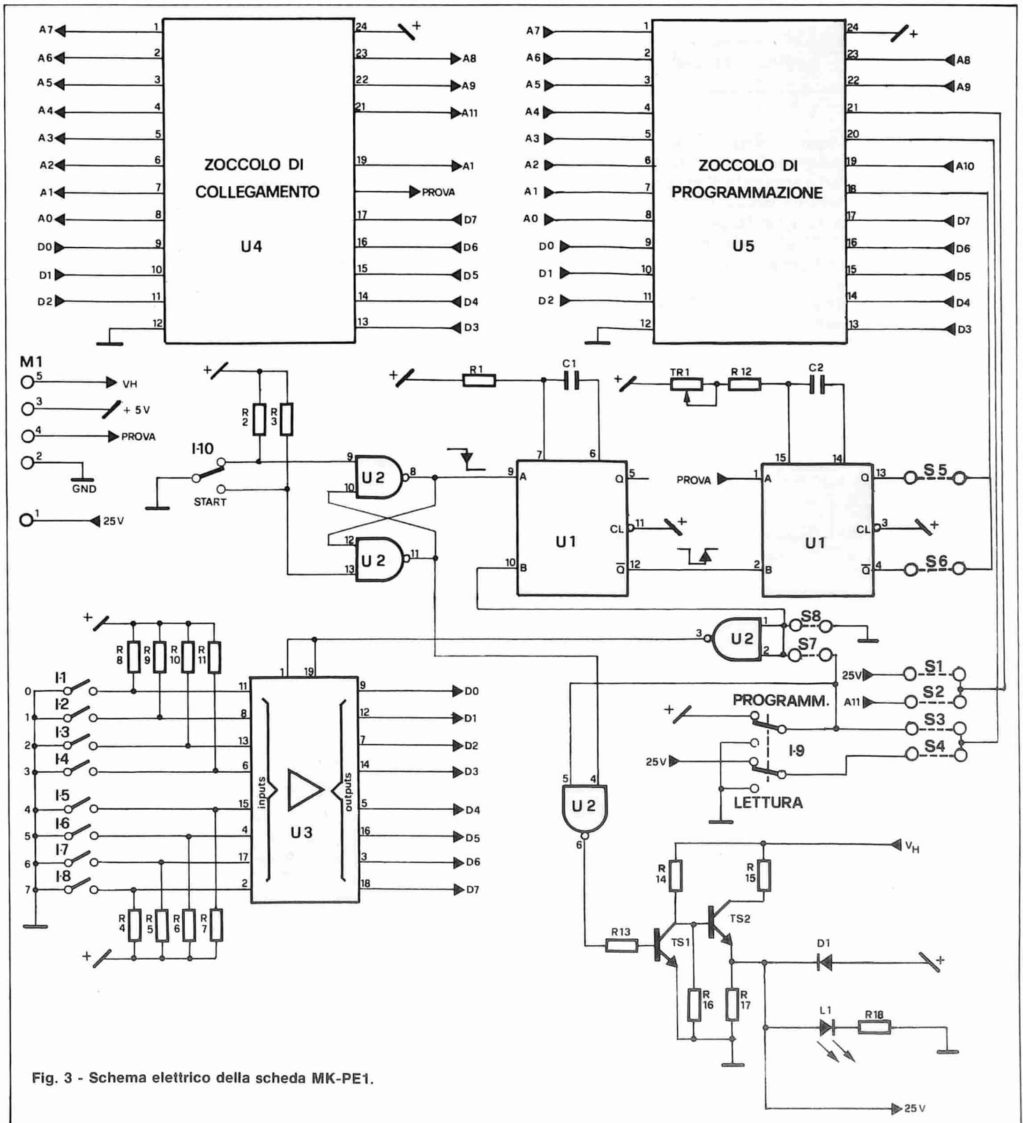
Fig. 3 - Schema elettrico della scheda MK-PE1.
