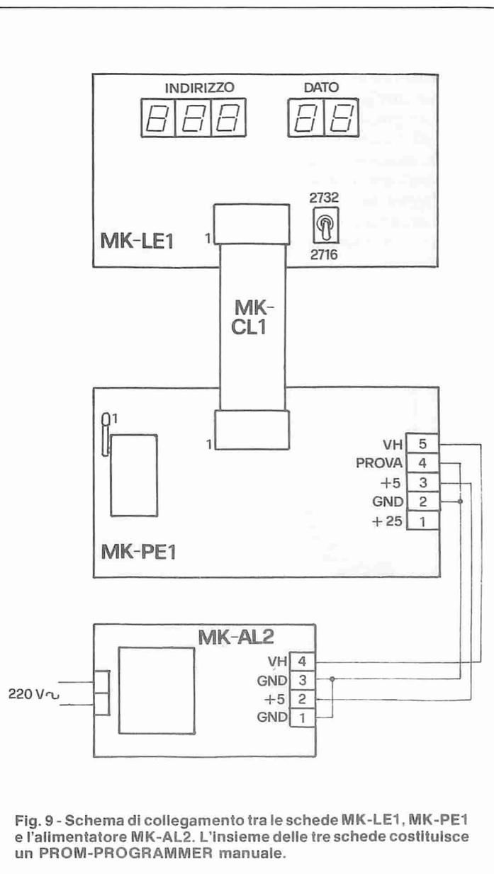
Fig. 9 - Schema di collegamento tra le schede MK-LE1, MK-PE1 e l'alimentatore MK-AL2. L'insieme delle tre schede costituisce un PROM-PROGRAMMER manuale.
