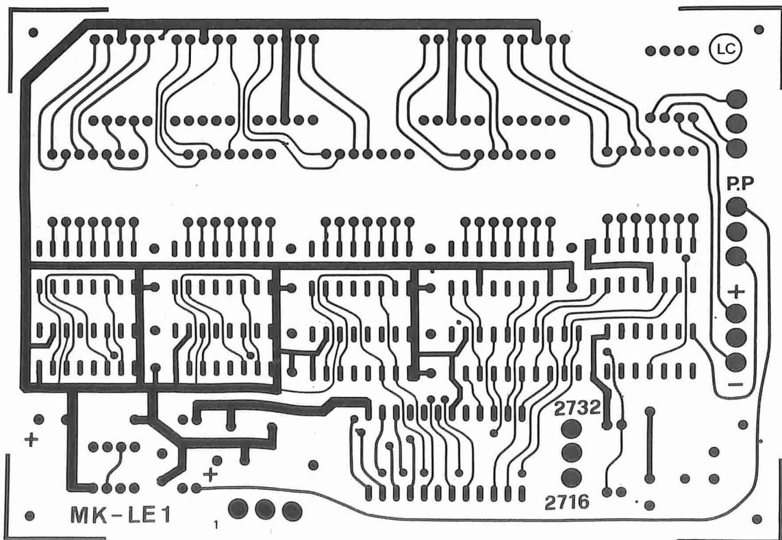
Fig. 4 - Schema di montaggio della scheda MK-LE1 sopra. Master in scala 1:1 sotto.
