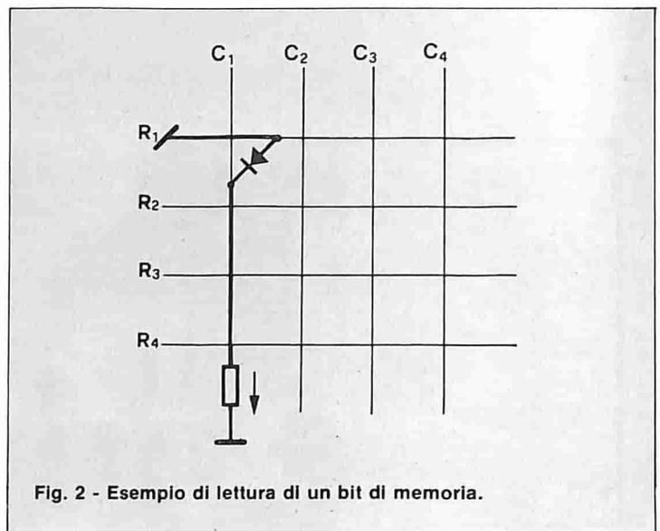
Fig. 2 - Esempio di lettura di un bit di memoria.
