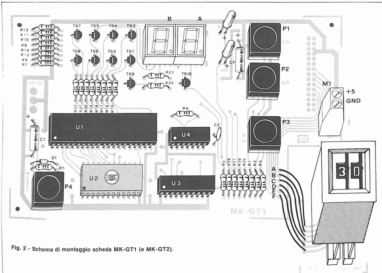
Fig. 2 - Schema di montaggio scheda MK-GT1 (e MK-GT2).
