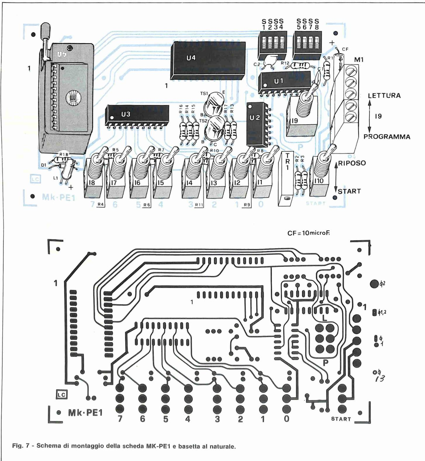
Fig. 7 - Schema di montaggio della scheda MK-PE1 e basetta al naturale.
