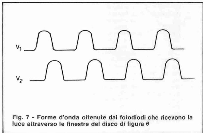
Fig. 7 - Forme d'onda ottenute dai fotodiodi che ricevono la luce attraverso le finestre del disco di figura 6
