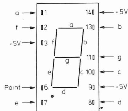
Fig. 9 - Zoccolatura di display Monsanto. In a) schema di logica circuitale del display. In b) contenitore.
