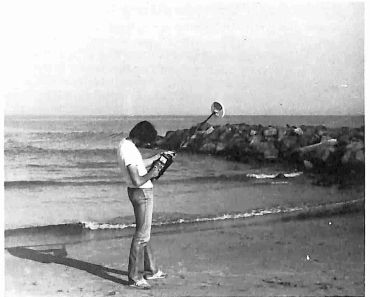
**Fig. 6 - Regolazione dei controlli per l'esclusione dell'effetto "del terreno".**
