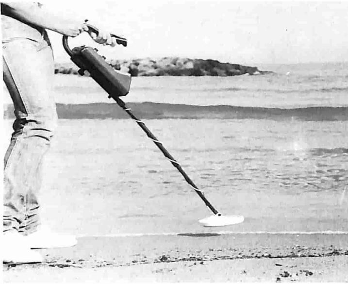
**Fig. 4 - Metodo erroneo di esplorazione. Serve una mano sola per sorreggere equilibratamente il rivelatore. Procedendo come si vede, ci si affatica anzitempo.**
