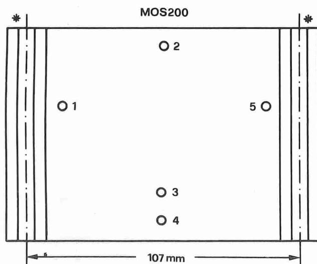
\* Indica una scanalatura a “T” nelle alette, che serve per facilitare il montaggio. Con gli amplificatori sono fornite le viti e i dadi adatti
