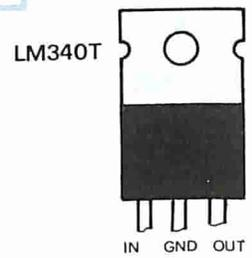
Fig. 9 - Schema di montaggio dell'alimentatore MK-AL1 e zoccolatura del regolatore impiegato.
