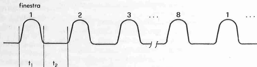
Fig. 4 - Forme d'onda ottenute ai capi di R del circuito di figura 3.
