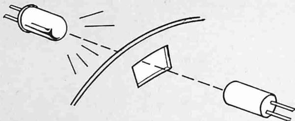
Fig. 2 - Simulazione di un fotodiiodo che riceve la luce attraverso la finestra del disco rotante.
