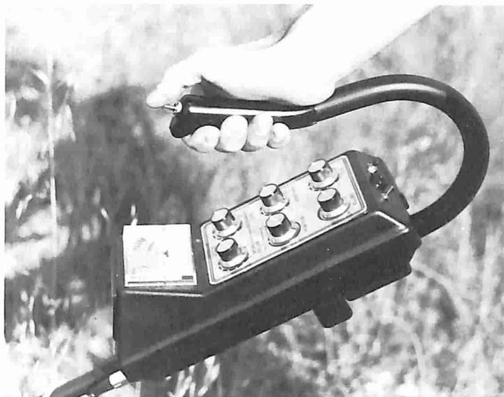
Fig. 1 - C-SCOPE VLF/TR 3000 ADC: azionamento del deviatore a leva, posto sulla manopola di sollevamento, che serve a stabilire la "qualità" del ritrovato.
