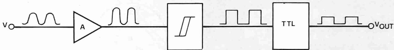
Fig. 5 - Schema a blocchi del circuito da utilizzare per ottenere un onda quadra a logica TTL partendo dal segnale di figura 4.
