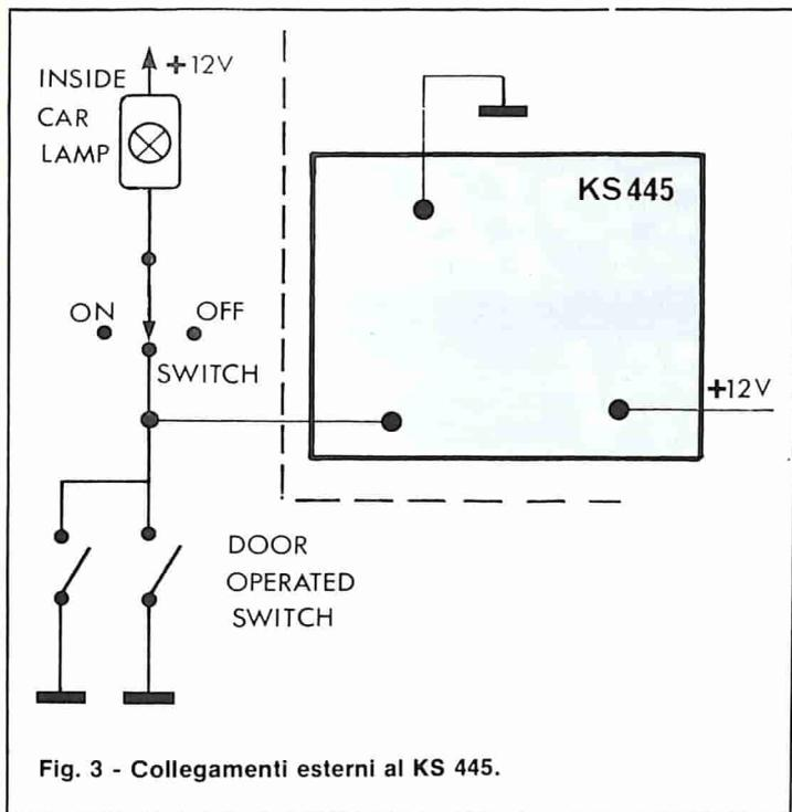
mati nella "battuta" degli sportelli. I collegamenti dovranno essere abbastanza lunghi da poter nascondere la basetta dietro alla plancia-strumenti, in modo da non disturbare l'estetica interna. Prima di collocare definitivamente il sistema elettronico nel punto che si è scelto, si regolerà il trimmer del ritardo automatico.
