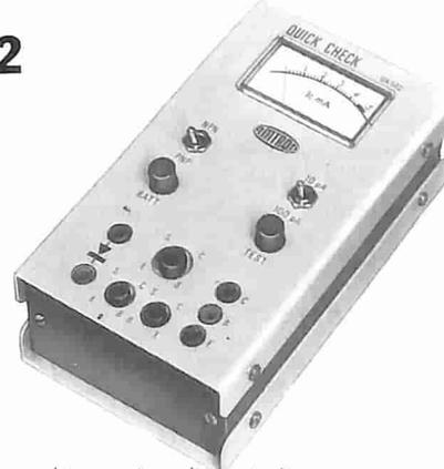
Un apparecchio pratico, di facile uso, leggero, portatile. Misura il beta dei transistori NPN e PNP, e fornisce una chiara indicazione della funzionalità di transistori e diodi pur senza necessitare di complicate procedure di misura o di calcoli. Indispensabile nella borsa e nel laboratorio del tecnico, dello studioso e del dilettante.
