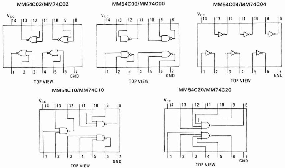
Fig. 11 - Caratteristiche e piedinatura di alcune tra le più comuni porte logiche (NAND, NOR e INVERTER).
