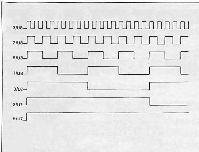
**Fig. 8 - Forme d'onda che dovete riscontrare sui vari pin dei contatori. La figura riporta le prime sette configurazioni; proseguendo nella visualizzazione dei pin 7/U7, 3/U6, 2/U6, 6/U6 e 7/U6 ritroverete sempre la frequenza dimezzata.**
