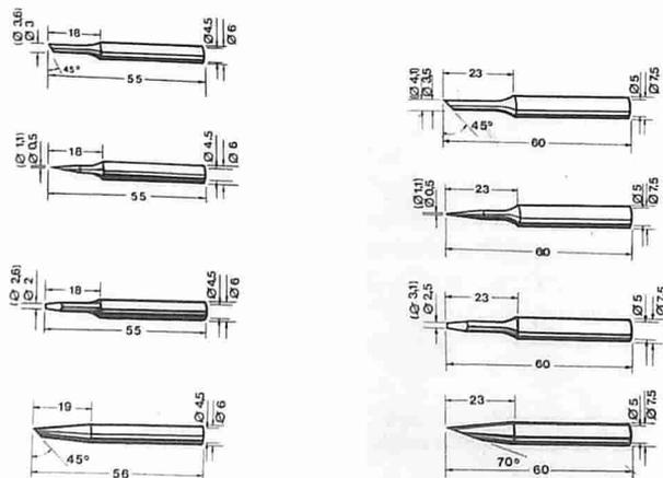
**Fig. 2 - Serie di punte di ricambio per i saldatori ERSA: tipo 230 da 15 W e 25 W.**
