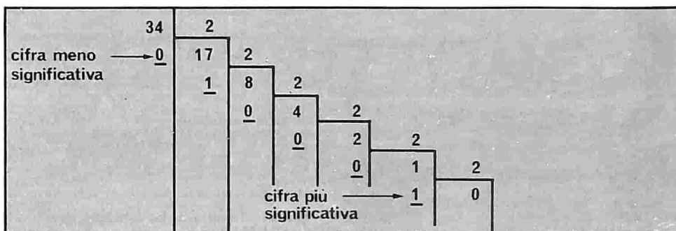
Fig. 5 - Esempio di conversione dal sistema decimale a quello binario.
