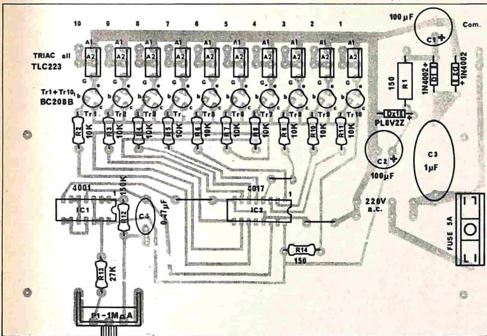
Fig. 2 - Disposizione dei componenti sulla bassetta a circuito stampato del KS 262.
