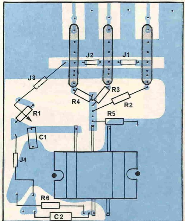
Fig. 15/B - Disposizione dei componenti sulla basetta a circuito stampato in relazione allo schema di figura 15.
