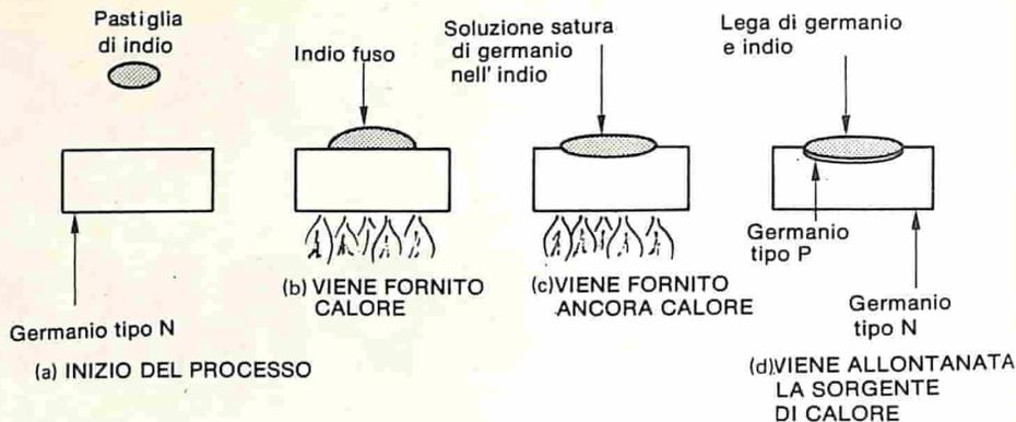
Fig. 2.2 - Il processo detto "di lega" per la realizzazione di una giunzione P-N.
