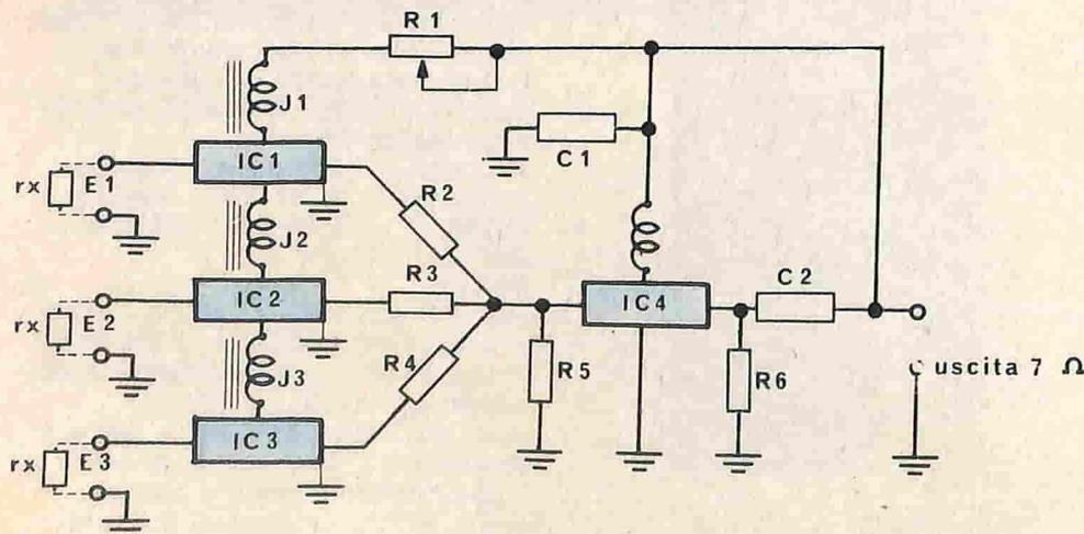
Fig. 15 - Schema elettrico di amplificazione a larga banda con guadagno di 40 dB.
