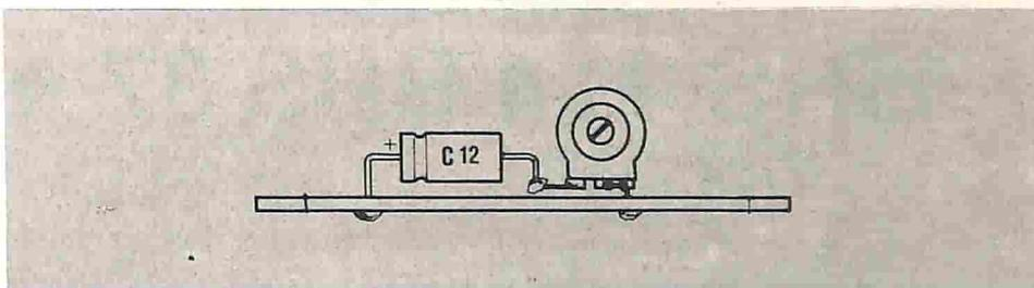
Fig. 9 - Montaggio pratico del trimmer R18 e del condensatore elettrolitico C12.
