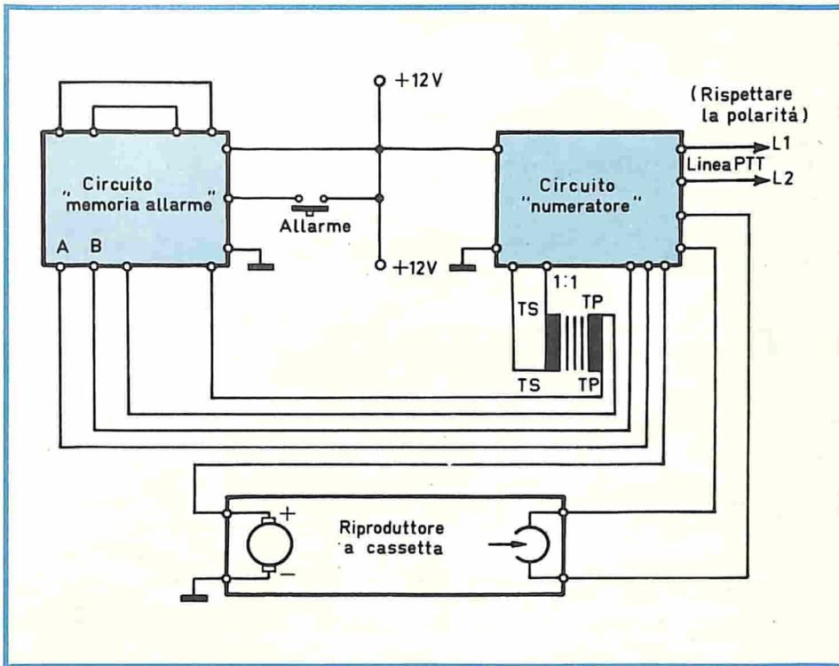
Fig. 8 - Registrazione su cassetta: Decodificazione e composizione del numero da registrare. Prima di riattaccare, attendere un tempo sufficiente ad assicurare la chiamata ed un determinato numero di squilli.
