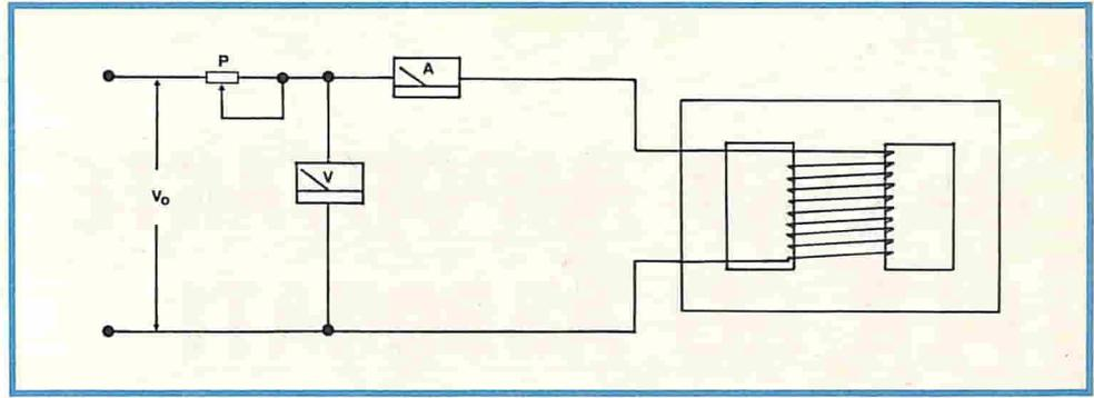
Fig. 6 - Circuito di prova di un trasformatore.
