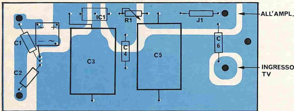
Fig. 10/A - Realizzazione pratica dell'alimentatore stabilizzato.
