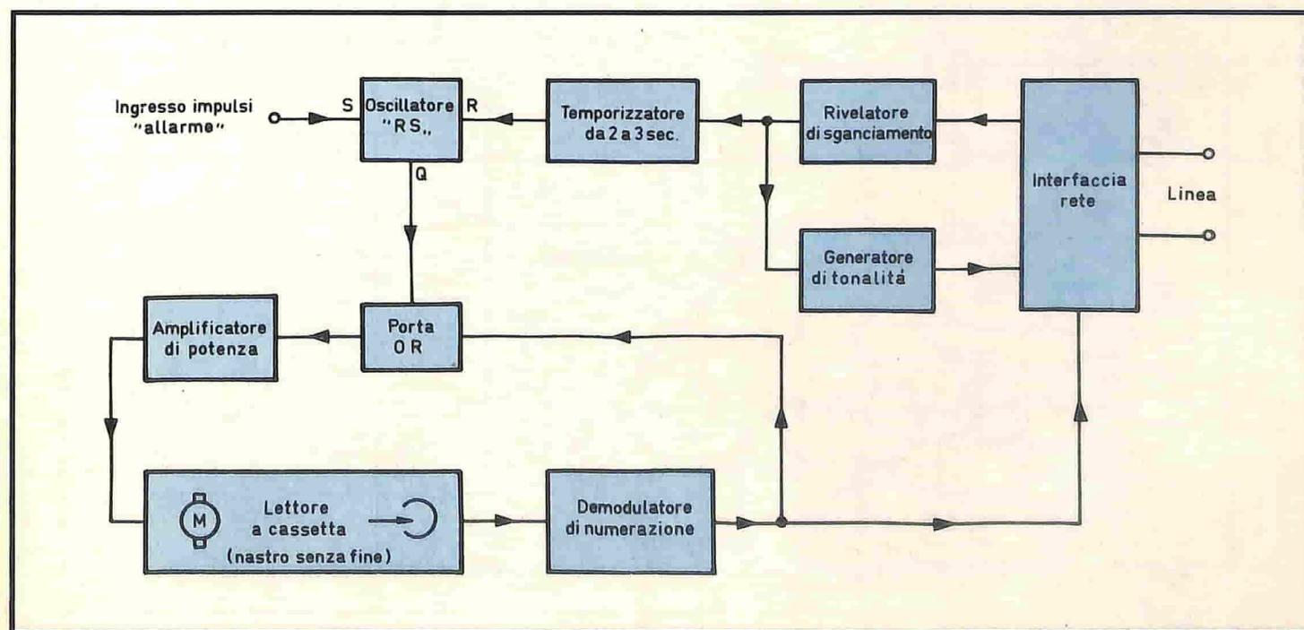
Fig. 1 - Schema a blocchi dell'apparato. Il generatore di tonalità può venire sostituito da un magnetofono trasmittente un messaggio e da un circuito codificatore.
