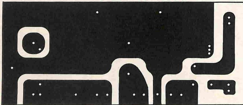
Fig. 10/B - Circuito stampato lato rame in scala 1 : 1.
