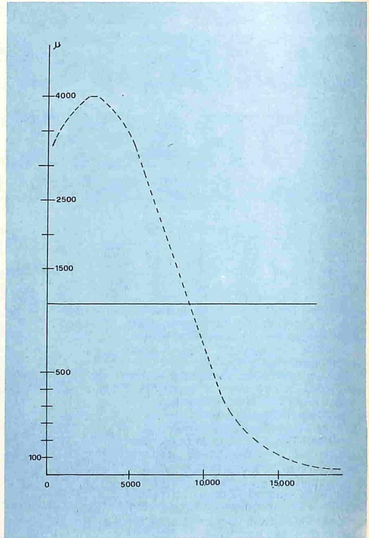
Fig. 4 - Grafico relativo alla permeabilità in funzione dell'induzione magnetica.
