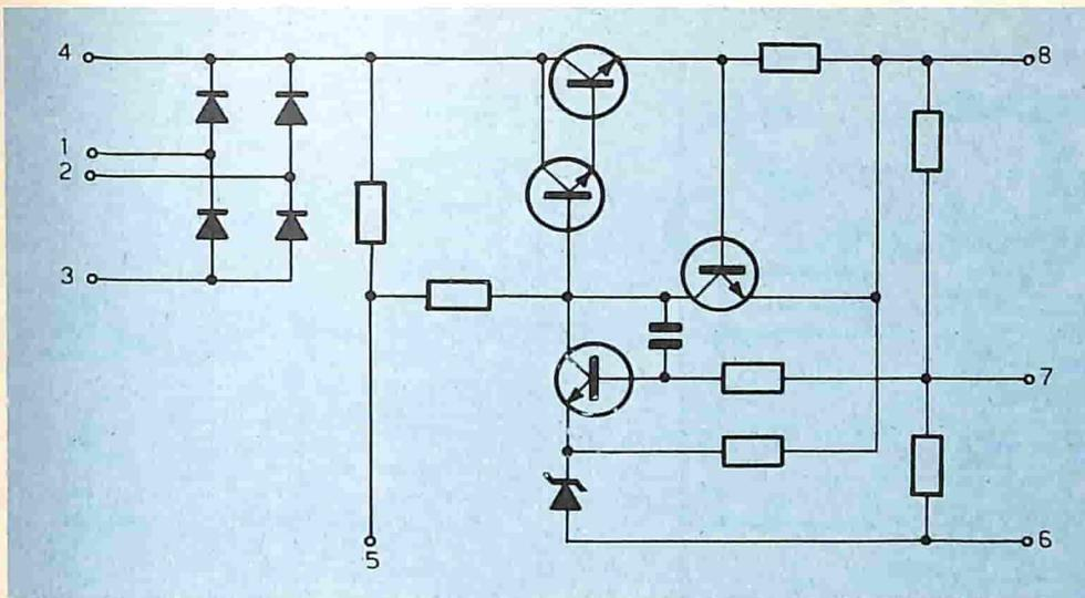
Fig. 2 - Schema interno del circuito ibrido, attraverso il quale risulta più facile comprendere il funzionamento dell'intero alimentatore.
