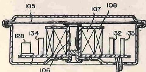
Fig. 8 - Vista in sezione dell'auricolare con all'interno il piccolo stampato.
