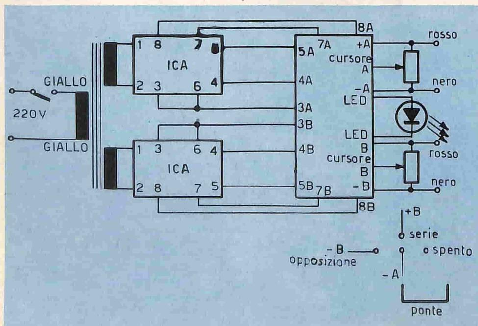
Fig. 6 - Schema dei diversi collegamenti che devono essere effettuati tra il trasformatore, le due unità ibride ed il circuito stampato realizzato a parte.
