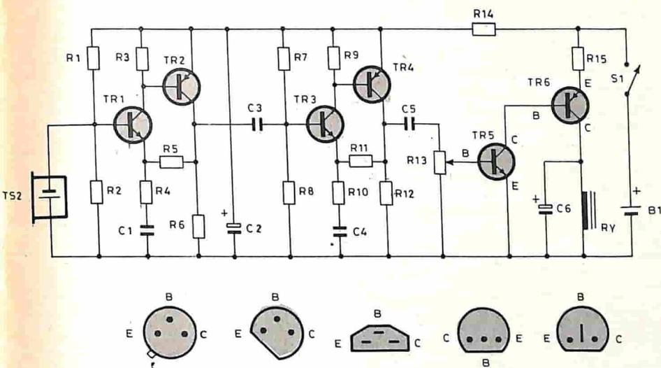
Fig. 2 - Circuito ricevitore del sistema ultrasonico.
