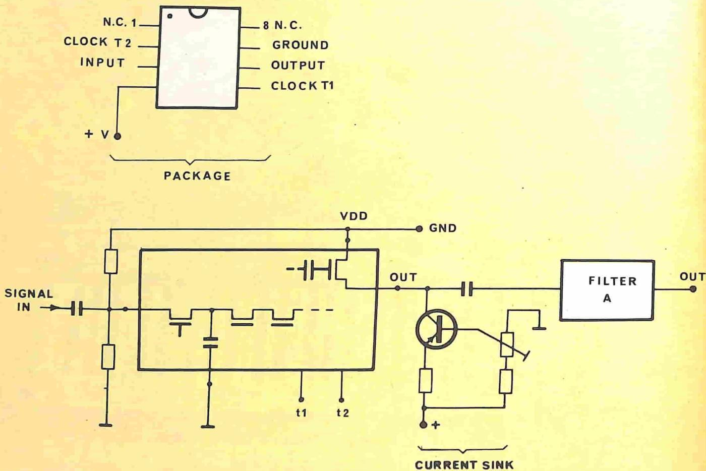
Fig. 1 - Zoccolatura e schema interno dell'integrato TCA 350Y
