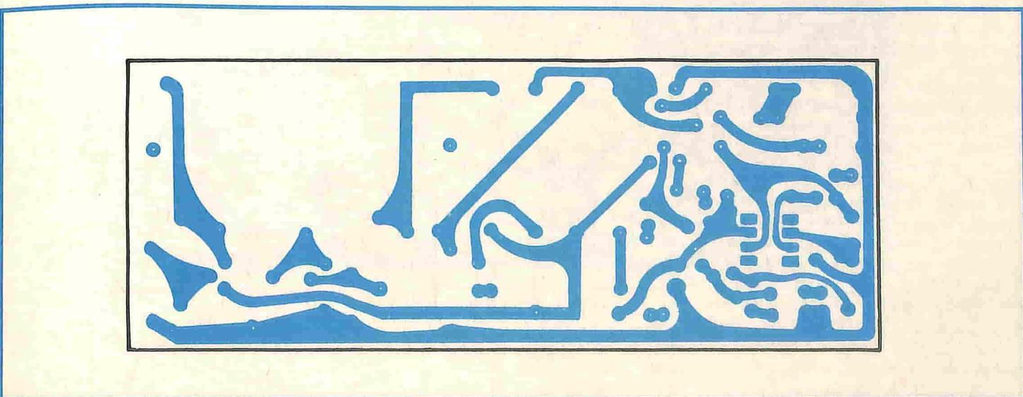
Fig. 4 - Circuito stampato "motore" lato rame.
