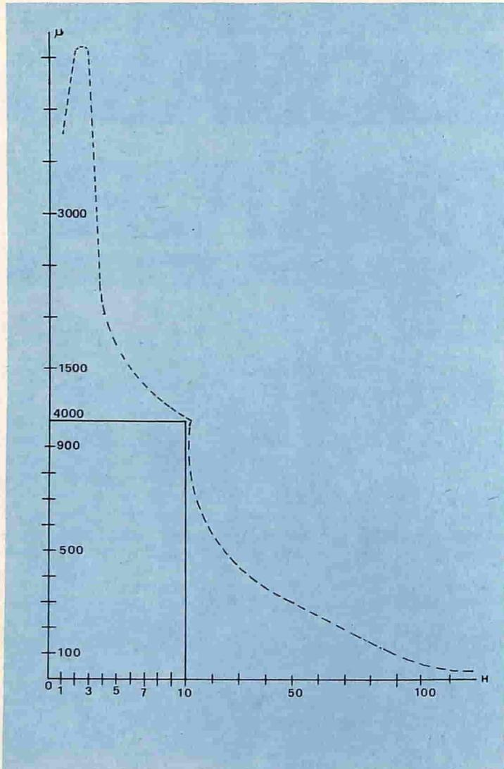
Fig. 3 - Grafico relativo alla permeabilità magnetica dipendente dal valore di H.
