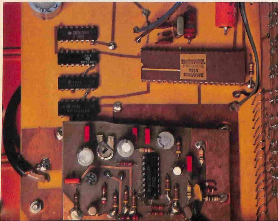
elaborazione, perché per le misure nelle frequenze medio-alte, il limite di 50 MHz è ottimo, difatti è scelto per innumerevoli strumenti in commercio, e per le frequenze elevate, basta aggiungere un prescaler qualunque che dividendo da 10 ad 1, porti il valore a 500 MHz, altro limite "classico".
