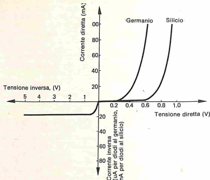
Fig. 2.6 - Caratteristiche corrente/tensione per:
