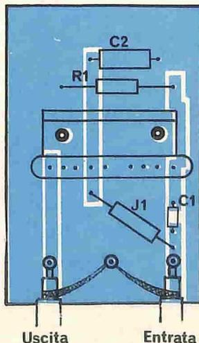
Fig. 12/A - Realizzazione pratica con amplificatori a 9 terminali.
