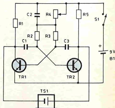
Fig. 1 - Circuito trasmettitore del sistema ultrasonico.
