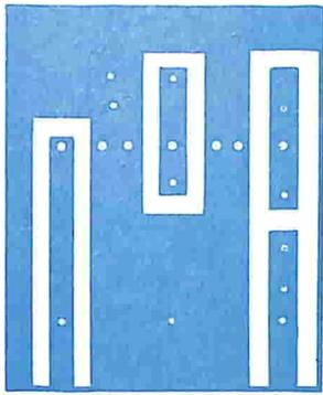
Fig. 11 - Basetta a circuito stampato adatta ad amplificatori a 7 terminali.
