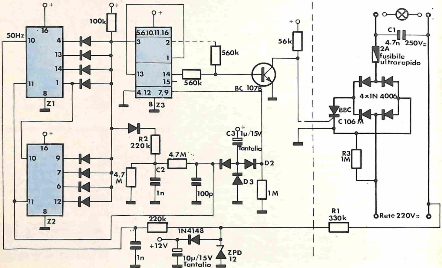
Fig. 2 - Circuito dell'interruttore per orario elettronico.
