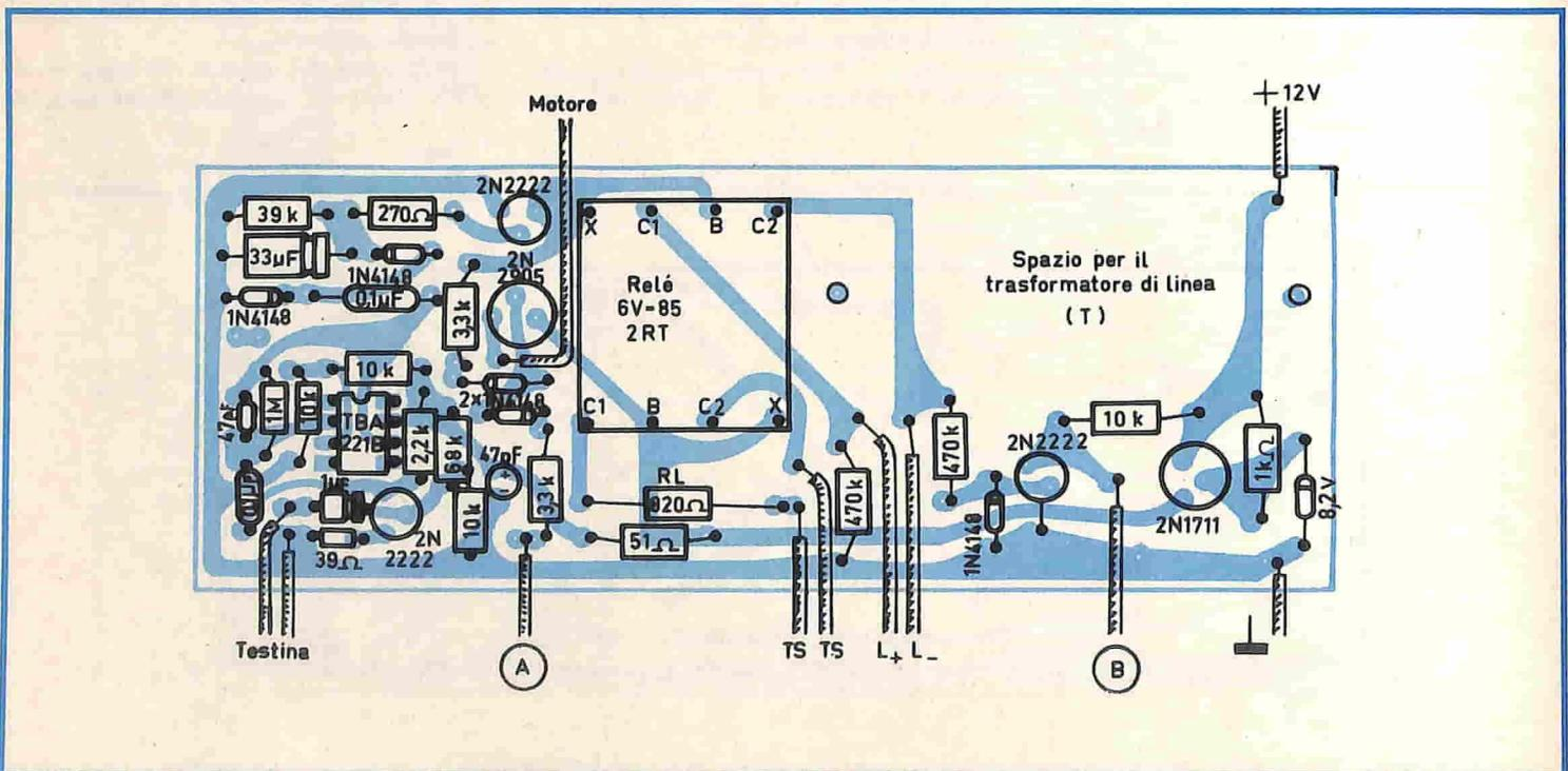
Fig. 6 - Circuito "motore" lato componenti.
