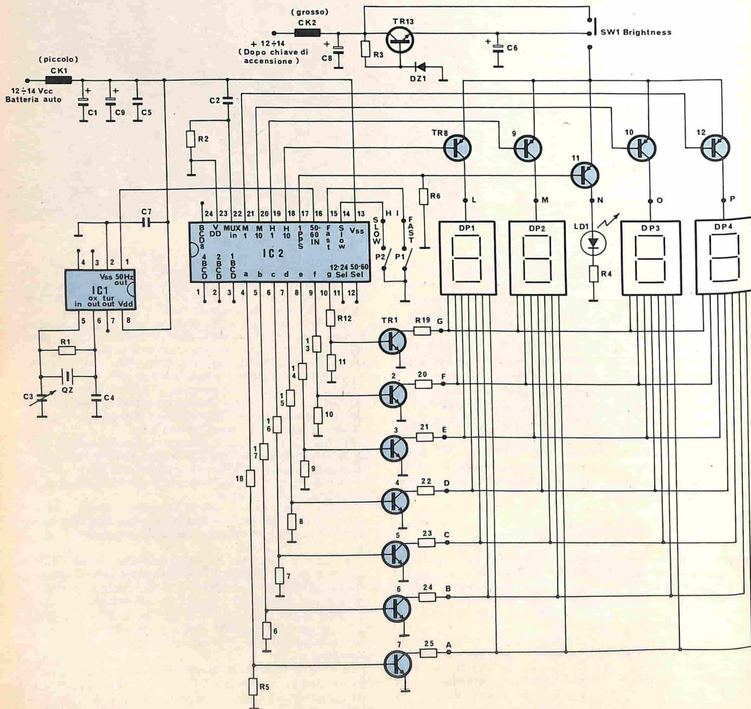
Fig. 1 - Schema elettrico completo dell'orologio a led per auto. Da notare la possibilità tramite l'ingresso CK2 di disattivare solo il display qualora l'auto rimanga spenta.
