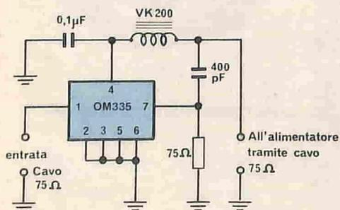
Fig. 10/C - Schema elettrico dell'amplificatore a larga banda da installare in prossimità dell'antenna
