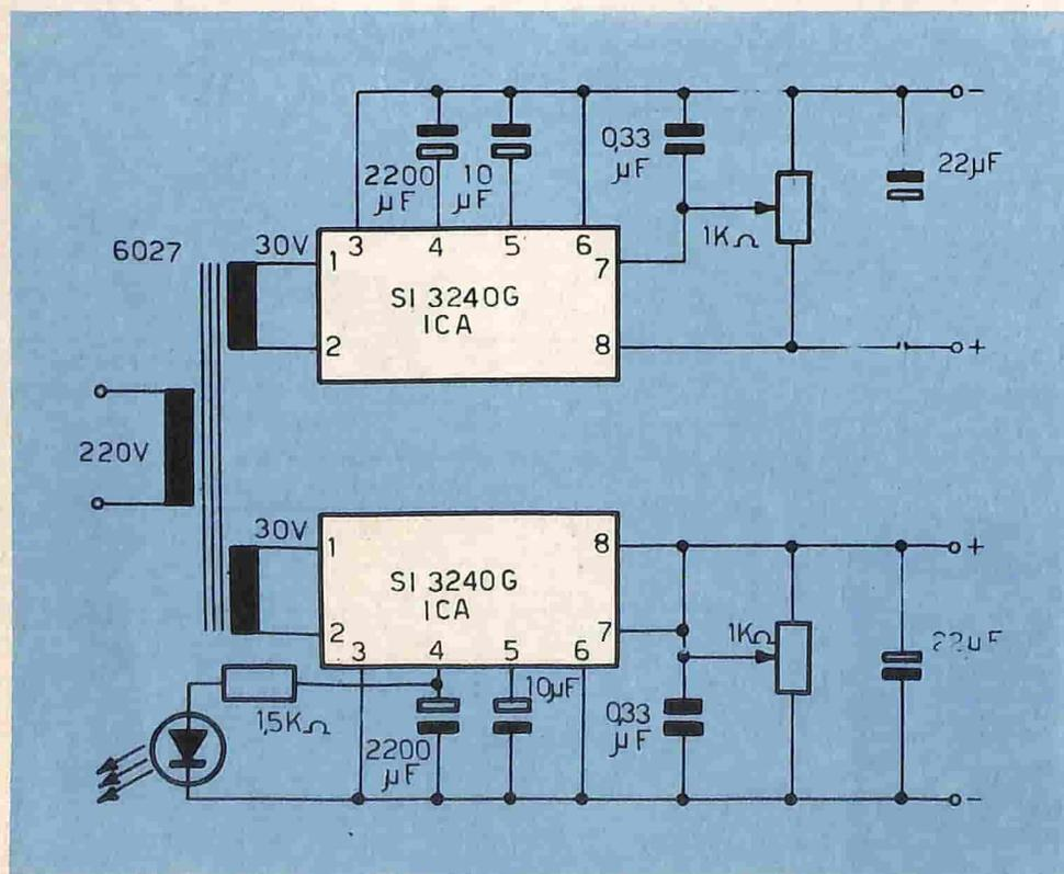
Fig. 1 - Schema elettrico dell'alimentatore, basato sull'impiego di due unità ibride tipo SI 3240 G.
