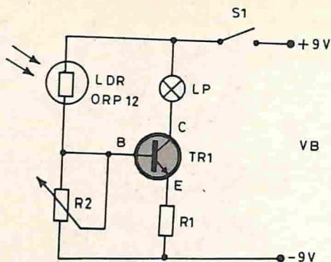
Fig. 1 - Schema del circuito del giuochino della candela.
