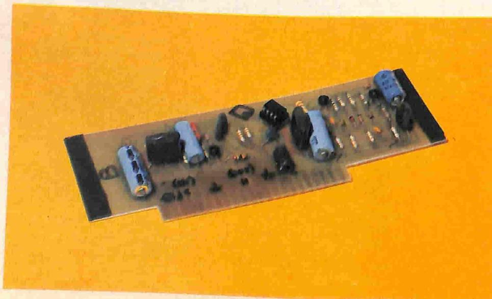
pilotando ciascuno dei moduli con una di tali uscite, otterremo, miscelando i due segnali di output dalle Analogue Delay Lines, un segnale formato dalla sovrapposizione di due forme d'onda pressoché identiche, ma il cui SFASAMENTO istantaneo risulta variabile in modo casuale e ciò ha come effetto "sensoriale" l'impressione di un coro di strumenti identici.
