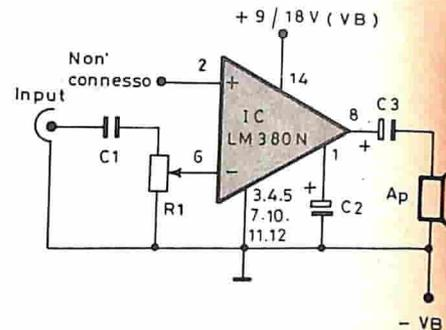
Fig. 3 - Schema elettrico dell'amplificatore audio IC da 2 W.
