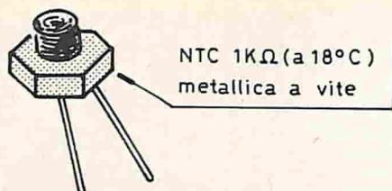
Fig. 3 - NTC usato per il termostato a quarzi.
