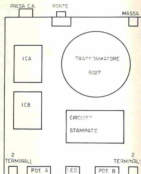
Fig. 7 - Disposizione all'interno del contenitore metallico delle diverse unità.
