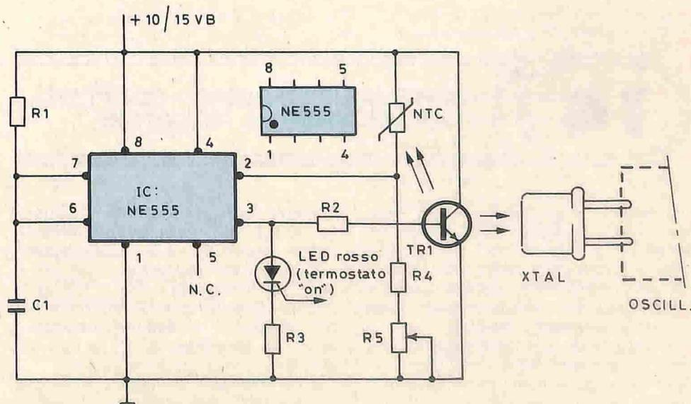
Fig. 1 - Circuito termostatico impiegante IC 555.
