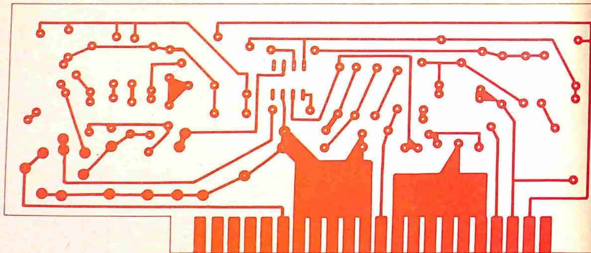
Fig. 3 - Circuito stampato visto dal lato rame del generatore di coro.
