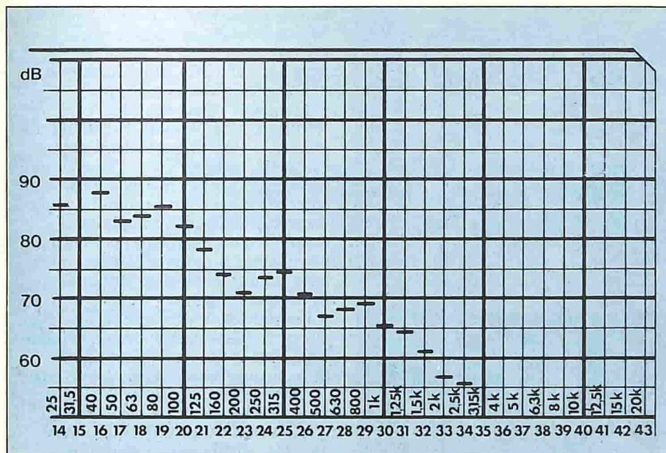
Fig. 2 - Rumori parassiti in un autoveicolo di classe media a 130 km/h.
