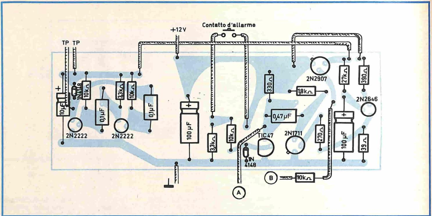
Fig. 5 - Circuito "memoria allarme" lato componenti.
