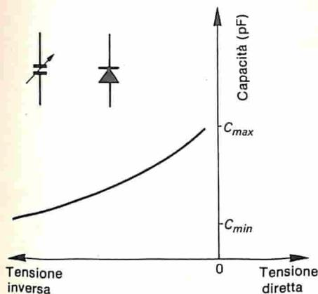
Fig. 2.11 - Caratteristica capacità/tensione per un diodo varactor.
