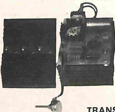
**Mod. 3** - Volt da 0,7 a 30 - carico max 6,5 A corrente lavoro 5 A autoprotetto contro i cortocircuiti.
