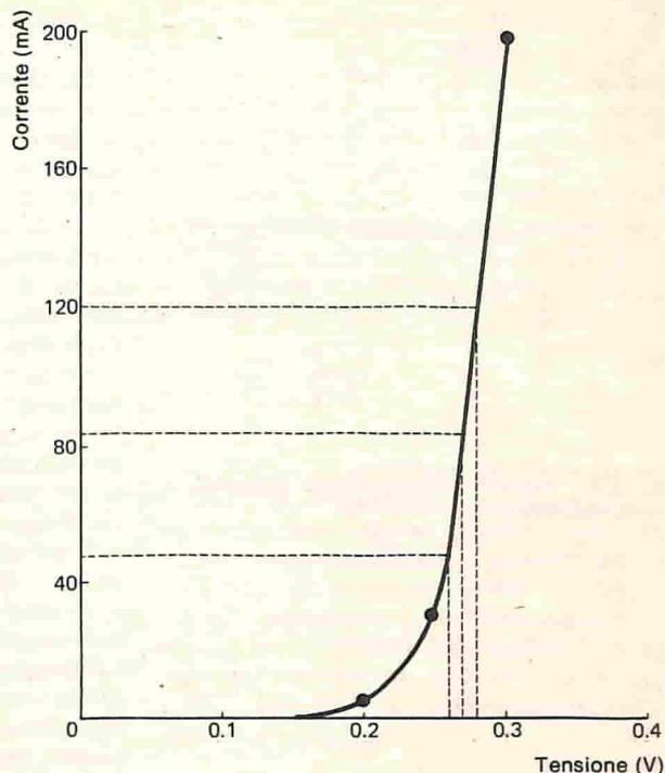
Fig. 2.8 - Caratteristica corrente/tensione (nella sola zona di conduzione diretta di polarizzazione diretta) per il diodo considerato nell'esempio 2.2.
