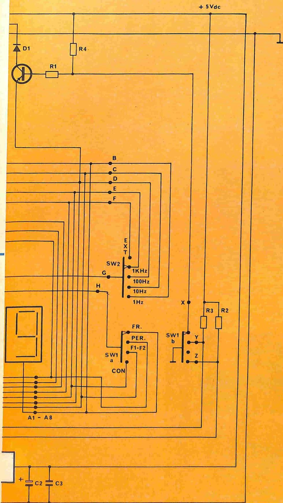
prevista per essere impiegata con display LED a sette segmenti muniti di anodo comune, l'altra, "B" sempre impiegabile con sistemi a sette segmenti, ma con il catodo comune. Non vi sono altre differenze funzionali, o di prestazioni. Noi abbiamo scelto il modello ICM 7226/ A perché i display con anodo comune a nostro parere sono più facilmente reperibili.
