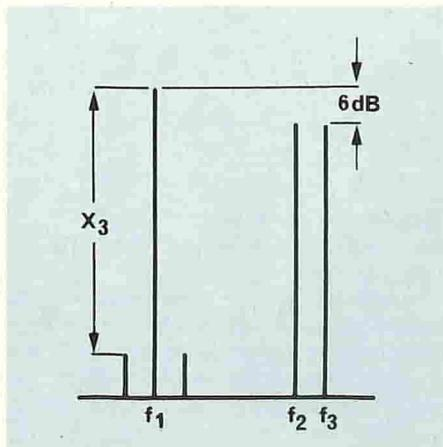
Fig. 3 - Distorsione per intermodulazione ( $\times 3$ ) misurata secondo le norme DIN 45004 con sistema delle frequenze.
