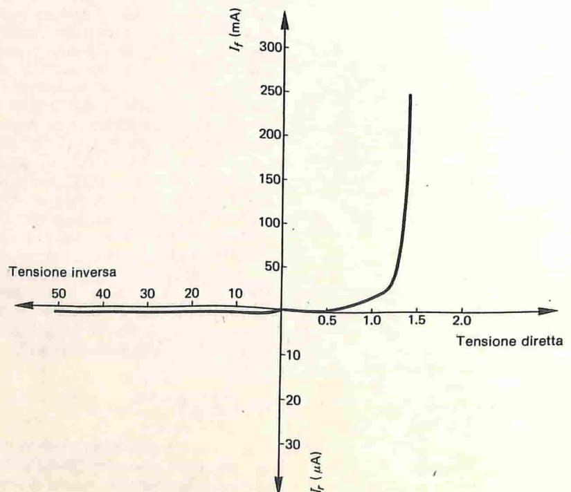
Fig. 2.10 - Caratteristica corrente/tensione per il diodo a giunzione considerato nell'esempio 2.3.
