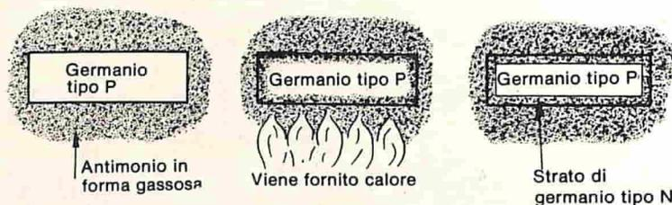
Fig. 2.3 - Formazione di una giunzione P-N mediante il processo detto di "diffusione".
