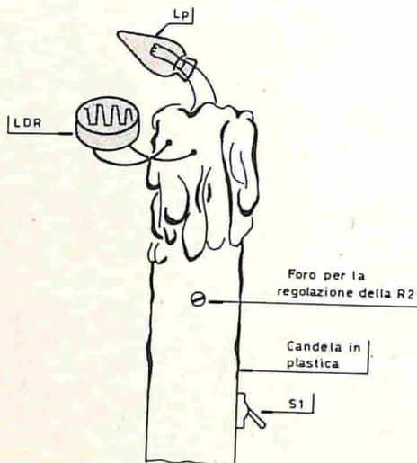
Fig. 2 - Aspetto della candela a montaggio ultimato.
