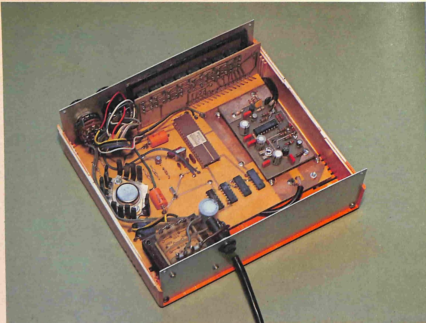
*Vista interna dello strumento. La sezione alimentatrice viene posta più lontano possibile dallo stadio d'ingresso per evitare induzioni dannose.*
