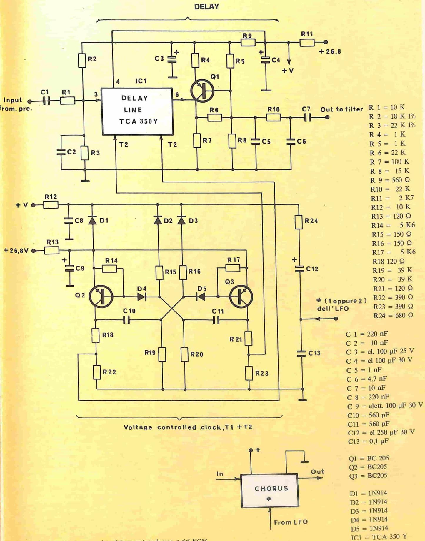
Fig. 2 - Circuito elettrico completo del generatore di coro e del VCM.
