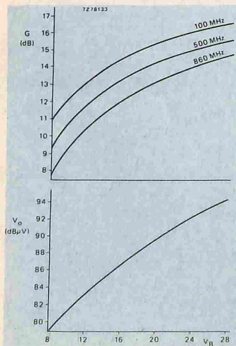
Fig. 5 - Andamento del guadagno G in dB e della tensione V<sub>o</sub> in dB  $\mu$ V in funzione dell'alimentazione al modulo OM320.
