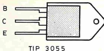
Fig. 4 - Disposizione dei piedini del TIP 3055.
