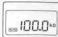
Resistenze LP (manuale-auto) 1 \Omega - 2 M \Omega
