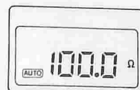
Resistenze (manuale-auto) 0.1 \Omega - 2 M \Omega
