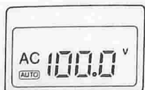
Tensioni c.a. (manuale-auto) 1 mV - 600 V
