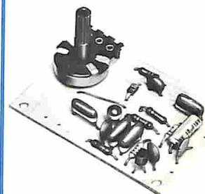
Un semplicissimo ricevitore radio super-rigenerativo dalle prestazioni brillanti. Miniaturizzato e di semplicissima costruzione, può servire per l'ascolto in cuffia delle emittenti in modulazione di frequenza, oppure collegato ad un amplificatore per l'ascolto in altoparlante. Sintonia a diodo varicap.
