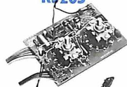
Indispensabile per trasformare un millivoltmetro digitale in un completo "multimetro" estendendo alla misura di varie grandezze elettriche, come le correnti e le tensioni sia continue che alternate e la resistenza.
