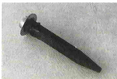
Fig. 2 - Punta scrivente (carboncino ricavato da una pila sagomato a lima).
