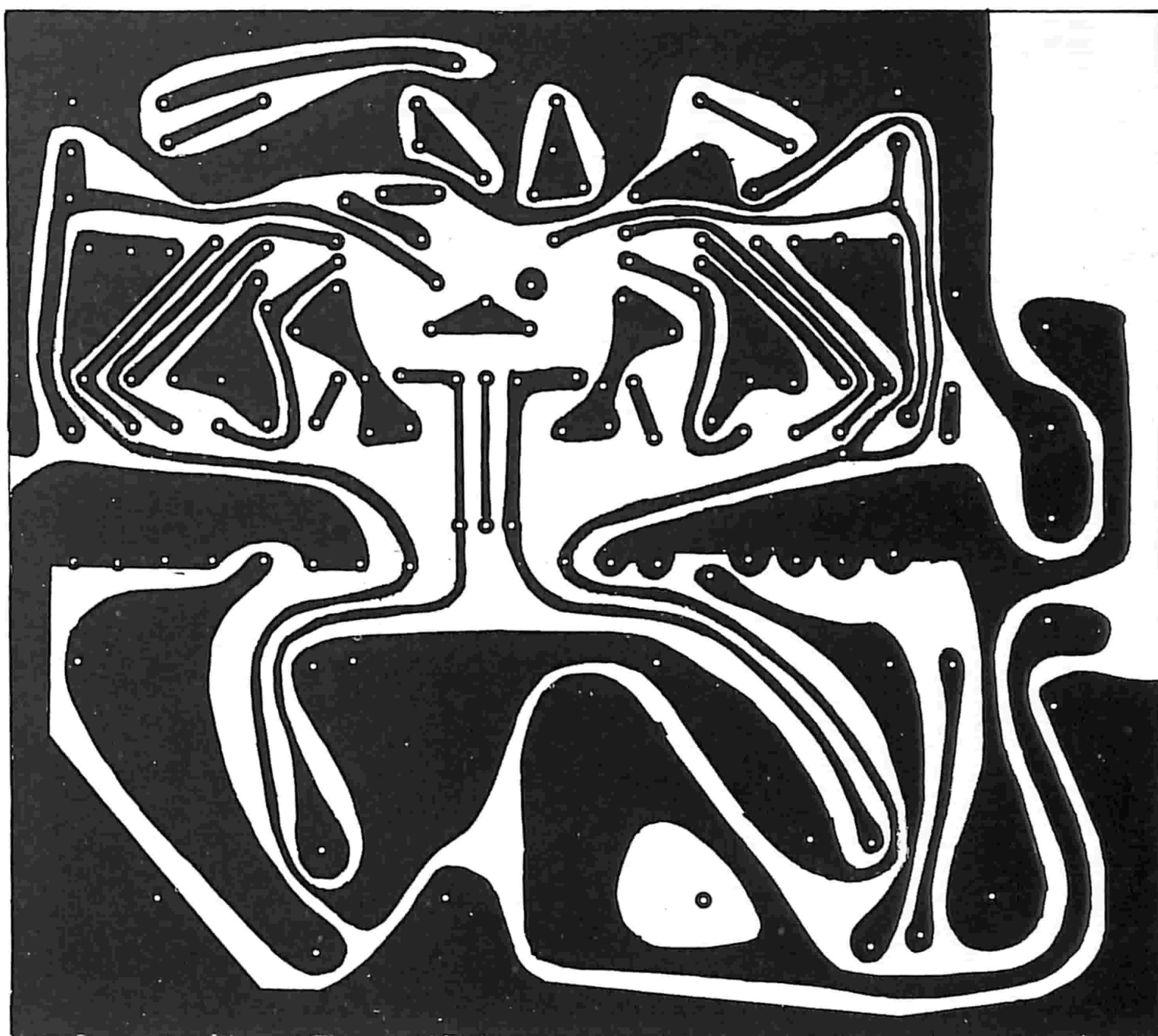
Fig. 5 - Tracce ramate della basetta stampata su cui è montato lo stadio finale descritto.
