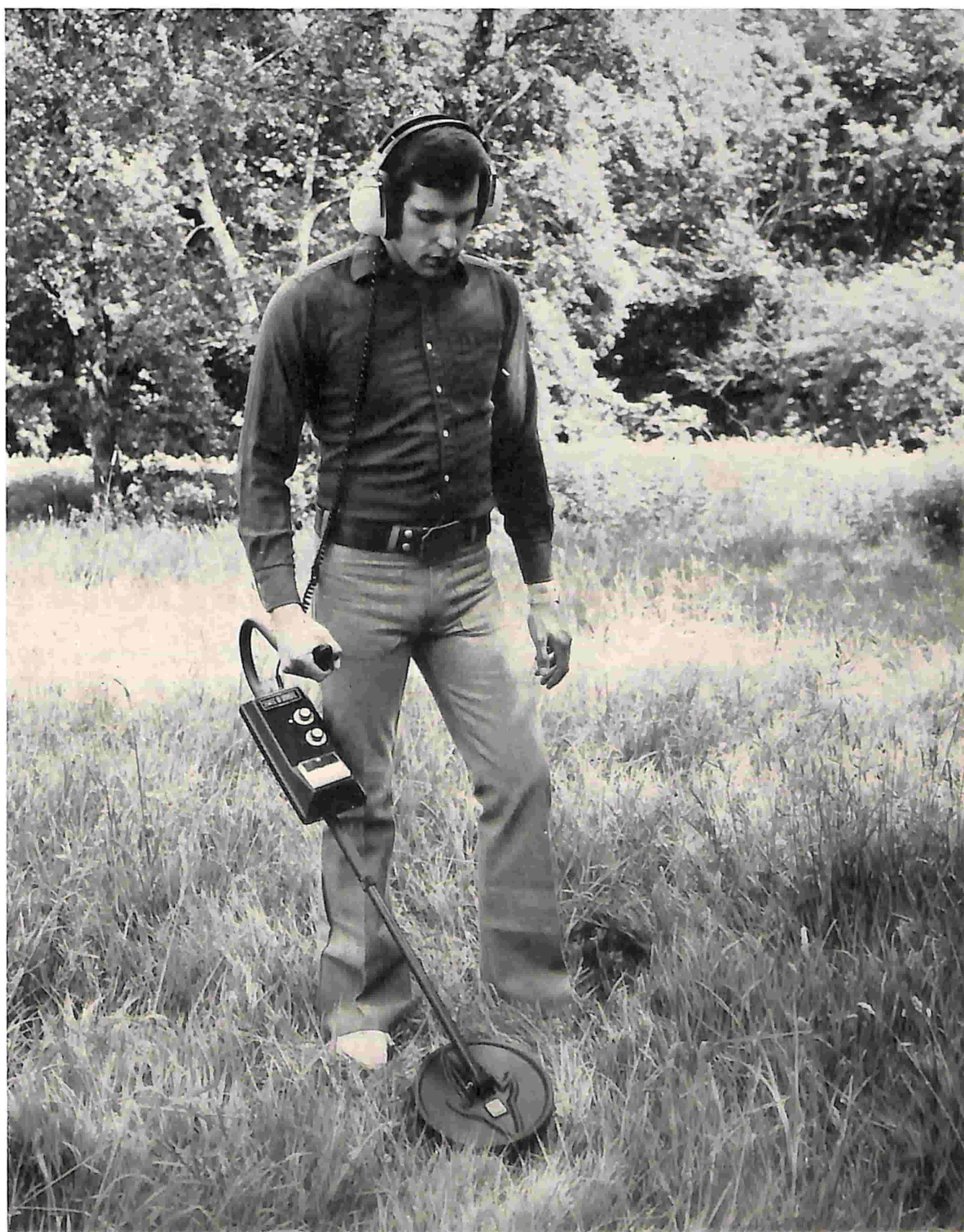
Fig. 1 - Impiego erroneo del cercametalli. La piastra rivelatrice non è parallela al terreno.
