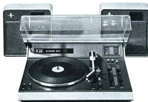
Complesso «Philips» Mod. GF 907. Com- ando idraulico del braccio. Selettore di velocità, controllo di testina magnetica GP 400 con puntina in diamante, 15µm. Ingresso: sintonizzatore 200 mV-470 kΩ, regolatore 200 mV-470 kΩ. Impedenza cuffia: 600 Ω. Impedenza altoparlanti: 4 Ω. Alimentazione: 110-127-220-240 V. 50 Hz. Dimensioni: 490x400x225. ZH/2126-00
