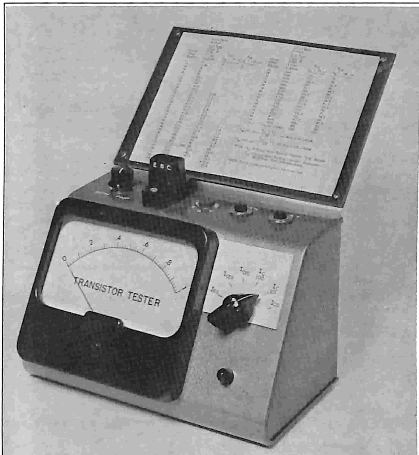
Fig. 2 - Prova-transistori della General Electric con tabella che reca i calcoli relativi ai parametri del guadagno hFE ed hfe.
