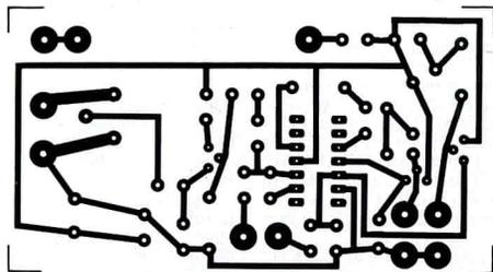
Fig. 9 - Disegno delle piste ramate della basetta su cui è montato il fotorelay.
