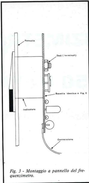
Fig. 3 - Montaggio a pannello del frequenzimetro.
