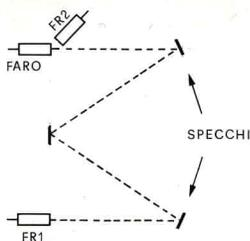
Fig. 8 - Una possibile applicazione del circuito differenziale, utile per evitare falsi allarmi in un antifurto a labirinto luminoso.
