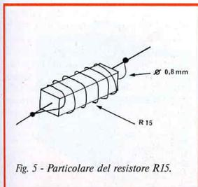
Fig. 5 - Particolare del resistore R15.
