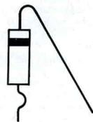
Fig. 4 - Prima di montare i diodi sul C.S. è necessario piegare i loro terminali come illustrato in figura.
