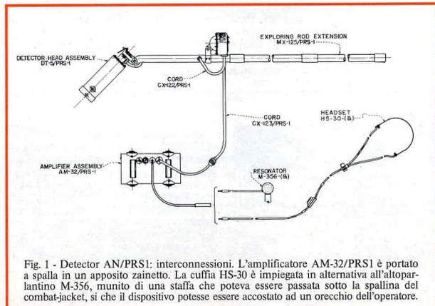
Fig. 1 - Detector AN/PRSI: interconnessioni. L'amplificatore AM-32/PRS1 è portato a spalla in un apposito zainetto. La cuffia HS-30 è impiegata in alternativa all'altoparlante M-356, munito di una staffa che poteva essere passata sotto la spallina del combat-jacket, sì che il dispositivo potesse essere accostato ad un orecchio dell'operatore.
