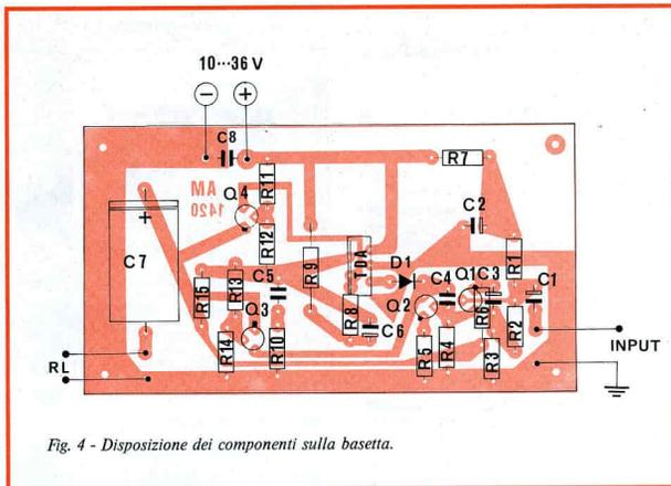
Fig. 4 - Disposizione dei componenti sulla basetta.
