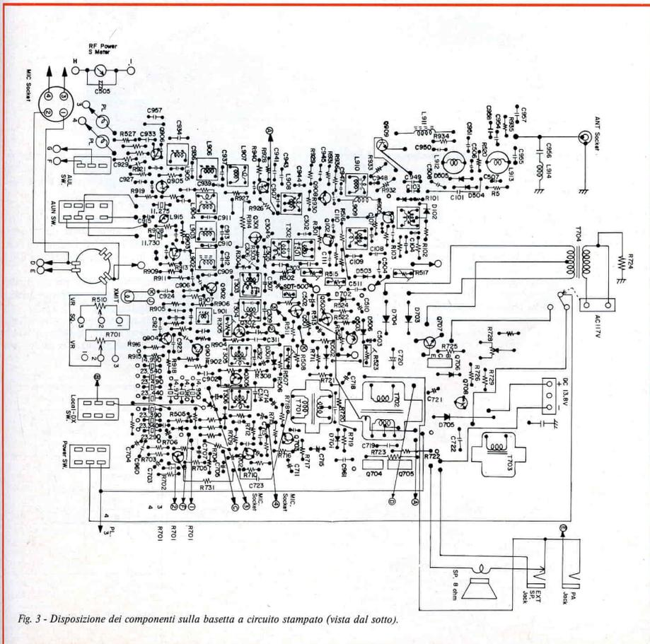
Fig. 3 - Disposizione dei componenti sulla basetta a circuito stampato (vista dal sotto).
