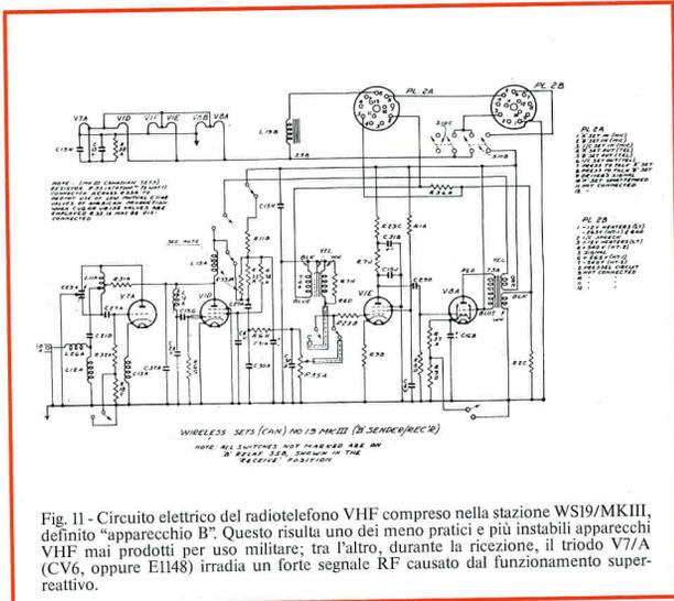
Fig. 11 - Circuito elettrico del radiotelefono VHF compreso nella stazione WS19/MKIII, definito "apparecchio B". Questo risulta uno dei meno pratici e più instabili apparecchi VHF mai prodotti per uso militare; tra l'altro, durante la ricezione, il triodo V7/A (CV6, oppure E1148) irradia un forte segnale RF causato dal funzionamento superreattivo.
