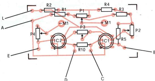
Fig. 9 - Disposizione dei componenti sulla basetta di fig. 8.
