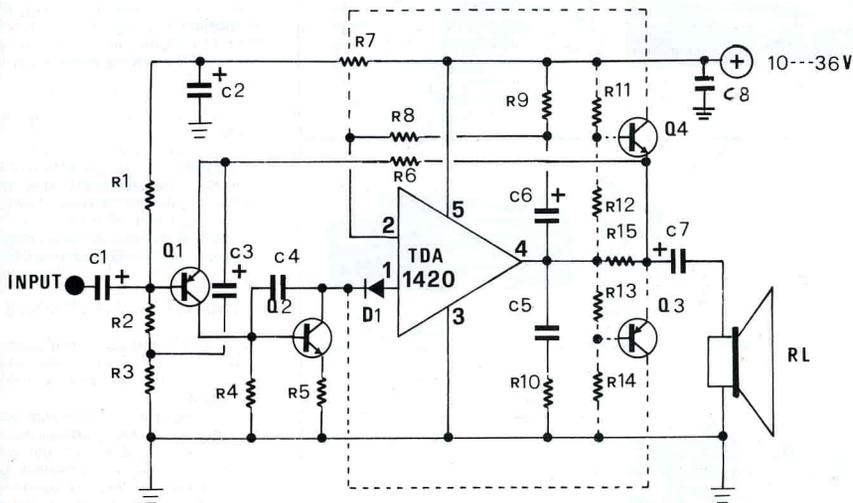
Fig. 2 - Schema elettrico dell'amplificatore da 30 W.
