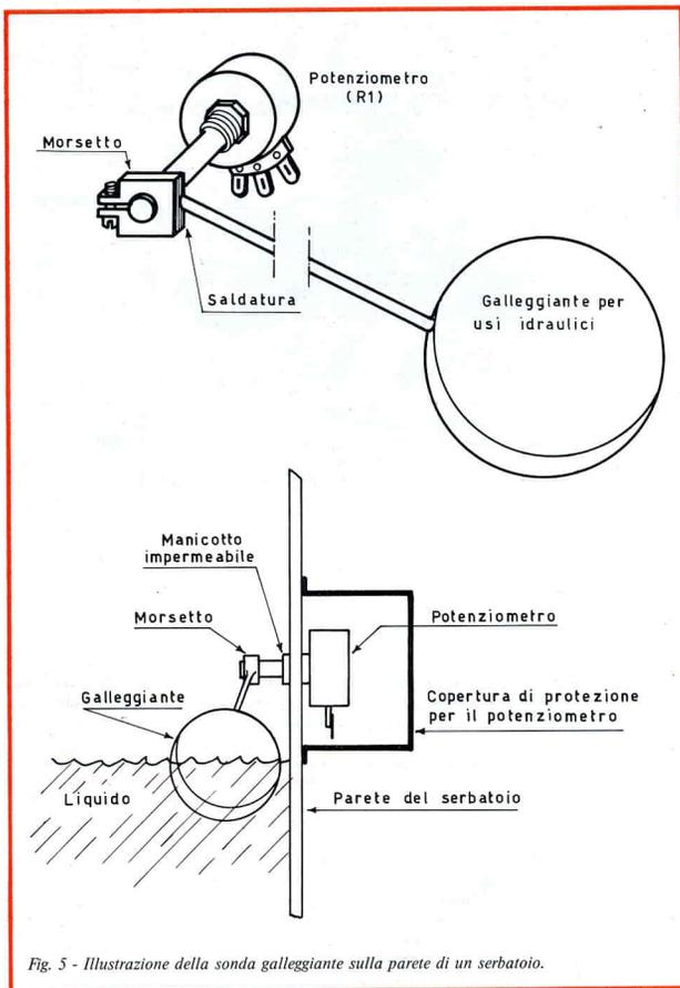
Fig. 5 - Illustrazione della sonda galleggiante sulla parete di un serbatoio.
