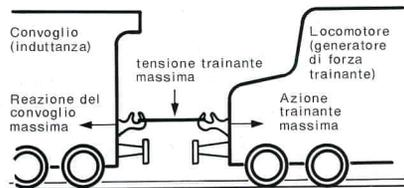
velocità zero nell'istante in cui il locomotore si mette in moto:
