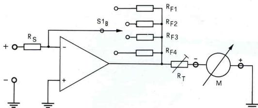
Fig. 2 - Il "cuore" del millivoltmetro. Il guadagno dell'operazionale può assumersi diversi valori a seconda della posizione di  $S_{1B}$ .
