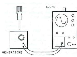
Fig. 6 - Taratura semplificata. Il trimmer è regolato per leggere una tensione di 5 V (con 9 V di alimentazione).
