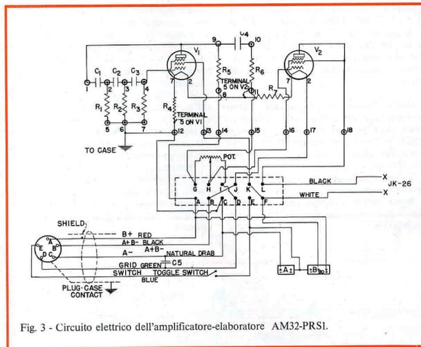
Fig. 3 - Circuito elettrico dell'amplificatore-elaboratore AM32-PRSI.
