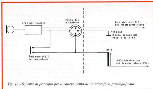
Fig. 10 - Schema di principio per il collegamento di un microfono preamplificato.
