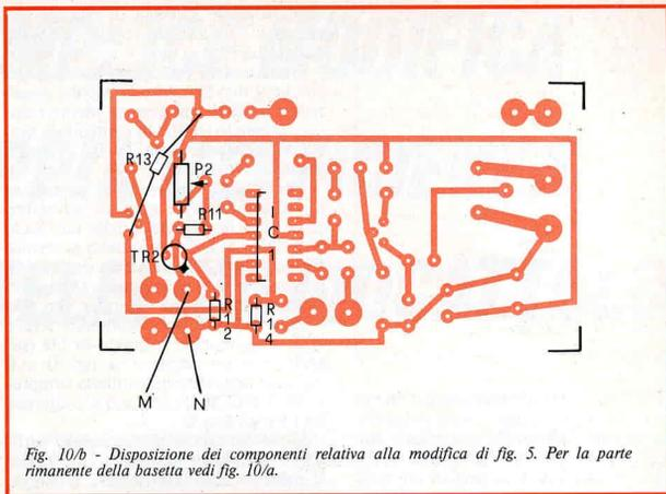
Fig. 10/b - Disposizione dei componenti relativa alla modifica di fig. 5. Per la parte rimanente della bassetta vedi fig. 10/a.
