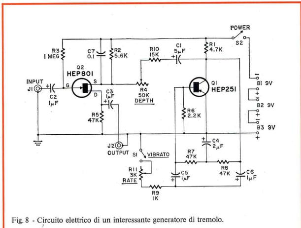
Fig. 8 - Circuito elettrico di un interessante generatore di tremolo.
