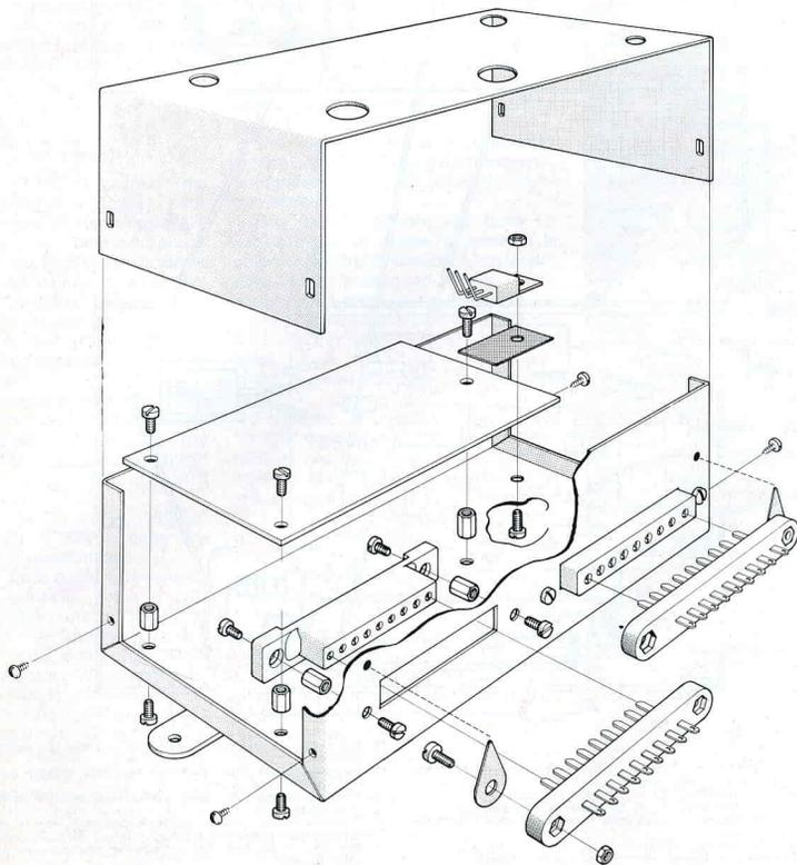
Fig. 4 - Montaggio degli accessori sul contenitore.
