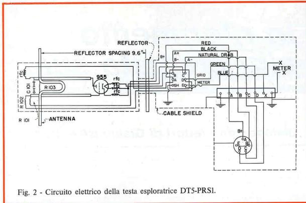
Fig. 2 - Circuito elettrico della testa esploratrice DT5-PRSI.
