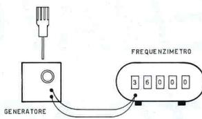
Fig. 4 - Taratura ottimale. Il trimmer R2 è regolato sino a leggere la frequenza identica a quella di risonanza della "CPE" usata.
