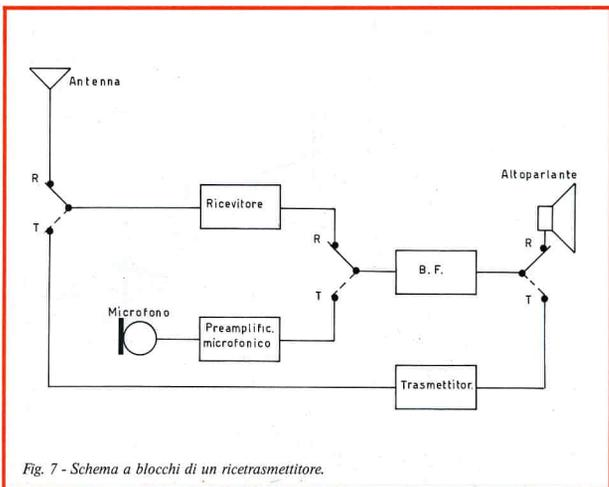
Fig. 7 - Schema a blocchi di un ricetrasmittitore.
