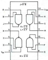
Fig. 2 - Connessioni dell'IC "4011".
