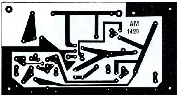
Fig. 3 - Circuito stampato visto dal lato rame in scala 1:1.
