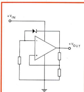
Fig. 6 - Sorgente di tensione costante realizzata con un amplificatore operazionale.
