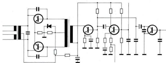
Fig. 8 - Schema elettrico di uno stadio di B.F.
