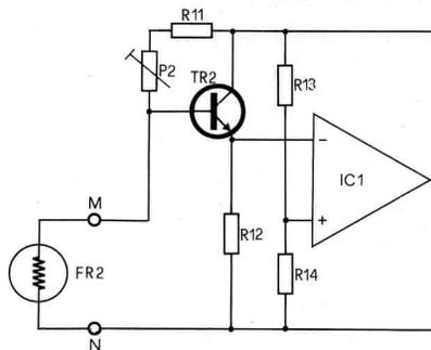
Fig. 5 - Modifica al circuito di fig. 4 affinché operi con logica positiva. La parte rimanente dello schema è identica alla fig. 4.
