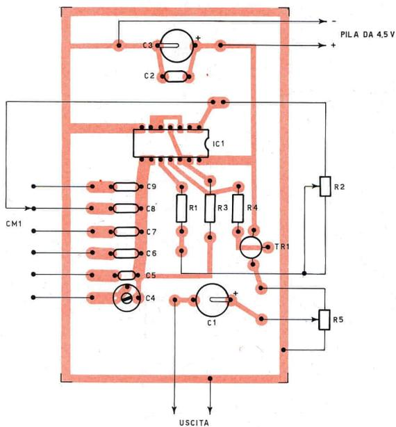
Fig. 5/a - Disposizione dei componenti sulla bassetta a circuito stampato.
