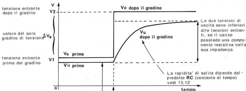
Questa tensione iniziale di uscita sarebbe uguale alla tensione iniziale di entrata se il carico non avesse componente resistiva
