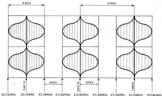
Fig. 9 - Bande audio con modulazione al 100%.
