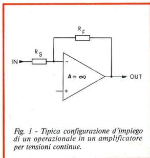
Fig. 1 - Tipica configurazione d'impiego di un operazionale in un amplificatore per tensioni continue.
