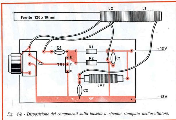
Fig. 4/b - Disposizione dei componenti sulla basetta a circuito stampato dell'oscillatore.
