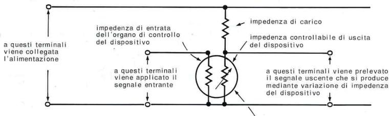
Il dispositivo ad impedenza controllata possiede la facoltà di modificare la propria impedenza statica in funzione delle grandezze (tensione o corrente) applicate all'organo di controllo.
