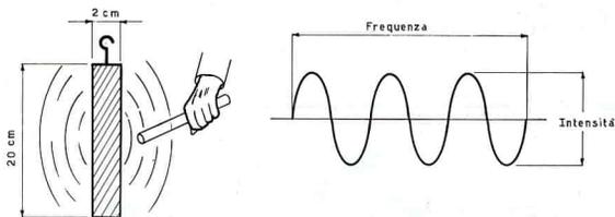
Fig. 1 - Si genera un suono di una certa frequenza con una determinata intensità.
