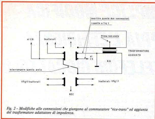
Fig. 2 - Modifiche alle connessioni che giungono al commutatore "rice-trans" ed aggiunta del trasformatore adattatore di impedenza.
