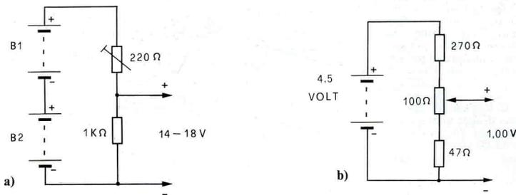
Fig. 12 - Circuiti ausiliari necessari per la taratura del millivoltmetro.
