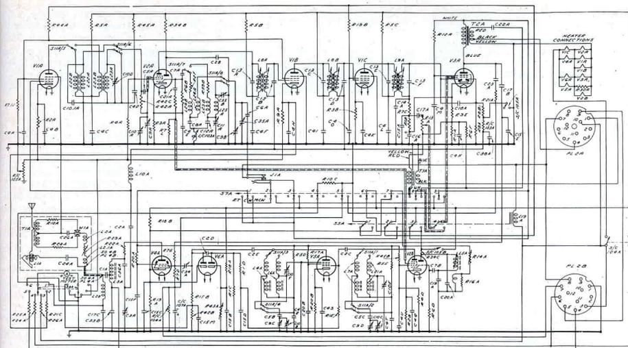
Fig. 10 - Circuito elettrico del sistema ricevente e trasmettente, detto "apparecchio A" facente parte della stazione WS19/MKIII.
