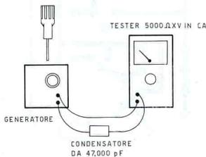
Fig. 5 - Taratura buona. Il trimmer R2 è regolato sino a scorgere una forma d'onda quasi sinusoidale.
