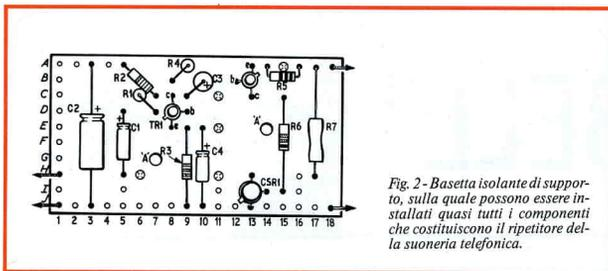
Fig. 2 - Basetta isolante di supporto, sulla quale possono essere installati quasi tutti i componenti che costituiscono il ripetitore della suoneria telefonica.
