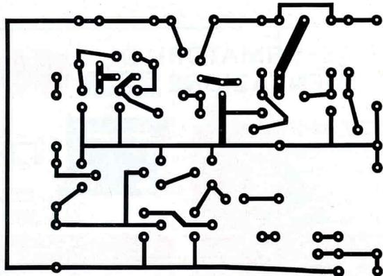
Fig. 5 - Basetta a circuito stampato in scala 1:1.
