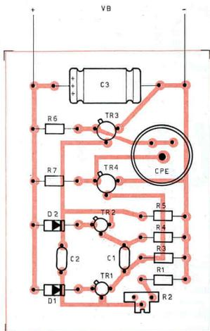
Fig. 2/a - Disposizione dei componenti sulla bauletta a circuito stampato.
