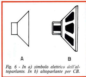
Fig. 6 - In a) simbolo elettrico dell'altoparlante. In b) altoparlante per CB.
