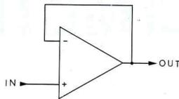
Fig. 4 - Configurazione tipica di uno stadio separatore a guadagno unitario (ripetitore di tensione).
