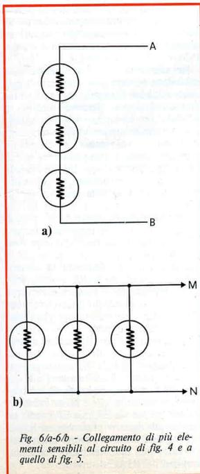
Fig. 6/a-6/b - Collegamento di più elementi sensibili al circuito di fig. 4 e a quello di fig. 5.
