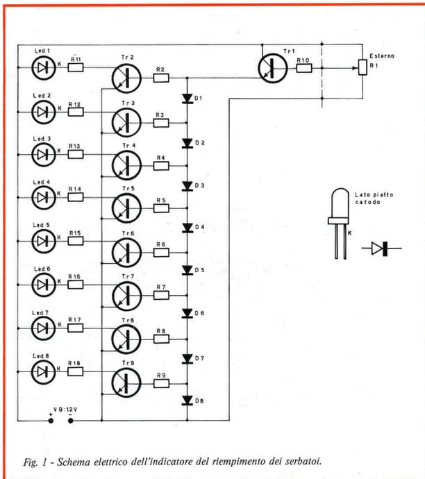
Fig. 1 - Schema elettrico dell'indicatore del riempimento dei serbatoi.
