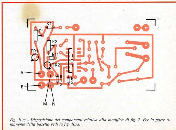
Fig. 10/c - Disposizione dei componenti relativa alla modifica di fig. 7. Per la parte rimanente della bassetta vedi la fig. 10/a.
