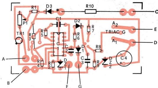
Fig. 10/a - Disposizione dei componenti relativa alla fig. 4.
