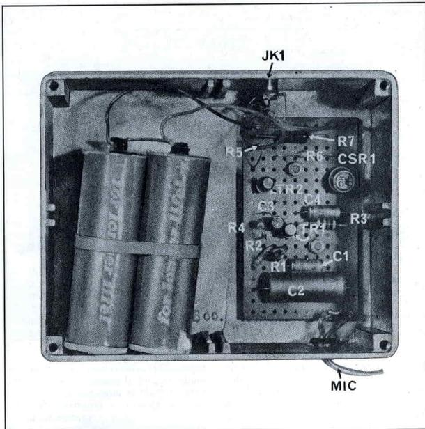
Fig. 4 - Prototipo dell'apparecchio montato, visto dal disotto. Si osserva il gommino attraverso il quale passa il cavo schermato per il collegamento del microfono. La presa JK1 è invece in alto.
