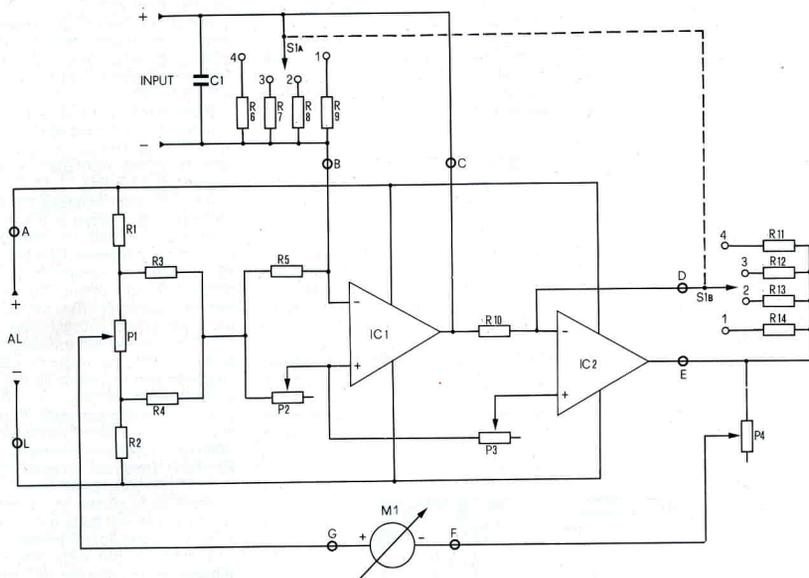
Fig. 5 - Schema elettrico completo del millivoltmetro c.c.
