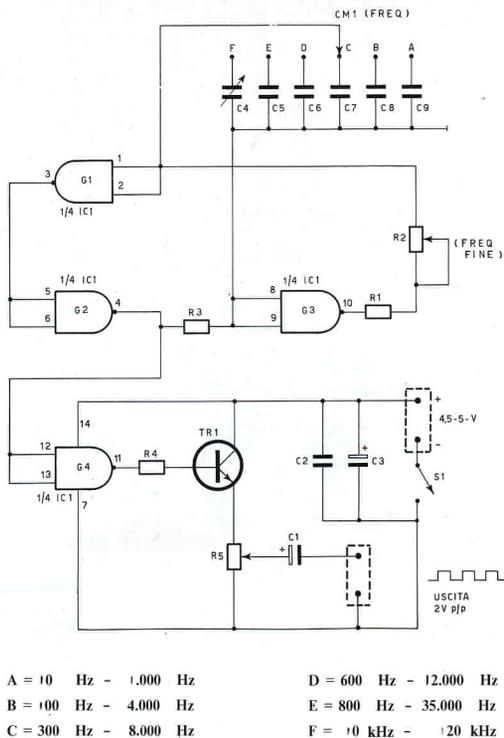
Fig. 4 - Schema elettrico del generatore di onde quadre Cos - Mos.
