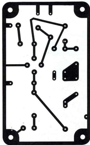
Fig. 2 - Bassetta a circuito stampato in scala 1:1.
