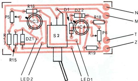
Fig. 11 - Disposizione dei componenti sulla basetta di fig. 10.
