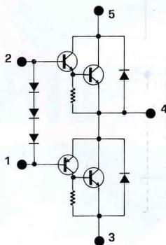
Fig. 1 - Disposizione dei terminali dell'integrato TDA1420 e sue connessioni interne.
