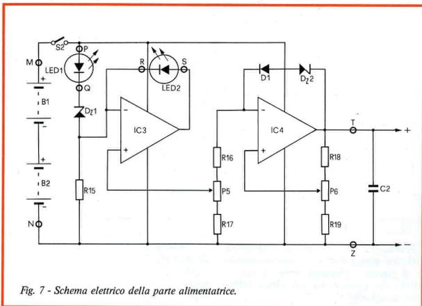
Fig. 7 - Schema elettrico della parte alimentatrice.
