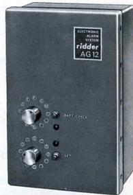
144 combinazioni, due spie luminose per lo stato di carica delle batterie e la messa in funzione dell'apparecchio. Funzionante con contatti normalmente chiusi o aperti. Microsirena incorporata, con potenza di 6W. Può comandare una sirena esterna di alta potenza. Alimentazione a 220V c.a. oppure 9V c.c. con 6 torce da 1.5V.
