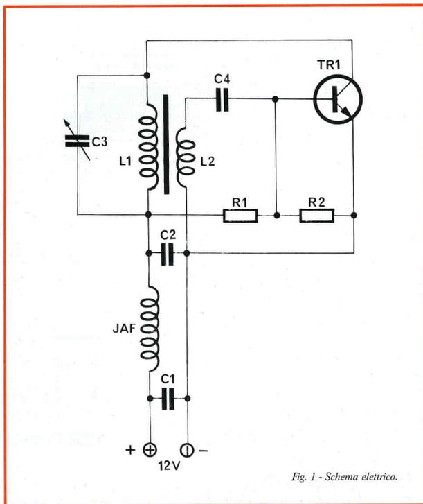
Fig. 1 - Schema elettrico.
