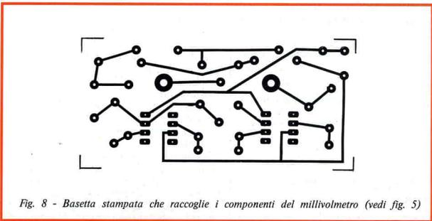
Fig. 8 - Basetta stampata che raccoglie i componenti del millivoltmetro (vedi fig. 5)
