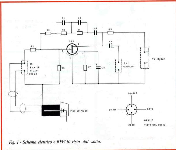
Fig. 1 - Schema elettrico e BFW10 visto dal sotto.
