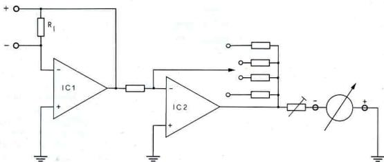
Fig. 3 - Uno stadio separatore a guadagno unitario (IC1) impedisce che il circuito sotto misura influenzi il funzionamento del millivoltmetro e garantisce una elevata resistenza d'ingresso.
