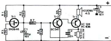
Fig. 5 - Schema elettrico di una sirena elettronica per interni. La tensione di alimentazione è 12 V. Al posto dell'altoparlante AD 2090, può essere impiegata con vantaggio una trombetta dall'impedenza eguale.
