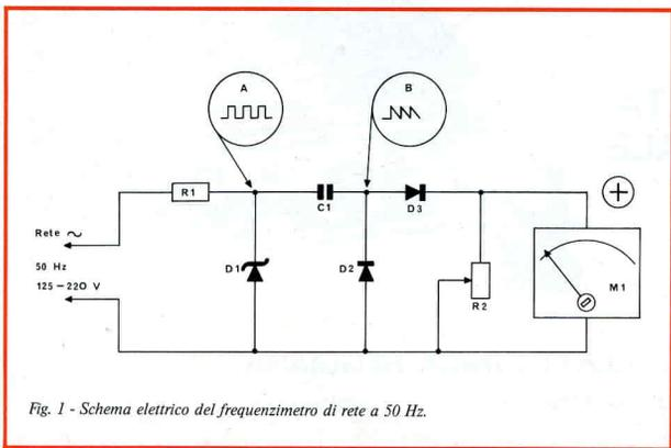
Fig. 1 - Schema elettrico del frequenzimetro di rete a 50 Hz.
