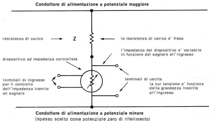
Abbiamo così costruito un trasduttore a quadripolo che può essere schematizzato in questo modo per quanto concerne i suoi rapporti con altri circuiti a cui può essere collegato.
