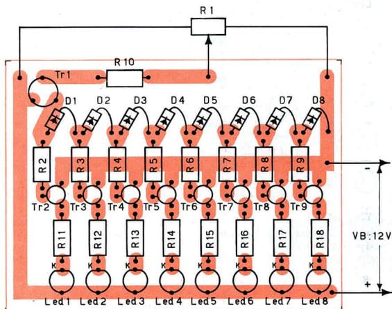
Fig. 3 - Disposizione dei componenti sulla basetta.
