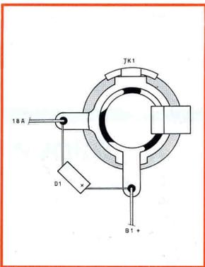
Fig. 3 - Esecuzione delle connessioni al raccordo femmina dello spinotto telefonico, per il collegamento della suoneria supplementare. Si osservi la polarità del diodo D1.
