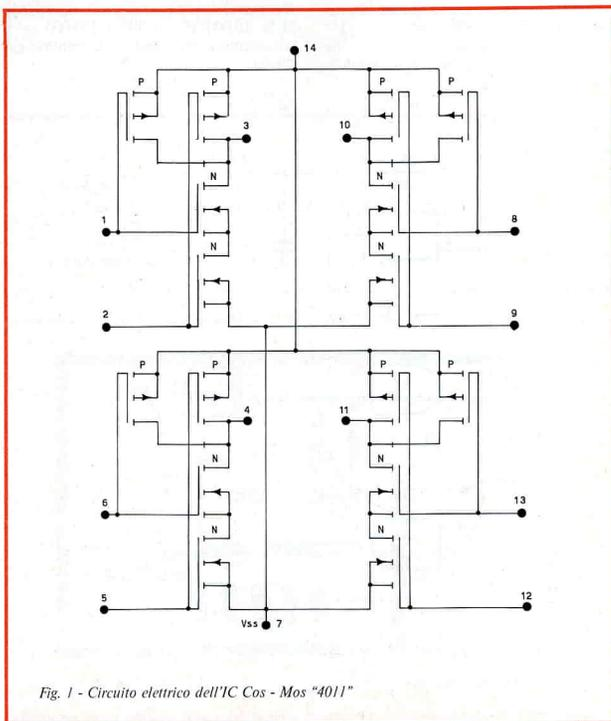
Fig. 1 - Circuito elettrico dell'IC Cos - Mos "4011"
