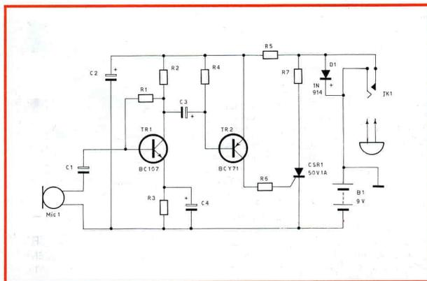
Fig. 1 - Schema elettrico completo del ripetitore della suoneria telefonica, che può essere installato senza manomettere l'impianto, e quindi senza infrangere la legge.
