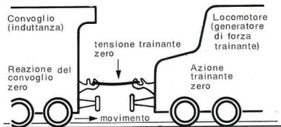
Essendo zero la tensione di reazione, questo convoglio può continuare il suo moto anche staccando il locomotore.
