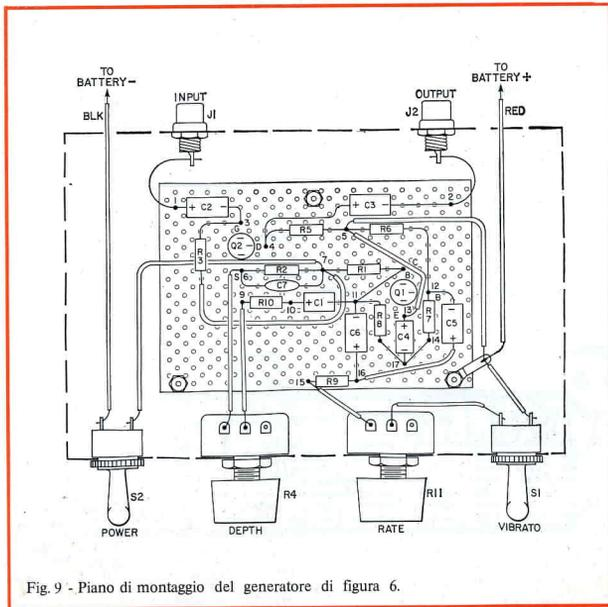
Fig. 9 - Piano di montaggio del generatore di figura 6.
