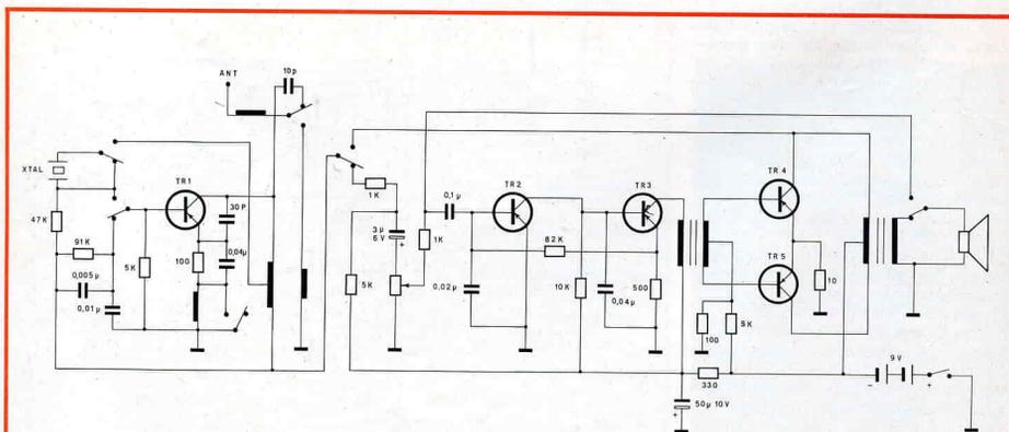
Fig. 3 - Circuito elettrico del noto e diffusissimo radiotelefono "Tower". Anche se questo apparecchio, per il numero dei transistori, si discosta assai dallo schema riportato come tipico, è possibile modificarlo come è detto nel testo. Ciò dimostra che praticamente qualunque handie-talkie può essere rielaborato secondo le indicazioni.
