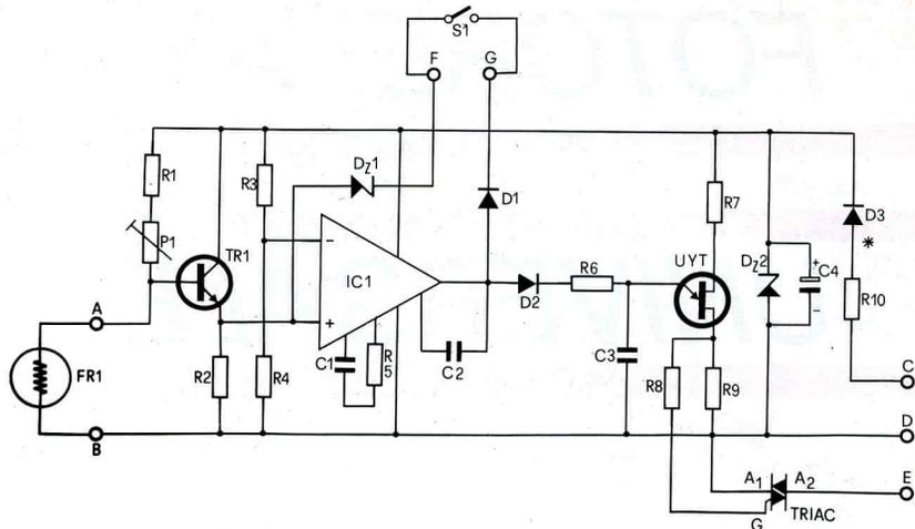
Fig. 4 - Schema completo del fotorelay. Questo circuito opera con logica negativa.
