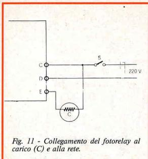
Fig. 11 - Collegamento del fotorelay al carico (C) e alla rete.
