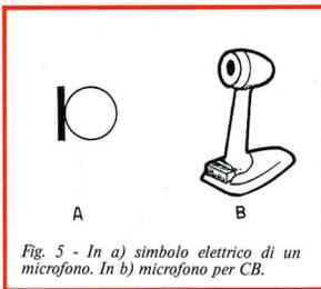
Fig. 5 - In a) simbolo elettrico di un microfono. In b) microfono per CB.
