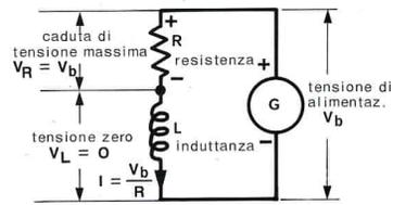
Essendo zero la tensione all'induttore, esso può essere messo in corto circuito e la corrente continuerà a circolare anche staccando il generatore.
