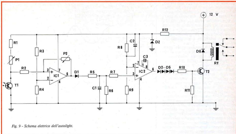
Fig. 9 - Schema elettrico dell'autolight.
