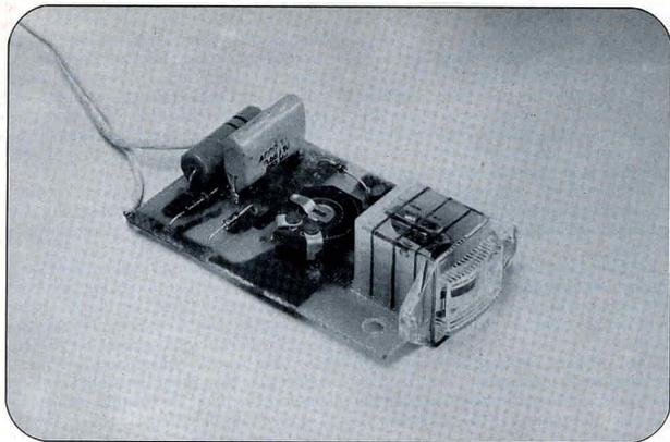
*L'indicatore qui trattato mostra l'esattezza della frequenza della rete luce e le eventuali variazioni. Costa assai poco, meno di qualunque strumento a lamelle vibranti ed è completamente passivo; non impiega alcuna sorgente di alimentazione propria. Chiunque lo può costruire in un paio d'ore di lavoro.*
