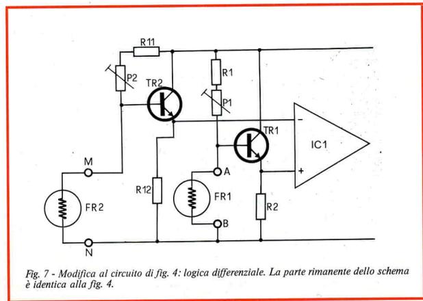
Fig. 7 - Modifica al circuito di fig. 4: logica differenziale. La parte rimanente dello schema è identica alla fig. 4.
