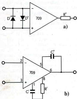
Fig. 2 - Configurazioni tipiche d'impiego del 709.
