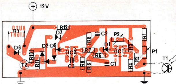
Fig. 11 - Disposizione dei componenti sulla basetta a circuito stampato.
