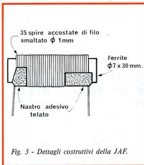
Fig. 3 - Dettagli costruttivi della JAF.
