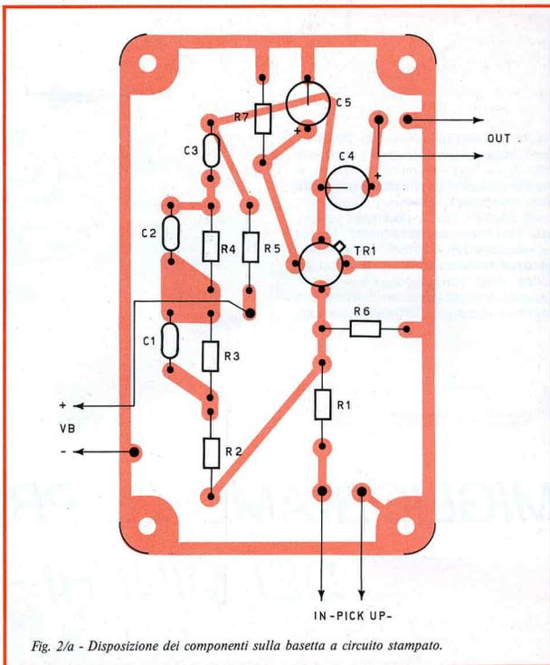
Fig. 2/a - Disposizione dei componenti sulla bassetta a circuito stampato.
