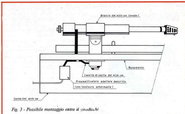
Fig. 3 - Possibile montaggio entro il giradischi
