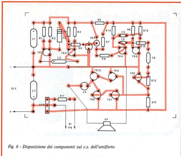
Fig. 6 - Disposizione dei componenti sul c.s. dell'antifurto.
