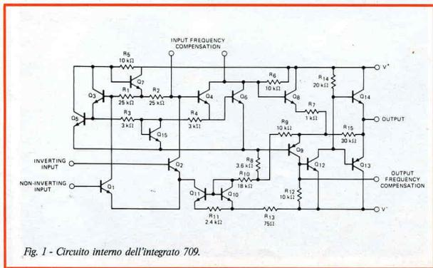
Fig. 1 - Circuito interno dell'integrato 709.
