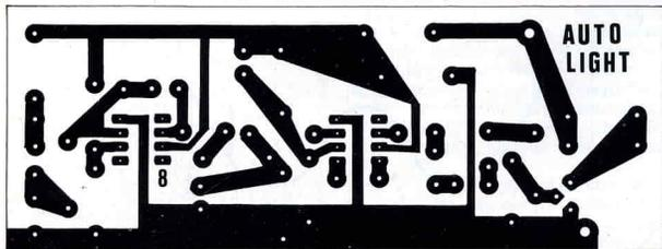
Fig. 10 - Bassetta a circuito stampato dell'autolight in scala 1:1.
