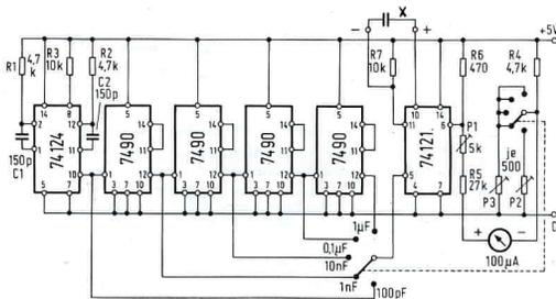
Fig. 6 - Circuito elettrico di un capacimetro di classe professionale (dalla Rivista Funkshau).
