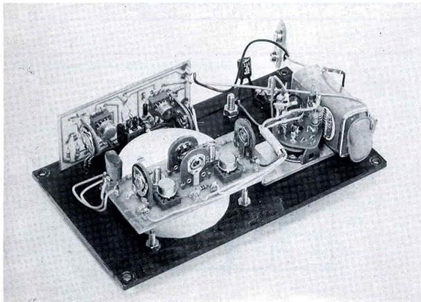
Vista interna del millivoltmetro c.c. a realizzazione ultimata.
