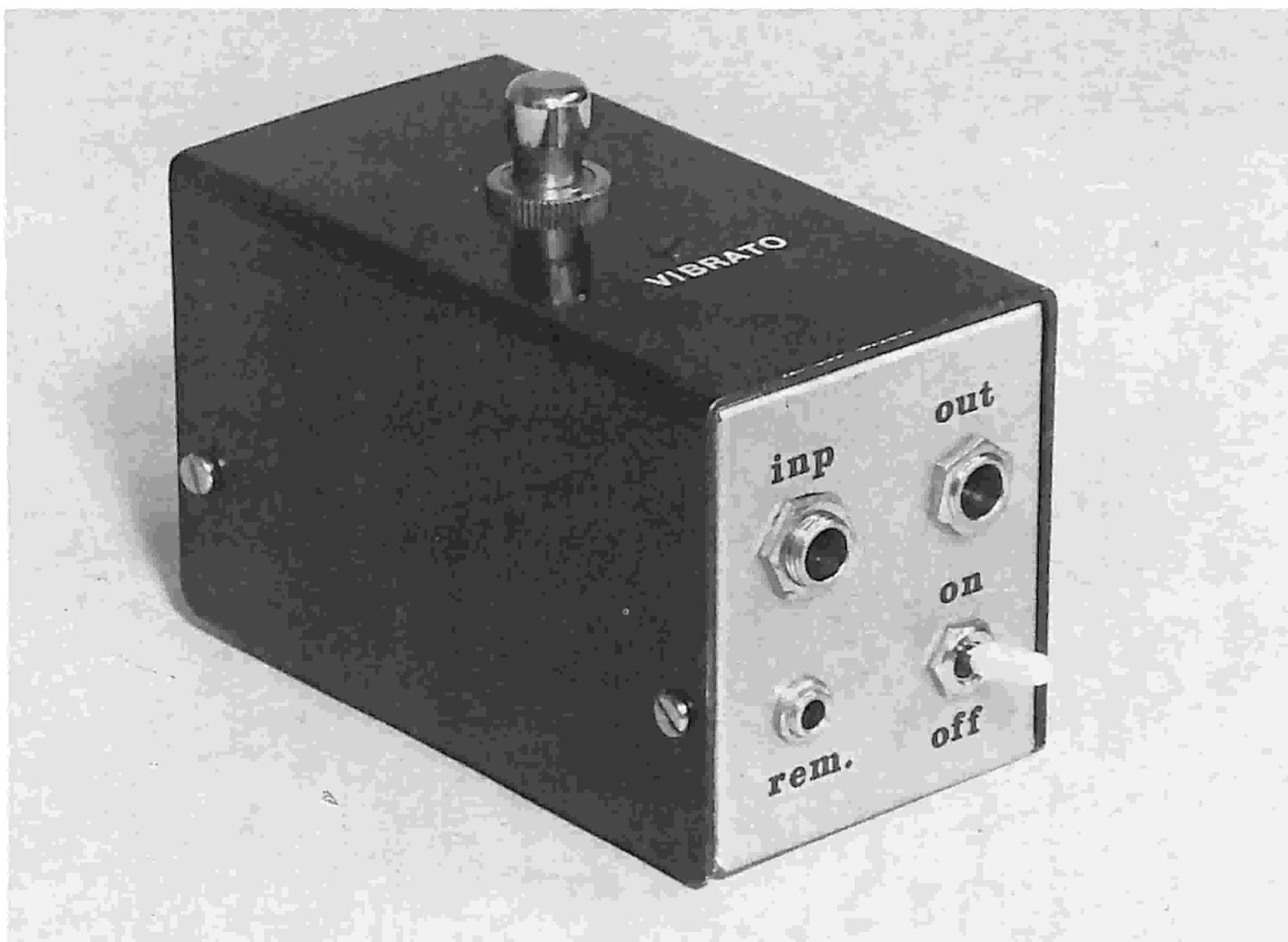
Prototipo del preamplificatore per chitarra elettrica a realizzazione ultimata.
