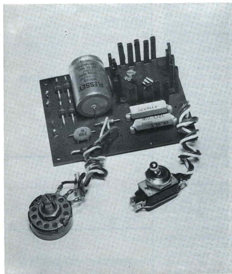
Caricabatterie a corrente costante a realizzazione ultimata.
