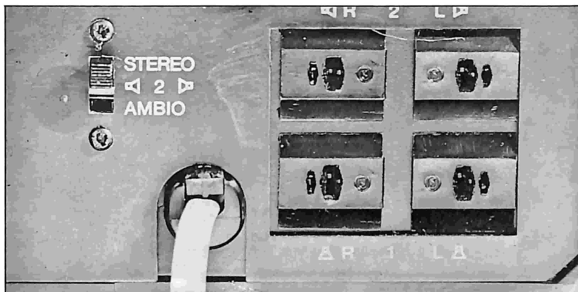
Un interruttore posto sulla parte posteriore dell'amplificatore permette la commutazione fra l'ascolto stereo e l'ascolto ambiofonico.
