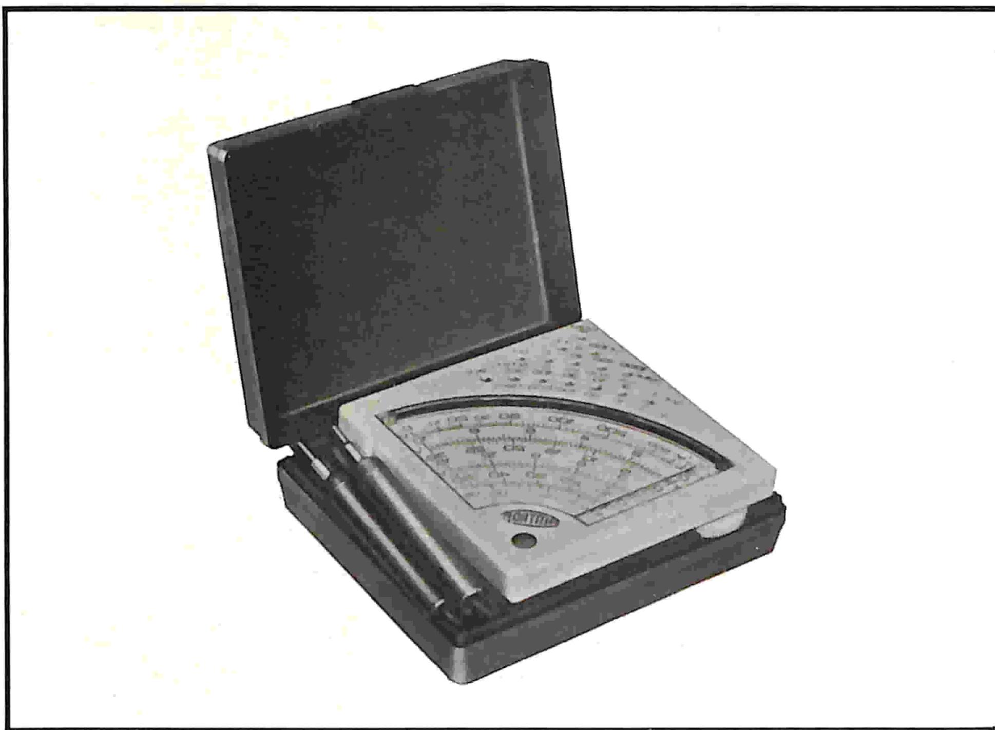
Fig. 4 - Modello di Tester universale con portate c.c. venduto in kit dall'Amtroncraft con la sigla UK434.
