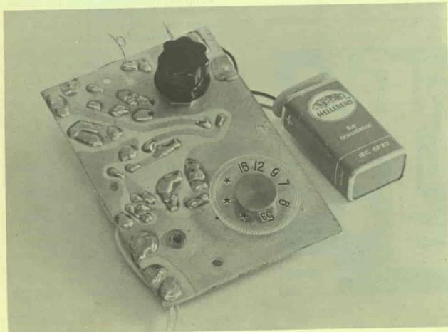
Altra vista del prototipo del radioricevitore a realizzazione ultimata, visto dalla parte ramata.
