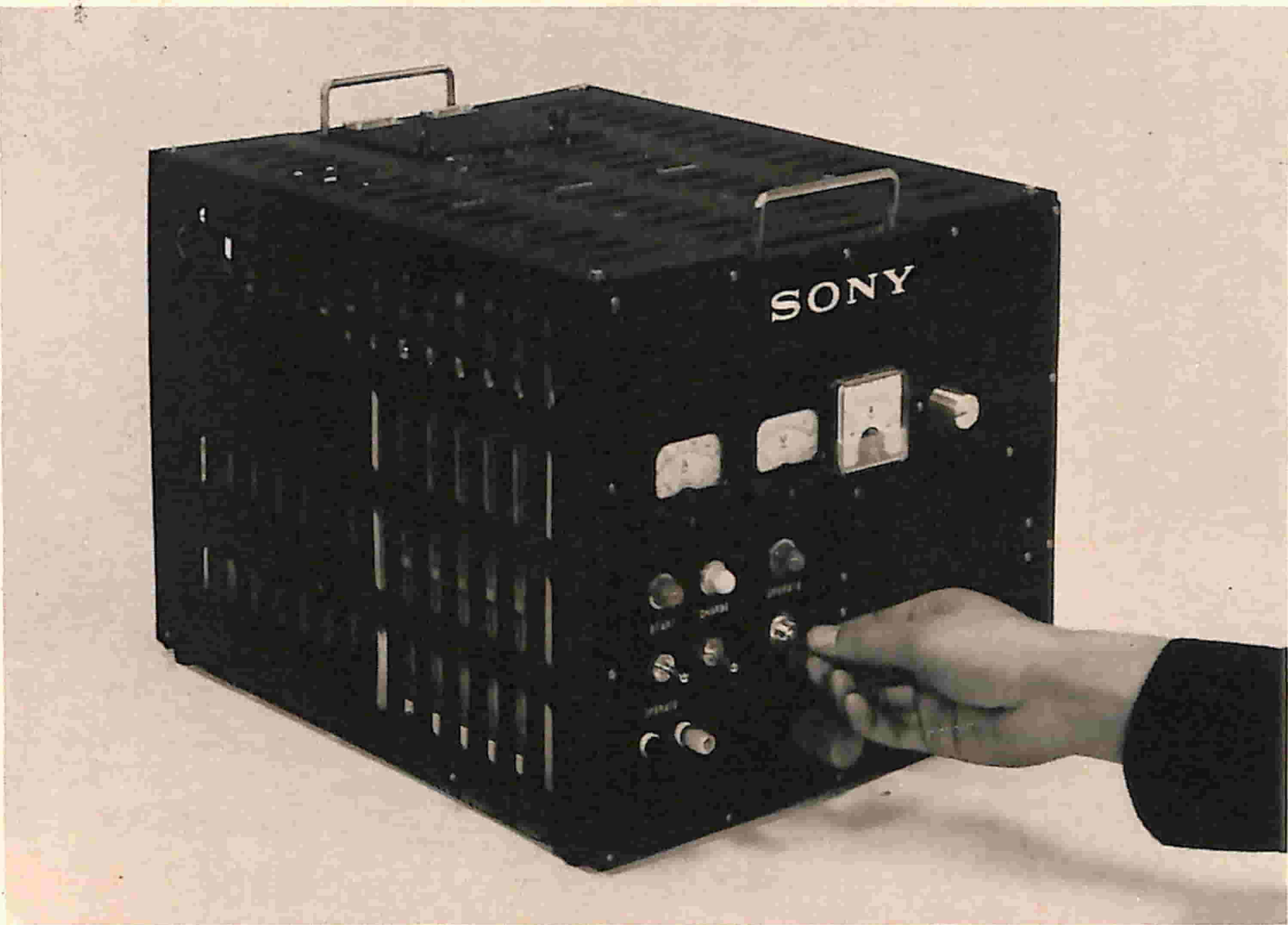
Fig. 5 - La foto illustra il prototipo del sistema di batteria portatile Sony da 400 W.
