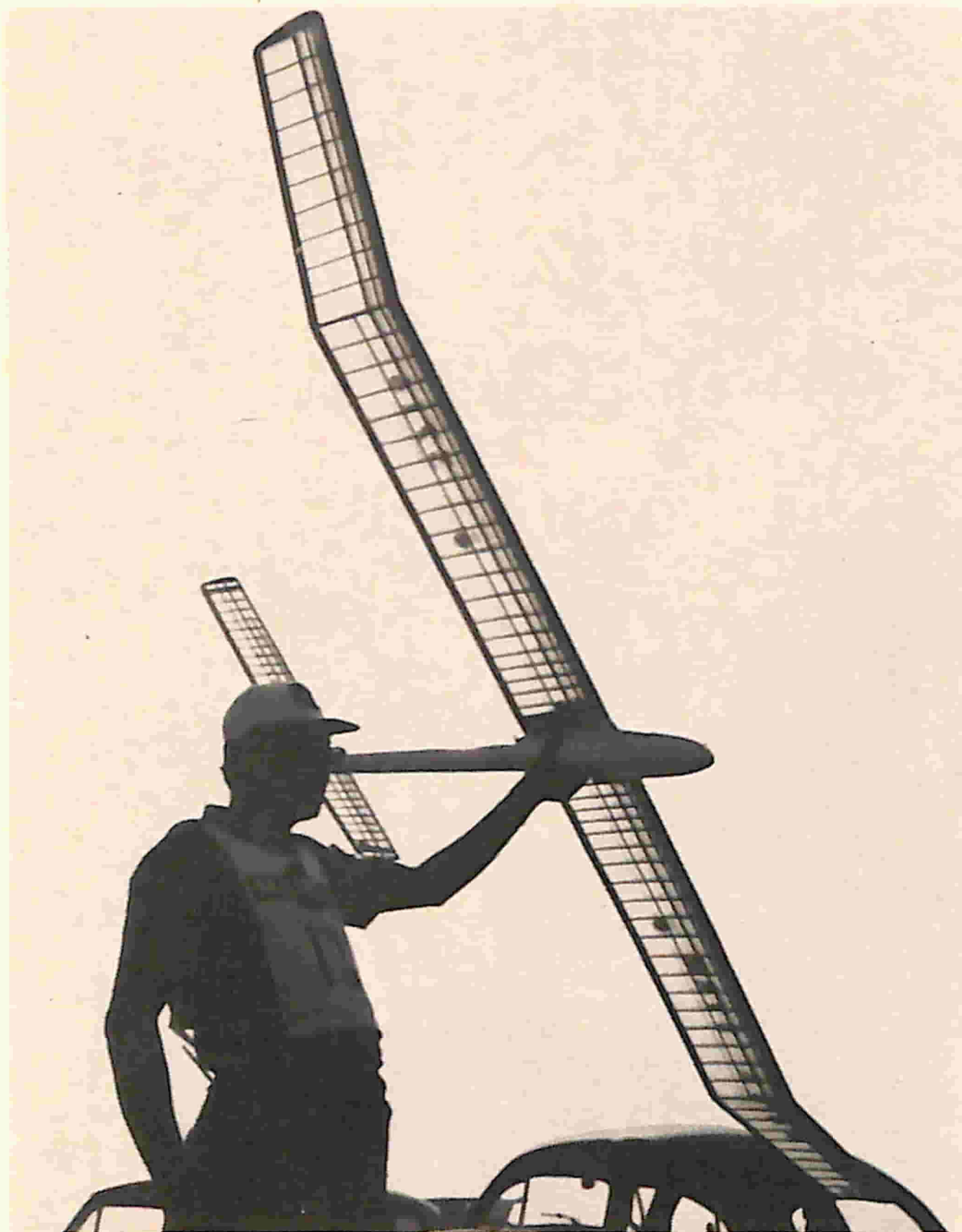
Aliante radiocomandato, notare la struttura delle ali.
