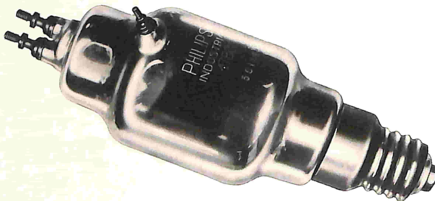
Fig. 1 - Diodo rettificatore industriale Philips - accensione: 1,9 V - corrente: 11 A - VA: 300 V - I_A : 30 A - si tratta di una ampolla a vapori di mercurio di grande potenza.
