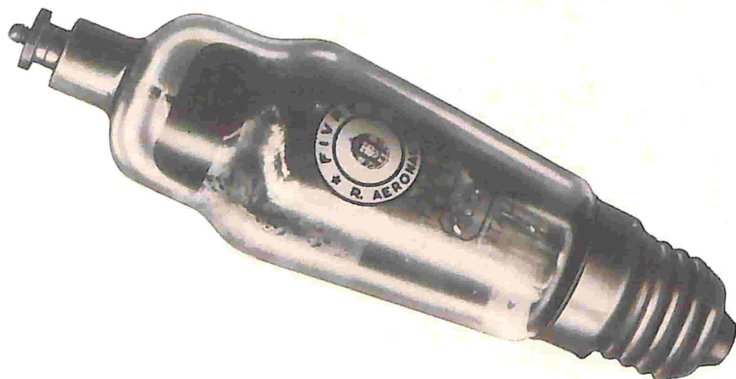
Fig. 6 - Diodo rettificatore a vapori di Mercurio tipo 866-E. Costruito dalla FIVRE per l'Aeronautica Italiana nel 1939/40.
