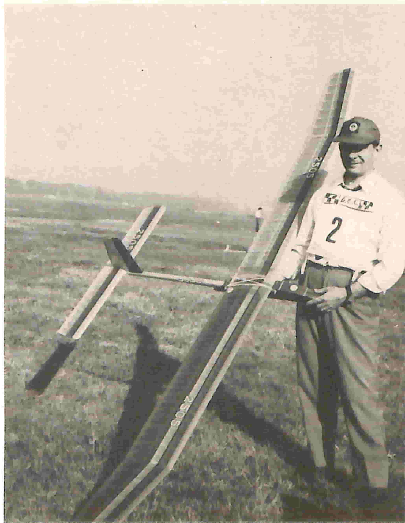
Fig. 2 - Aliante radiocomandato. La durata del volo di questo tipo di modello, dipende dal pilota a terra e dalle capacità del modello stesso nello sfruttare le correnti aeree.
