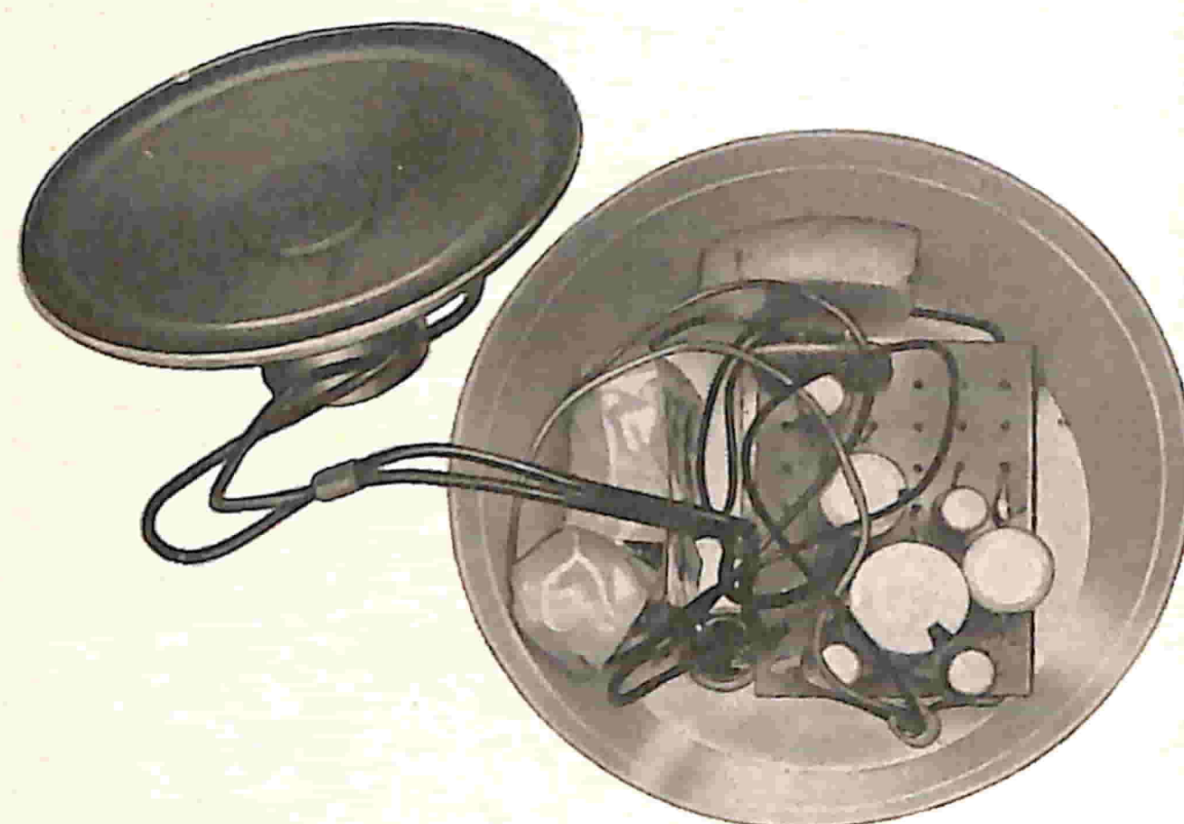
Fig. 5 - Aspetto del megafono montato; la foto mette in evidenza i componenti.
