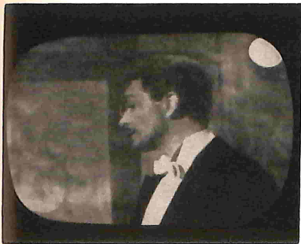
Fig. 1 - Immagine poco definita con sottotono, dovuto a deficienza dell'impianto antenna-linea di alimentazione.
