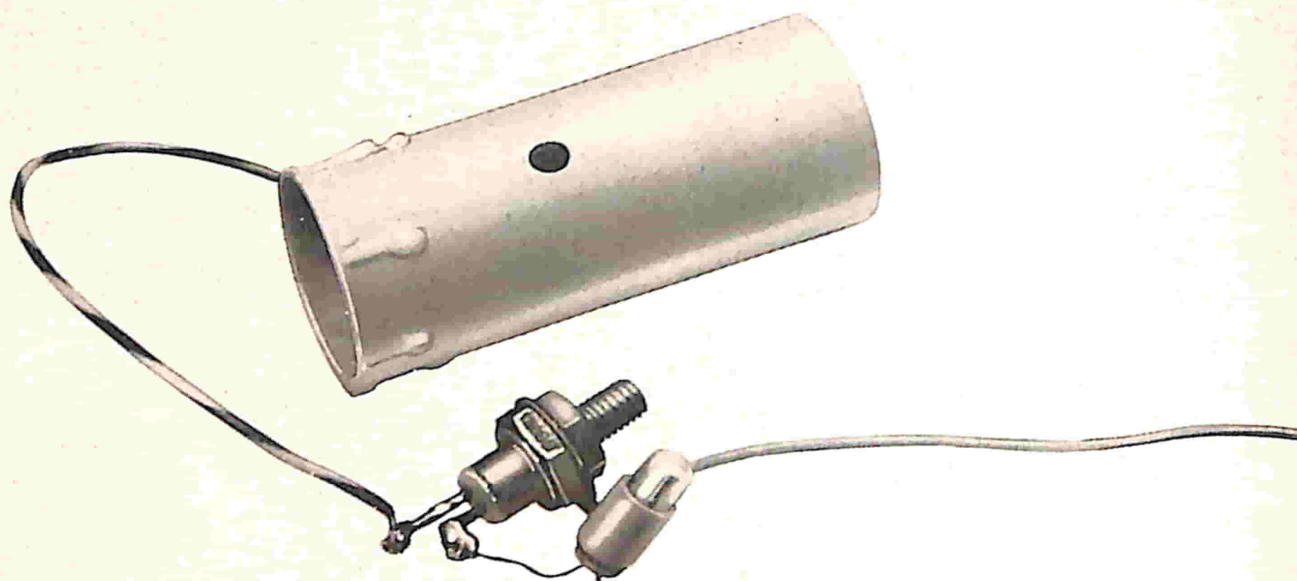
Fig. 5 - SCR e fotoresistenza: i due formano il cuore del nostro apparecchio. In secondo piano si vede il fusto della finta candela.
