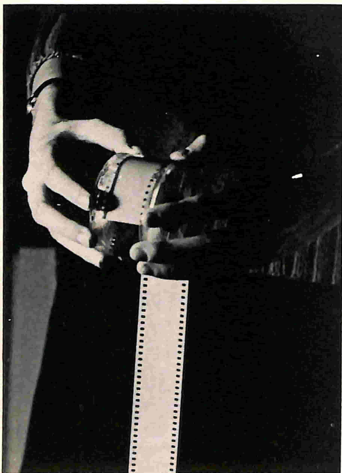
Foto 2 - Come avvolgere il film. Introdurre nella spirale una estremità del film, si procede fino al suo completo avvolgimento, tenendo ferma la parte sinistra, di chi opera, della spirale, si ruota la parte destra alternativamente avanti ed indietro, finché la pellicola sarà completamente avvolta. Da notare che questa operazione deve essere fatta al buio.
