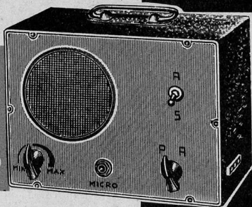
Fig. 1 - Ecco come si presenta, a montaggio ultimato, l'apparato interfono che viene manovrato da chi sta in emersione. Sul pannello frontale sono sistemati il comando di volume, il commutatore per le posizioni parlo-ascolto (P-A), l'interruttore e la presa per il microfono. Sul fianco destro dell'apparecchio vi è la presa per il collegamento con il pescatore subacqueo.
