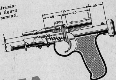
Fig. 3 - Particolare del meccanismo di caricamento e sparo del fucile subacqueo.
