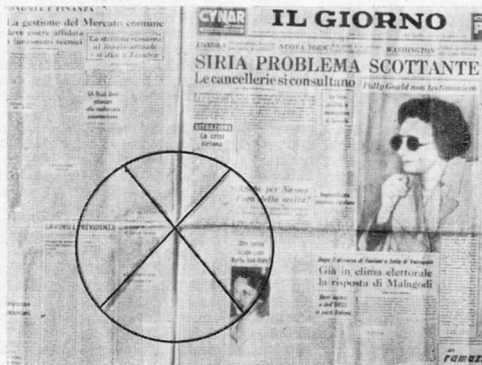
Fig. 3 - Controllando la negativa impressionata dalla macchina fotografica, si dovrà riscontrare la nitidezza dei caratteri da stampa tanto ai bordi quanto al centro.
