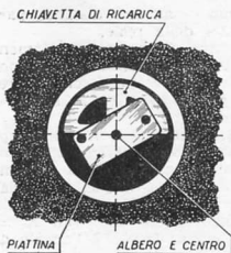
Fig. 6 - Nel caso di cineprese si metterà in opera una piattina con due perni, i quali abbiano possibilità di agganciarli alla chiave di ricarica.
