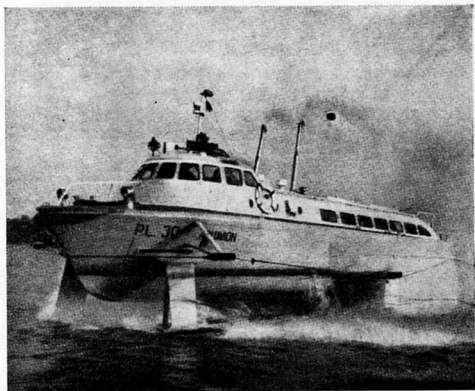
Fig. 1 - L'AQUASTROLL in prova a Rotterdam. L'AQUASTROLL venne costruito dalla International-Aquavion per la SHELL TANKERS LTD. che lo utilizzerà nel Venezuela adibendolo al trasporto del personale.
