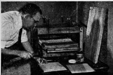
Fig. 5. - Una pressa è necessaria per determinare una buona incollatura dei particolari sulla tavoletta
