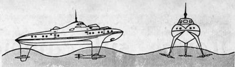
Fig. 4 - Non trovandosi lo scafo della nave a contatto dell'acqua, i passeggeri ignorano il beccheggio ed il rullio.
