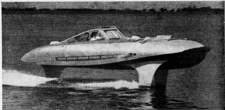
Fig. 2 - In Germania (Amburgo) un ingegnere tedesco sta sperimentando questo nuovo tipo di scafo ad ali subacquee.
