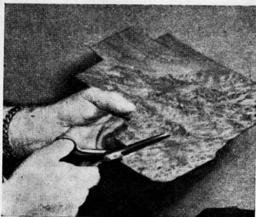
Fig. 3 - Ritaglieremo a mezzo forbici bene affilate, da un determinato tipo di legno, tutti quei particolari che debbono risultare di identico colore
