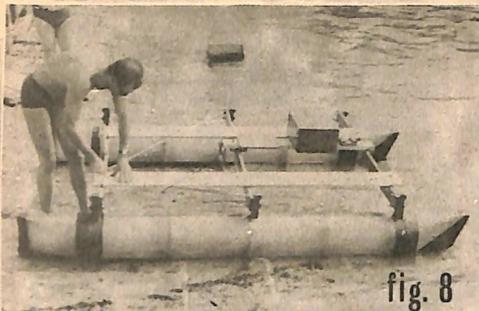
Fig. 7-Ecco come si presenta, al montaggio, la struttura-base dell'imbarcazione. Poiché la copertura in laminato di vetro è traslucida si intravedono, all'interno dei galleggianti le ordinate di larice. Al traverso di poppa è fissato, nella sua mezzeria, un rettangolo di abete di notevole spessore, disposto in modo che le fibre del legno risultino verticali; esso può ottimamente funzionare da supporto per un motorino fuoribordo non troppo potente.
