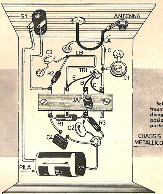
Schema pratico del trasmettitore; le parti disegnate rispettano la posizione di quelle appartenenti al prototipo.
