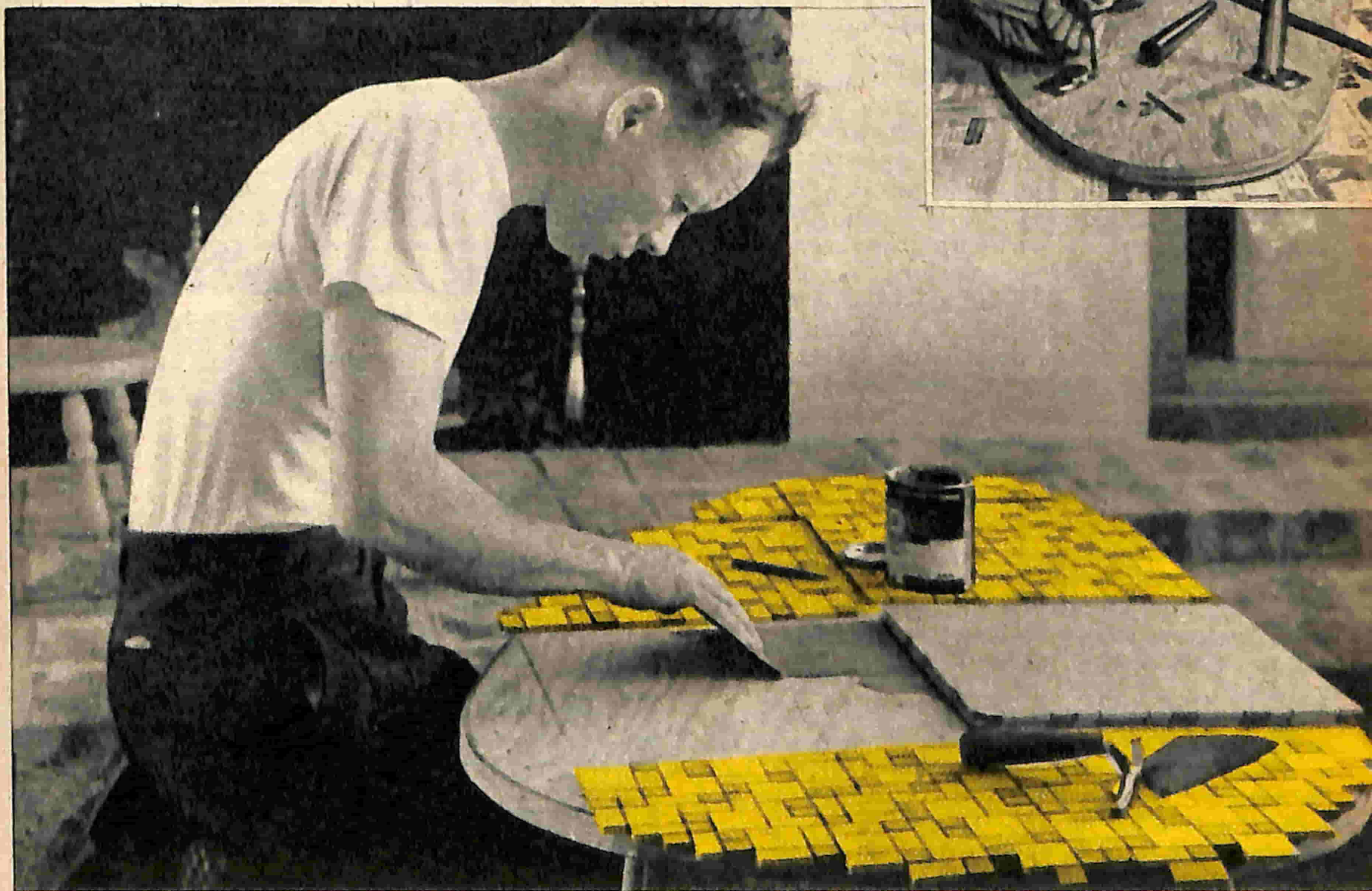
Fig. 5 - Le piastrelle vengono fissate al piano per mezzo di adesivo steso con l'ausilio di spatola dopo che si siano riunite — costa a costa — a riquadri, tenuti mediante l'uso di carta di minimo spessore incollata sulla superficie smaltata delle stesse.
