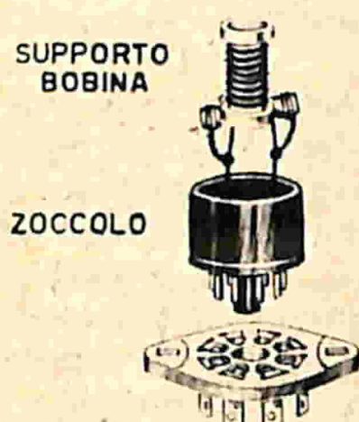
Fig. 4 - Sia la bobina d'aereo che quella oscillatrice verranno montate su uno zoccolo octal in bachelite.
