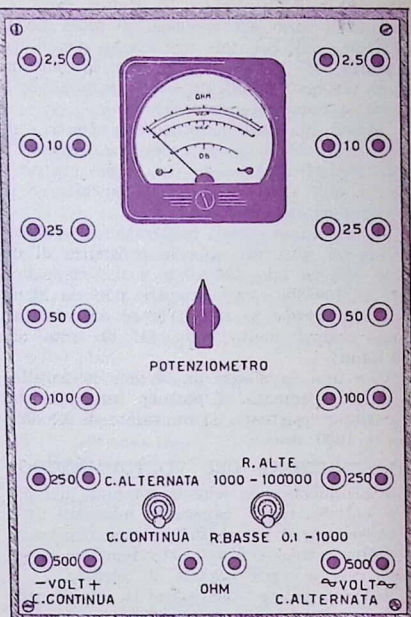
Fig. 10. - Come vengono disposti sul pannello frontale i vari comandi, le boccole e lo strumento di misura.
