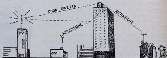
Fig. 3. — Un'onda diretta può dare origine quando incontra un ostacolo ad onde riflesse o rifratte. Entrambe possono provocare sullo schermo uno sdoppiamento dell'immagine.
