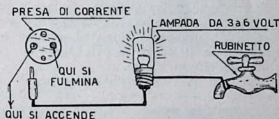
Fig. 2. - Nella boccia della presa luce, dove la lampadina normale non si illuminava, inseriremo una lampadina a basso voltaggio (lampadine da bicicletta), collegando sempre un capo ad una presa di terra noteremo che questa si illuminerà senza pertanto che il contatore segni il consumo. Fare attenzione a non confondere nella presa luce, la boccia del neutro con quella di corrente.
