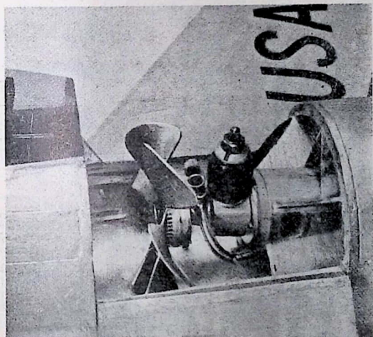
Ecco come praticamente si presenta il motore entro alla fusoliera.
