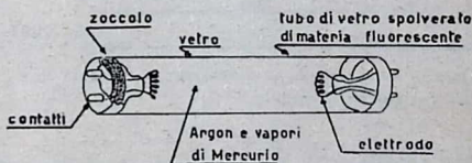
Fig. 1. — Come è costituito un tubo fluorescente.
