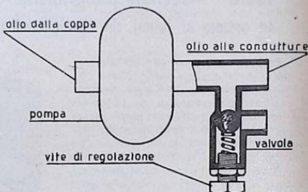
Fig. 2 Valvola di pressione e scarico olio.
