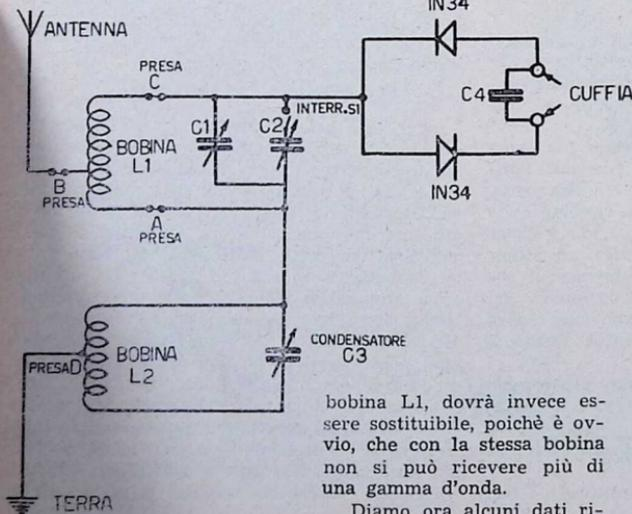
bobina L1, dovrà invece essere sostituibile, poiché è ovvio, che con la stessa bobina non si può ricevere più di una gamma d'onda.
