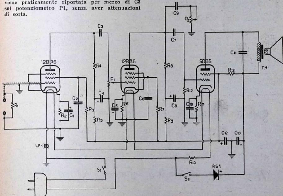
panello frontale vengono fissati i potenziometri e la spia luminosa LP1. Il cablaggio è molto semplice. Verrà iniziata la costruzione montando per prime tutte le connessioni dei filamenti e tutta la parte alimentatrice: RS1, R13, R12, C13, C12. Si continuerà nella costruzione montando T1, C11, R11, C10, R10, C7, C9, P2. Terminata la parte dell'amplificatrice finale si terminerà quella della seconda 12BA6, ed indi quella della prima 12BA6.
