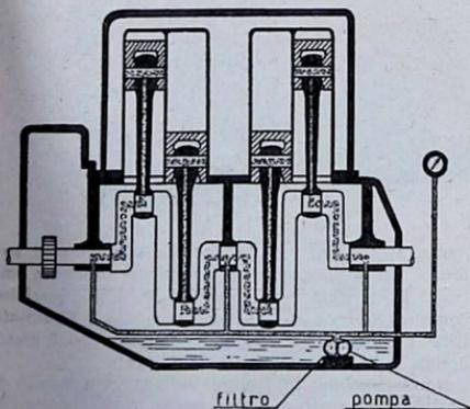
Fig. 1 Circolazione olio in un motore.
