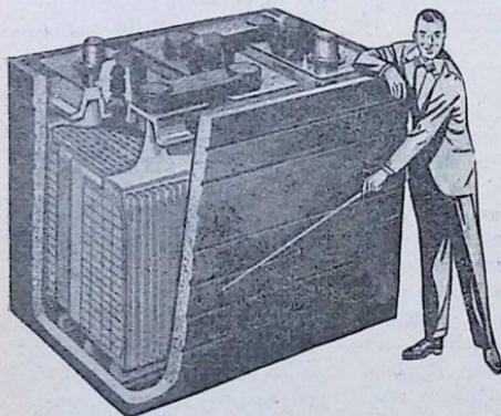
corrente. Se l'elemento deve rimanere inattivo per molto tempo, conviene svuotarlo, lavarlo abbondantemente con acqua limpida e riempirlo di acqua distillata, chiudendolo bene onde evitare ogni evaporazione.
