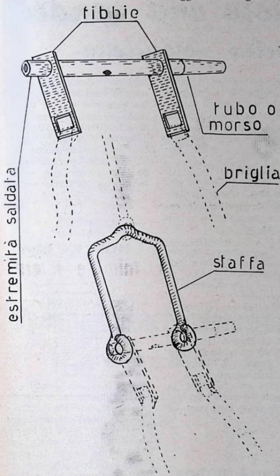
Pure saldate saranno le due fibbie laterali. A metà della distanza fra le due fibbie, verrà praticato un foro di circa un cm. di diametro, lungo circa 10 cm., la stessa sarà piegata ad «U», e le sue estremità saranno arrotondate, onde permettere all'insieme di ruotare nel morso preparato in precedenza.
