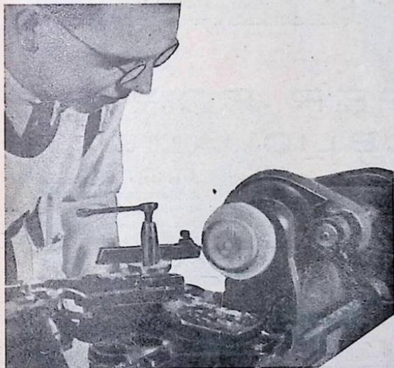
Per poter sfruttare completamente un tornio, nella lavorazione delle materie plastiche, è necessaria una buona lubrificazione onde eliminare quegli inconvenienti dovuti al riscaldamento del materiale in lavorazione. Con una buona lubrificazione, oltre ad eliminare il riscaldamento dell'oggetto e dell'utensile, si evita l'accumularsi dei trucioli, permettendo così una maggior visibilità sul lavoro da eseguire.
