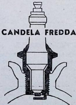
un ponticello di depositi carboniosi, che mette in corto circuito la candela. Quando si
