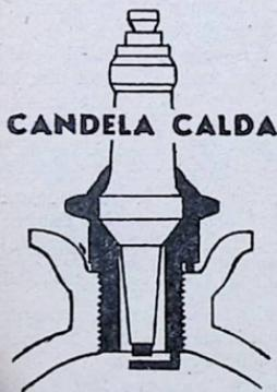
pio un carburatore poco efficiente, o una combustione incompleta. Una combustione irregolare può essere originata dall'impiego di una candela non adeguata al tipo di motore.
