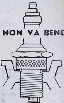
scocchi nessuna scintilla. In codesto caso occorre sostituire la candela inadatta con una di tipo più freddo. Naturalmente è necessario usare in inverno candele più calde che nel periodo estivo, poiché la temperatura ambiente ha una notevole influenza sul raffreddamento del motore.
