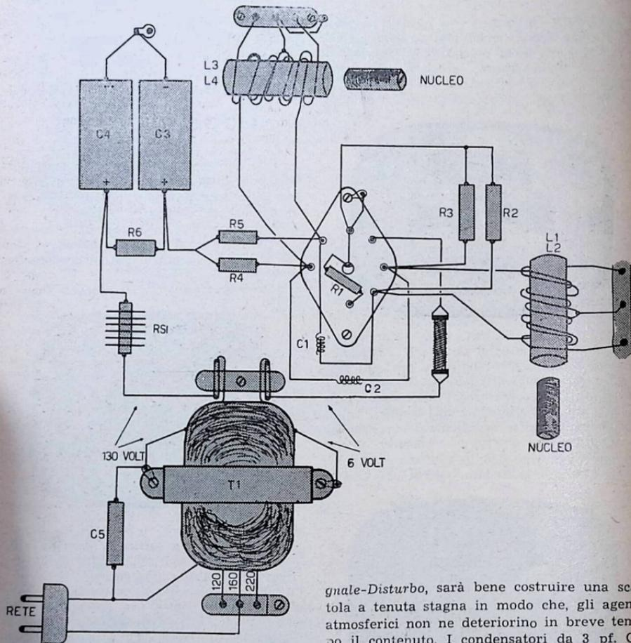
tro provvisto di nucleo ferromagnetico per la messa a punto. Si potrà far uso di un vecchio supporto da Media Frequenza che facilmente ogni dilettante dispone. La tabella 1 ci fornirà completamente esatti, i dati necessari per costruire tali bobine rispetto al canale desiderato.
