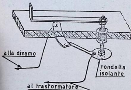
menti, sarà bene montare un anello di gomma, oppure di nastro adesivo. La dinamo sarà tenuta aderente al disco, tramite la molla già esistente nel suo attacco, la molla stessa che permette alla dinamo di stare appoggiata al pneumatico della bicicletta quando noi volontariamente la togliamo dalla sua posizione di riposo.
