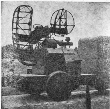
Fig. 6. - Sistema radar occhio-elettronico abbinato, di scorta alle artiglierie contraeree per il calcolo automatico delle tabelle di tiro.
