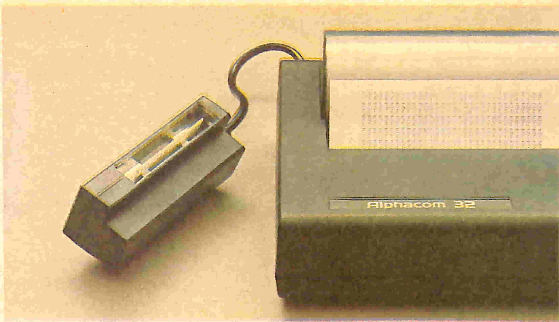
Il connettore dell'Alphacom consente l'inserimento di altre periferiche.
