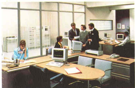
Il Modello B50 del Sistema AS/400 IBM in ambiente d'ufficio. Le unità sono montate in "rack" per un minor ingombro e una espansione modulare. Il sistema non richiede condizionamento ed è particolarmente silenzioso.
