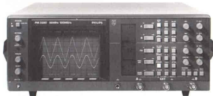
L'oscilloscopio digitale PM 3350 Philips, con 100 Ms/s, è adatto a misure su circuiti a tecnologia avanzata.
