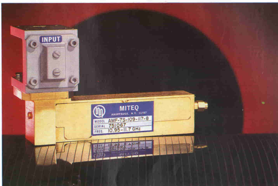
Amplificatori a basso rumore serie AMF della MITEQ. Guadagno: da 20 a 60 dB. Frequenze di lavoro: da 2,7 a 15,3 GHz. VSWR all'ingresso: 1,25:1. VSWR all'uscita: 1,5:1.
