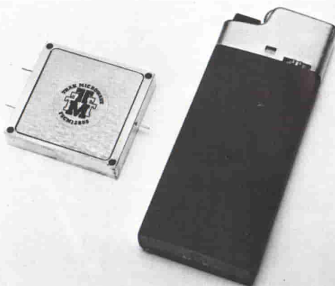
Generatore "comb" della TRAK MICROWAVE per montaggio superficiale. Frequenza di lavoro: da 2 a 18 GHz. Spaziatura "comb"; 500 MHz. Potenza d'uscita: — 39 dBm.
