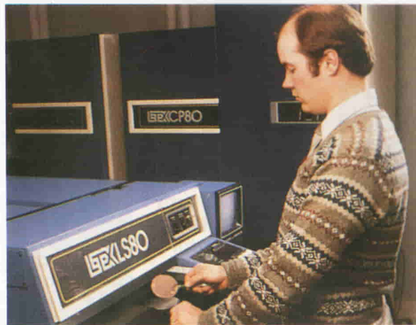
Il test automatico RF dei parametri di un circuito integrato "custom"; viene effettuato a livello di wafer a frequenze che vanno dalla continua fino 26,5 GHz. Il test digitale viene effettuato a 4 Gb/s.
