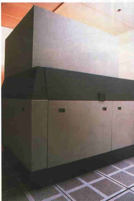
Come si presenta la macchina AEBLE 150 della Perkin-Elmer per la scrittura diretta sul wafer. Essa permette di eliminare le operazioni convenzionali, quali deposizione del fotoresist sul wafer, applicazione della maschera, esposizione ai raggi ultravioletti e immersione nel solvente.
