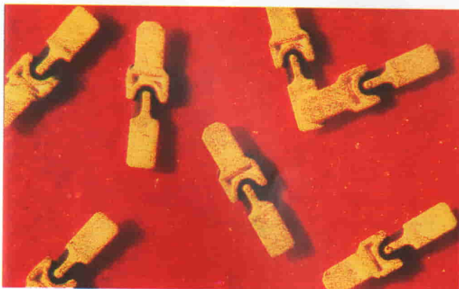
Diodi PIN "beam lead" veloci in tecnologia planar e mesa della ALPHA INDUSTRIES. Capacità della giunzione: 0,02 pF. Resistenza in serie: 2,8 \Omega ; Velocità di commutazione: 3 ns.
