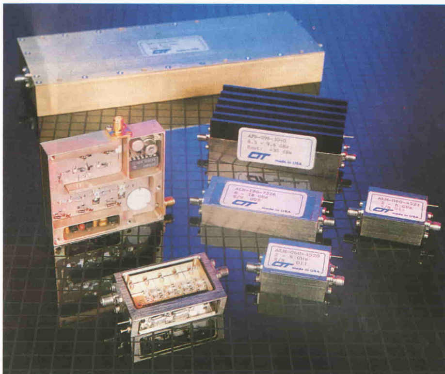
Amplificatori GaAs FET della CCT. Frequenze di lavoro fino a 18 GHz. Guadagno fino a 45 dB.
