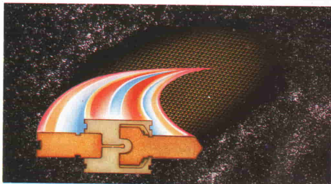
Diodi PIN "beam lead" in tecnologia Mesa della METELICS CORP. Tipo MPB 1030-B11. Capacità: 0,20 pF. Resistenza in serie (3 GHz, 50 mA): 4 \Omega .
