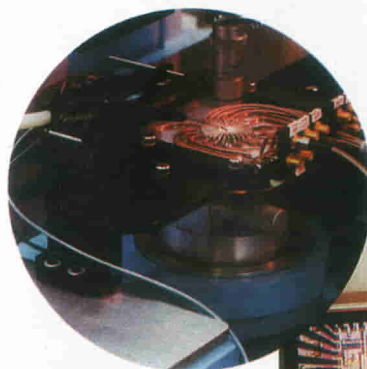
Verifica del funzionamento a 2 GHz di un circuito integrato digitale su una stazione semiautomatica di controllo.
