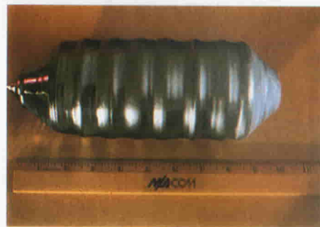
Fig. 2 - Cristallo di ben 8 kg non ancora drogato, ricavato con tecnologia LEC. Il materiale è arseniuro di gallio.
