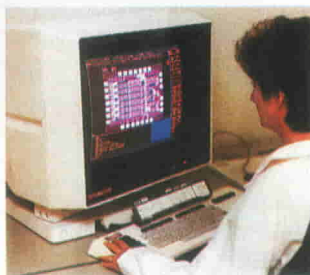
Controllo del layout di un circuito GaAs e sua simulazione SPICE su stazione di lavoro della Mentor Graphics.
