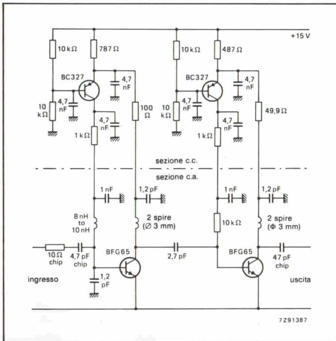
**Fig. 3 - Amplificatore a frequenza intermedia a larga banda a due stadi realizzato con i transistori BFG 65. In alto, si trova la sezione in c.c.; in basso, quella in c.a., quella cioè che provvede all'amplificazione del segnale.**
