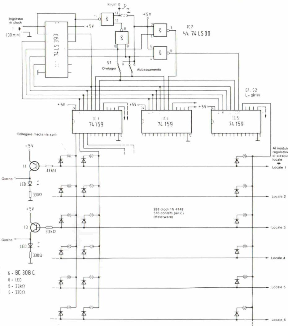
**Fig. 3.** Così avviene l'interconnessione dei tempi e dei locali da riscaldare, mediante spilli inseriti in contatti a molla. Il tasto di reset, disegnato con linee tratteggiate permette di azzerare l'orologio alle ore 00,00. Per inserire questo tasto sarà necessario interrompere una pista del circuito stampato, saldando poi ai due tronconi un resistore da 10 kΩ. Sullo schema non sono stati disegnati i due condensatori di disaccoppiamento.
