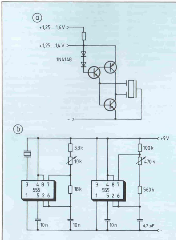
**Fig. 5 - Circuito di principio di un generatore di nota realizzato con un dischetto piezoelettrico, a) circuito autooscillante adatto per alimentazioni di basso valore; b) circuito per produrre l'effetto "sirena".**
