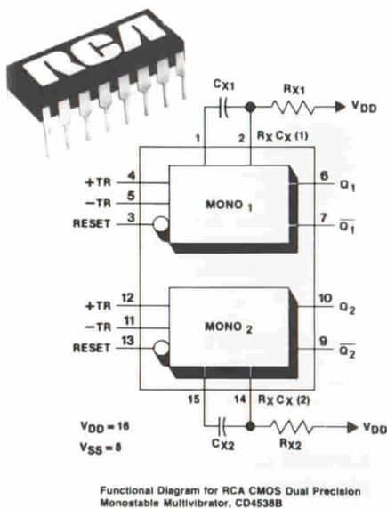
Multivibratore monostabile doppio RCA denominato CD4538B fornibile in package dual-in-line o plastico a 16 pin.
