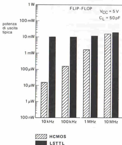
Fig. 5 - Valori tipici di dissipazione in un flip-flop in funzione della frequenza. Il grafico in tratteggio si riferisce a c.i. HCMOS.
