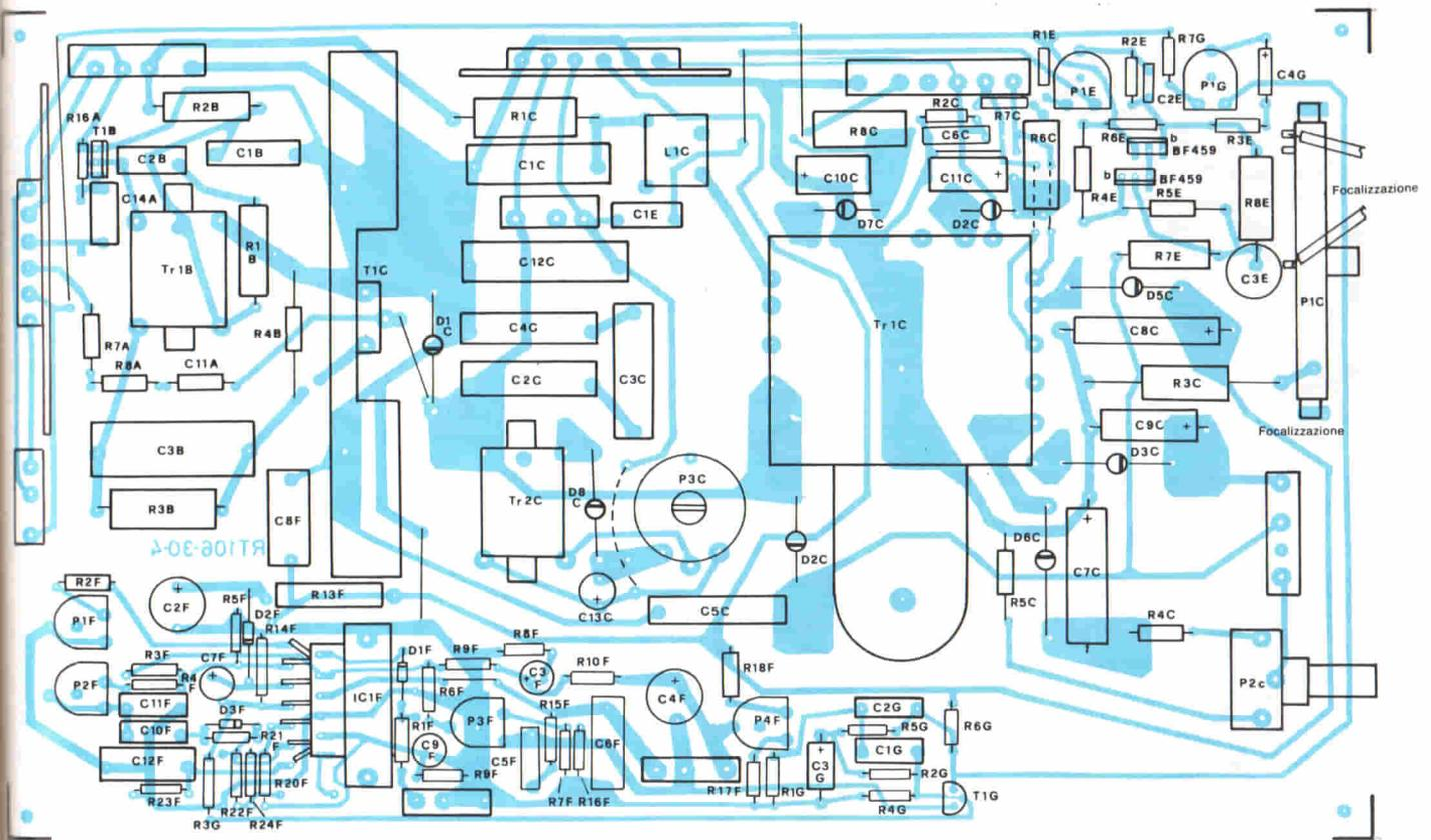
Fig. 4 - Circuito della piastra principale con i componenti montati.
