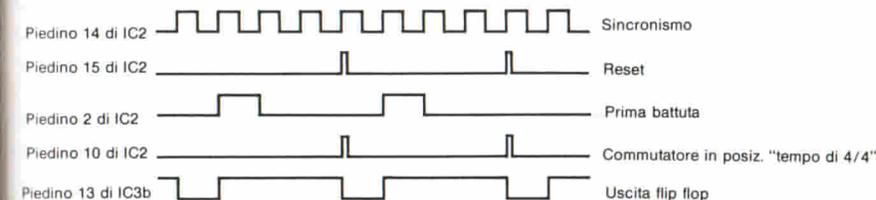
Fig. 3. Esempio di diagramma degli impulsi per un tempo di 4/4. Dopo ciascun reset, viene emessa la nota relativa alla prima battuta.
