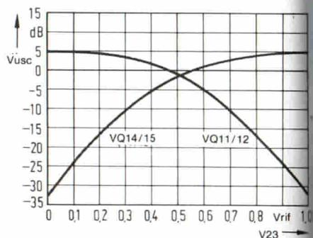
Fig. 6. Campo di regolazione del potenziometro di bilanciamento P3 e suo effetto sulle uscite dei canali sinistro e destro.
