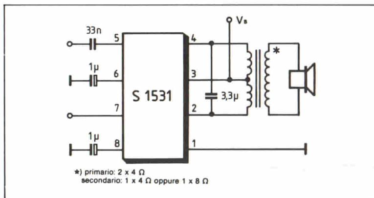
Fig. 3 - Sostituzione dell'altoparlante con presa centrale con un trasformatore con primario con presa centrale. Il rendimento è leggermente inferiore ma la soluzione è più economica e fattibile.
