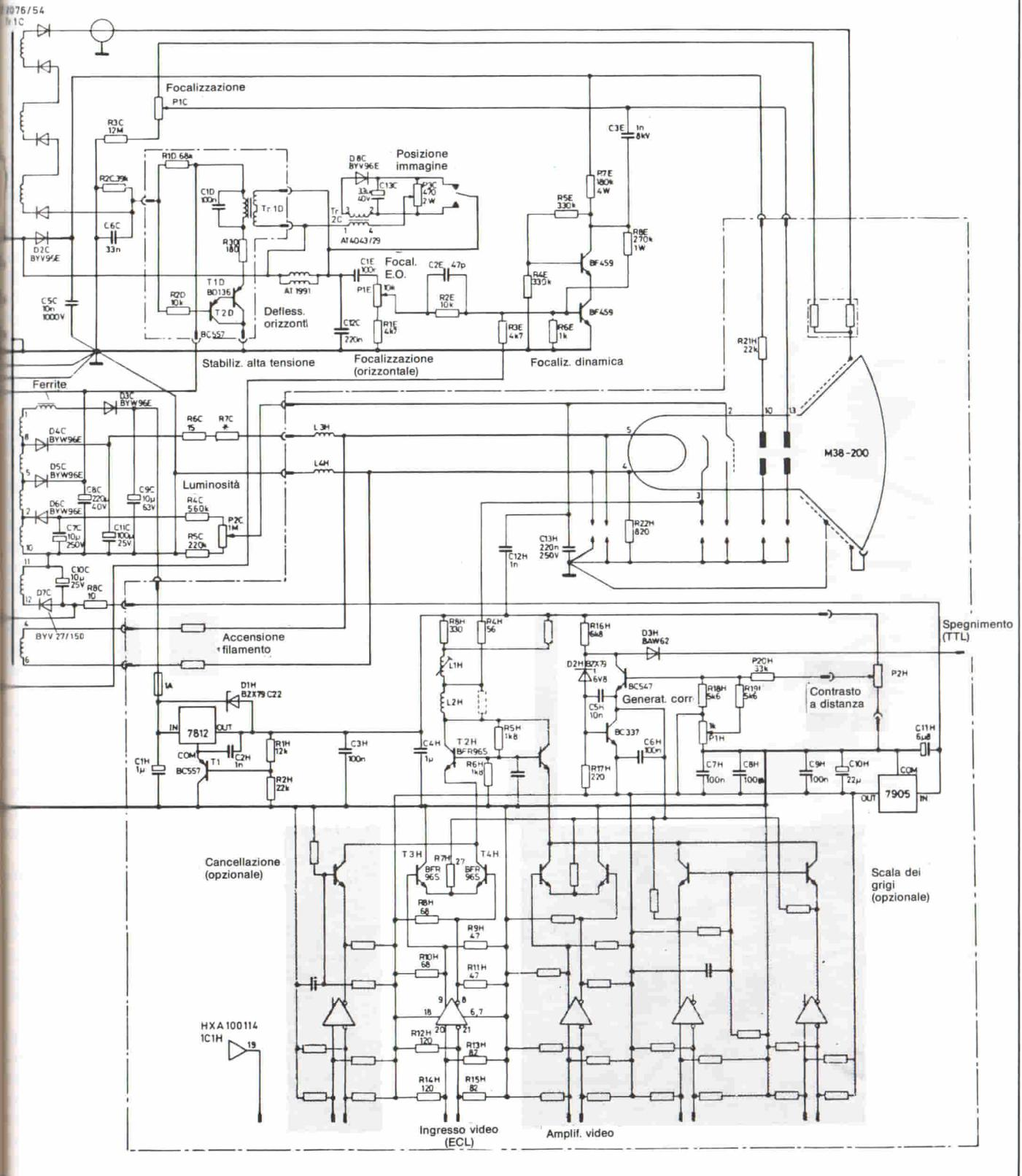
to, oltre al tubo appositamente studiato per fornire una definizione così elevata, occorrerà disporre di una adeguata unità di deflessione. A questo scopo è stata progettata l'unità AT 1991; gli avvolgimenti delle bobine sono stati realizzati secondo la nota tecnica già attuata per la realizzazione degli avvolgimenti dell'unità di deflessione del sistema autoconvergente 30AX per tele-
