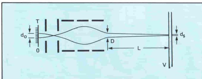
Fig. 11 - Parametri che determinano il diametro ( $d_s$ ) del punto luminoso (spot) sullo schermo.
