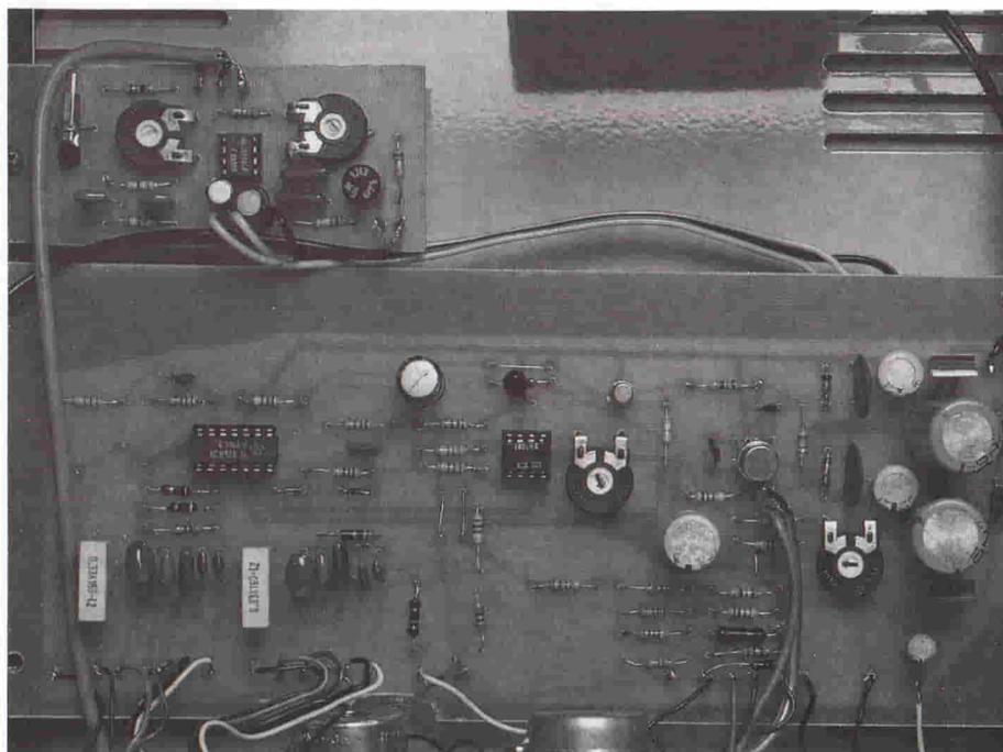
comune del ponte di Wien, costituito dal cursore del potenziometro P3. Se essi giungono in tale punto con la stessa ampiezza e sfasati di 180°, il risultato, disponibile all'uscita del buffer costituito da IC1c, è nullo. Lo sfasamento di 180° è prodotto da IC1b, mentre i due rami del ponte di Wien non devono apportare ulteriori sfasamenti sul segnale.
