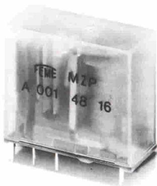
Relé da 16 A con un contatto di scambio o 1 NA o 1 NC, con doppia piedinatura in uscita a reticolo standard 2,5 mm.
