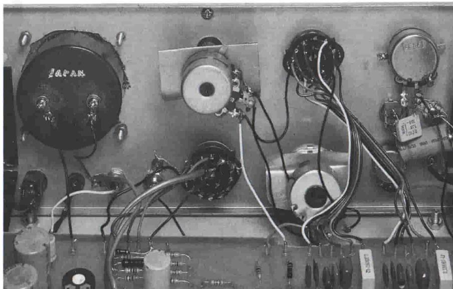
Collegando un oscillografo all'uscita "out distorsione" risulta molto più semplice determinare il punto di equilibratura del ponte, perchè si vede chiaramente l'annullamento della frequenza fondamentale, ancora più evidente se l'oscilloscopio è a doppia traccia e un canale è collegato alla presa "out distorsione" e l'altro alla presa "out segnale".
