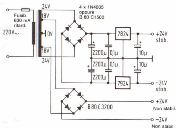
**Fig. 4. Schema dell'alimentatore proposto per questo circuito. Per il dimensionamento del trasformatore, vedi testo.**
