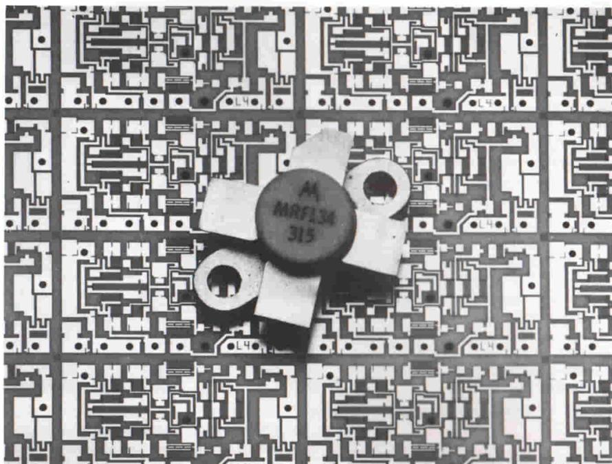
*Nuova linea di Mosfets di potenza RF con potenza d'uscita da 5 a 125 W, a 150 MHz. I dispositivi sono denominati: MRF134, MRF136, MRF171, MRF172 e MRF 174.*
