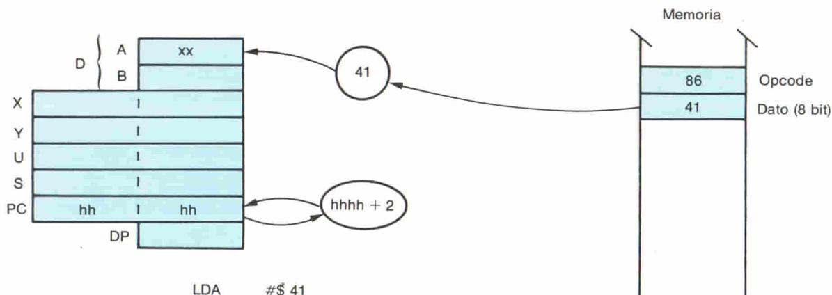
Fig. 2 - Modo immediato: procedimento dell'esecuzione dell'istruzione. Questa è un caricamento in Accumulatore (LDA) di un valore a 8 bit: \$41. In memoria, tale valore è specificato subito dopo il Codice Operativo stesso. Dopo l'esecuzione, \$41 si troverà nell'Accumulatore A, ed il PC è incrementato di 2, pronto a puntare al Codice Operativo della successiva istruzione del programma.
