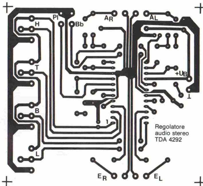
**Fig. 9.** Piste di rame del circuito stampato.
