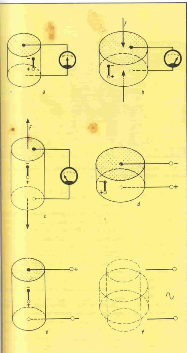
**Fig. 2 - Il fenomeno della piezoelettricità in un cilindro: a) cilindro non sollecitato; b) cilindro sollecitato con una pressione; c) cilindro sollecitato con una trazione; d) sollecitazione elettrica di segno opposto a quello della polarizzazione; e) sollecitazione elettrica di segno uguale a quello della polarizzazione; f) sollecitazione elettrica con campo alternato.**
