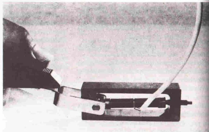
**Fig. 6 - Sistema per esercitare la pressione meccanica nei trasduttori piezoelettrici per alta tensione.**
