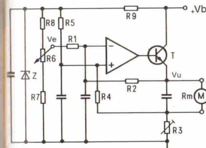
Fig. 1. Circuito base di un amplificatore di regolazione per stabilizzare il numero di giri di motori a corrente continua con rotore senza ferro.
