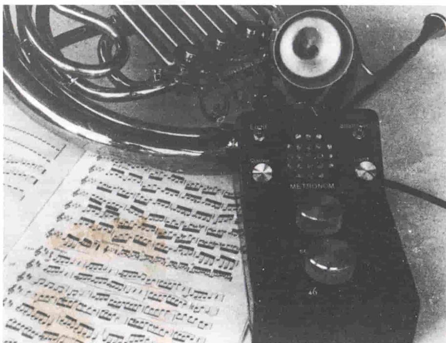
Fig. 1. Metronomo elettronico con indicazione luminosa delle battute.
