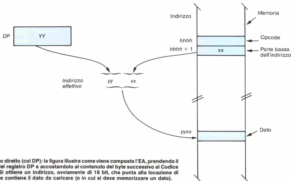
**Fig. 4 - Modo diretto (col DP):** la figura illustra come viene composto l'EA, prendendo il contenuto del registro DP e accostandolo al contenuto del byte successivo al Codice Operativo. Si ottiene un indirizzo, ovviamente di 16 bit, che punta alla locazione di memoria che contiene il dato da caricare (o in cui si deve memorizzare un dato).
