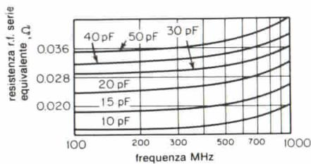
Fig. 4 - Variazione della ESR in funzione della frequenza (VHF e UHF) in un condensatore con dielettrico in ceramica.
