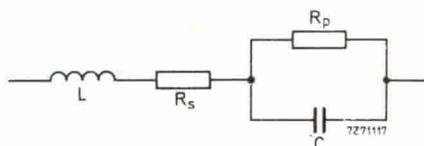
Fig. 1 - Circuito equivalente di un condensatore.
