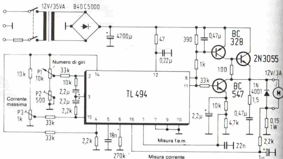
Fig. 3. Schema completo, con le seguenti funzioni: regolazione del numero di giri, regime minimo di rotazione possibile e protezione di sovracorrente.
