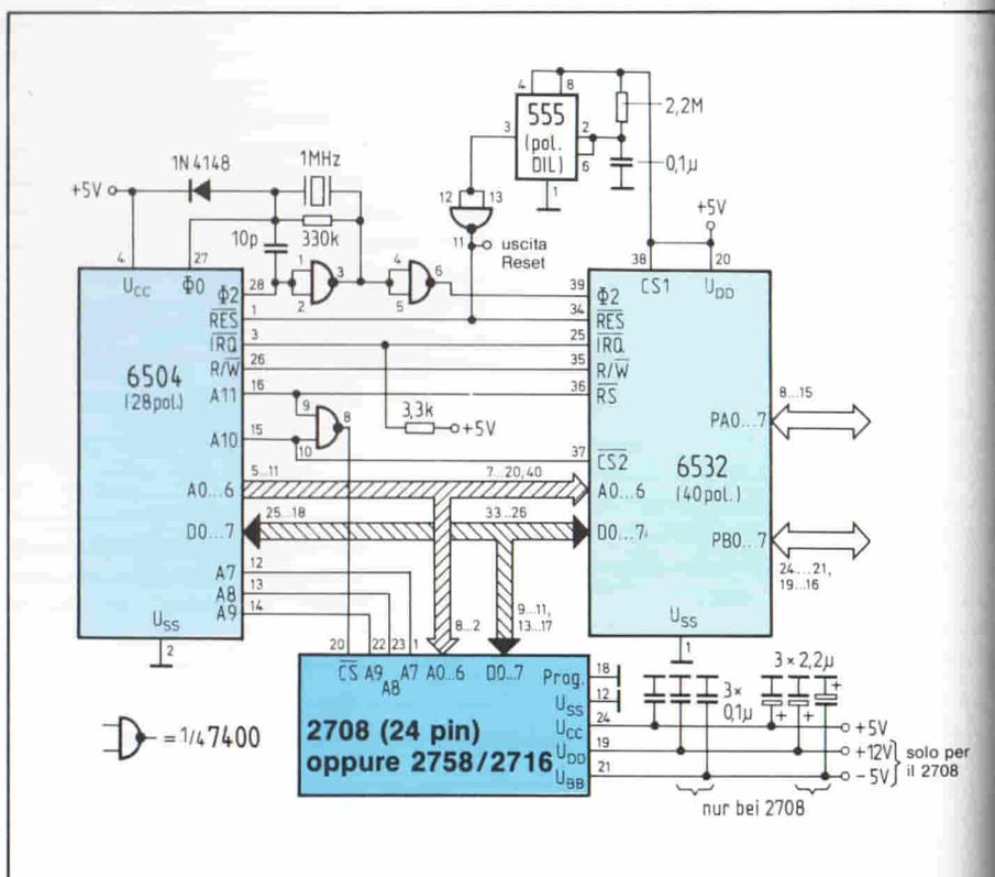
Fig. 1 - Circuito completo dell'ECC-65 con 1 o 2K di EPROM 128 Bytes di RAM in Interrupt-Time programmabile e 16 linee di ingresso/uscita.
