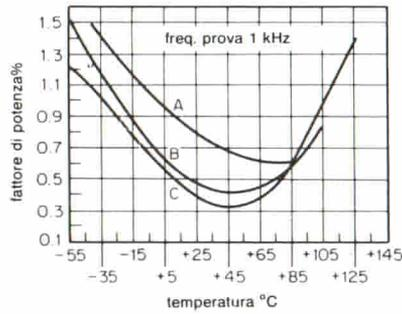
Fig. 3 - Andamento del fattore di potenza in funzione della temperatura per tre differenti tipi di condensatori. (a) a carta impregnata, (b) carta mylar impregnata; (c) mylar.
