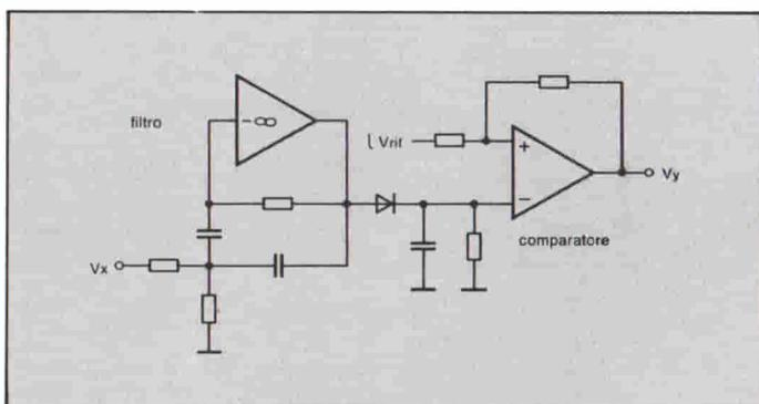
Fig. 8 - Circuito per l'identificazione di fenomeni di squilibrio nel funzionamento del motore.
