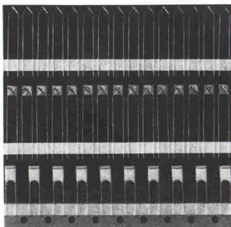
**Fig. 4 - Fasi successive nella produzione dei condensatori ceramici piatti; (in alto), terminali nei quali è stata già formata la flangia; (al centro), applicazione dei terminali sulla piastrina di ceramica ricoperta di rame; (in basso), laccatura della piastrina e coloritura per l'individuazione del valore del condensatore in base al codice dei colori.**
