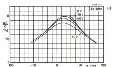
**Fig. 6 - Variazione della capacità  $\Delta C$  rispetto alla capacità  $C$  (a 0 V, 20°C), in funzione della temperatura  $T$  per tre differenti tipi di condensatori ceramici.**
