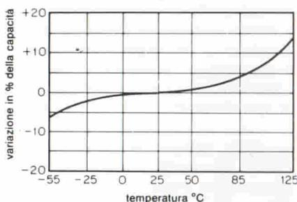
Fig. 7 - Andamento della capacità al variare della temperatura dell'ambiente.
