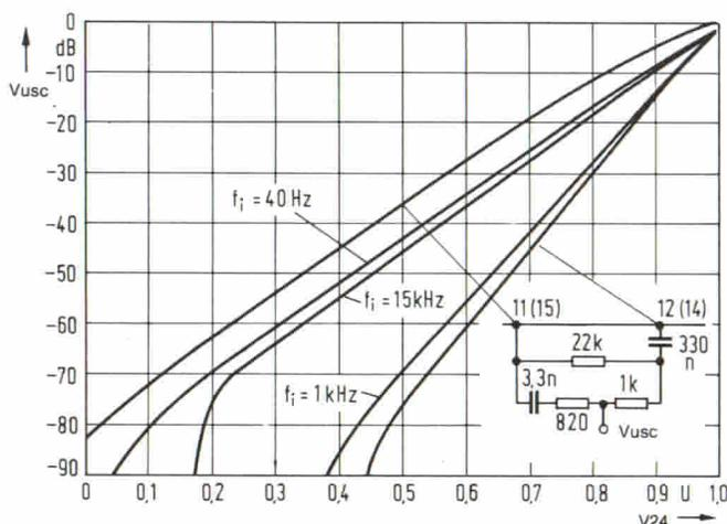
Fig. 7. Effetto ottenuto quando viene inserita la regolazione "fisologica". La risposta in frequenza viene corretta in modo da accordarsi all'andamento della sensibilità uditiva.
