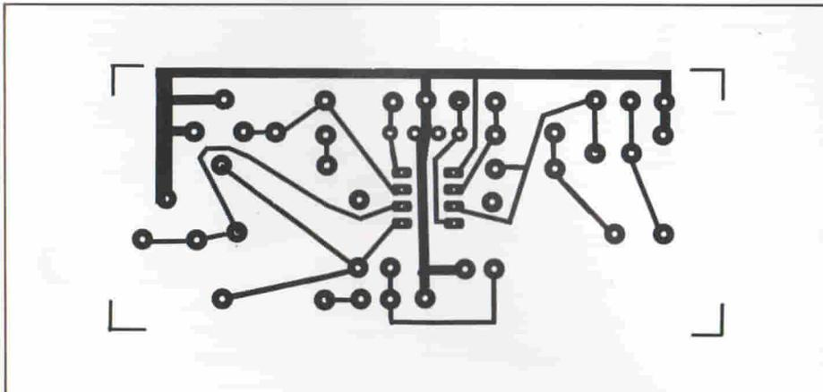
Fig. 7 - Circuito stampato dell'oscillatore sinusoidale.
