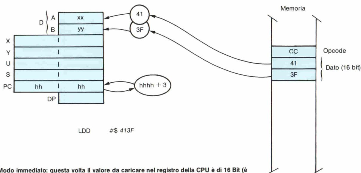
Fig. 3 - Modo immediato: questa volta il valore da caricare nel registro della CPU è di 16 Bit (è interessato il Registro D). Per il resto, vale la discussione per la figura 2.
