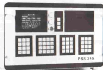
*Esempio di applicazione dei kit di interruttori a membrana; adatti non solo per la sperimentazione, ma anche per la produzione di piccole serie.*
