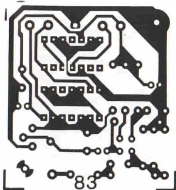
Fig. 8. Piste di rame e disposizione dei componenti sul circuito stampato del preamplificatore No. 1 (per frequenze minori di 80 MHz).
