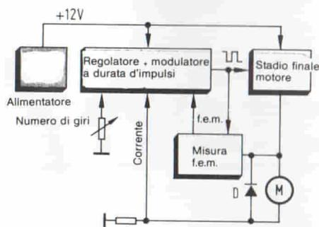
Fig. 1. Schema a blocchi di un sistema di pilotaggio per motore a corrente continua, che permette di regolare il suo numero di giri e di proteggerlo dalle sovracorrenti a rotore bloccato.
