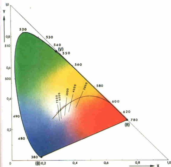
**Fig. 2 - Diagramma della cromaticità.** Gli attuali cinescopi, potendo disporre anche del terzo colore primario, e cioè del blu, sono in grado di riprodurre tutti i colori presenti nel diagramma. Il sistema Tektronix può invece riprodurre soltanto i colori ottenibili dalla mescolazione di luci colorate rosse e verdi aventi differente intensità luminosa.
