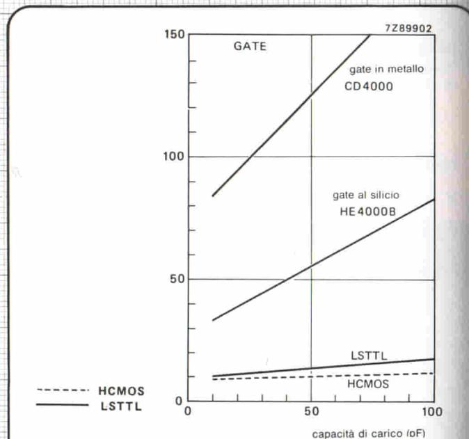
Fig. 2 - Ritardo di propagazione (in ns) in funzione della capacità di carico (in pF) nella famiglia dei c.i. integrati con gate in metallo (CD 4000), e con gate al silicio (HE4000B). In basso, sono riportati i tempi riguardanti la famiglia LSTTL e quella HCMOS. Dai grafici risulta che il ritardo di propagazione (con un carico di 50 pF) è stato ridotto a 1/6 rispetto a quello dei precedenti CMOS con gate al silicio e addirittura ad 1/12 rispetto a quello dei MOS con gate in metallo.
