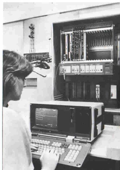
Automatismo di stazione Sinaut ST 1: si tratta di un sistema programmabile della Siemens per automatizzare pipeline e reti di distribuzione. Tramite i processori di comunicazione vi si possono collegare anche stampanti e sistemi sovraordinati.
