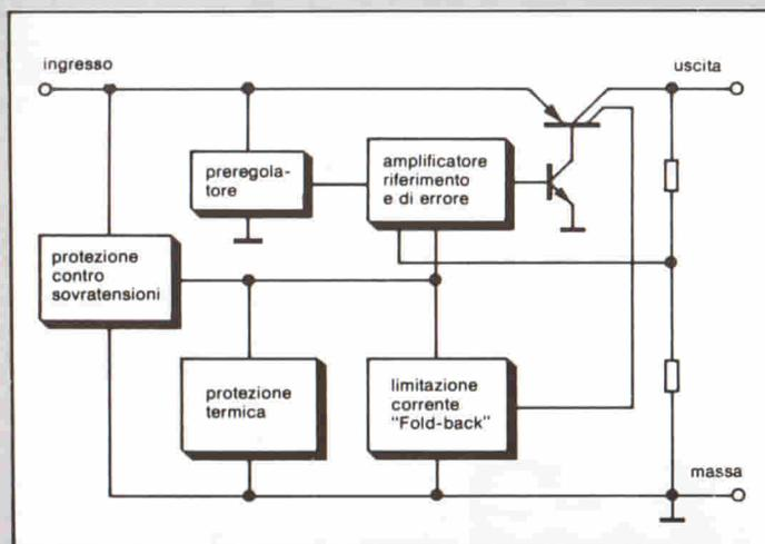
Fig. 1 - Struttura di un regolatore di tensione a bassa caduta di tensione. Come transistor di potenza in serie viene utilizzato un tipo PNP; la caduta di tensione del regolatore corrisponde in questo modo alla tensione di saturazione del transistor.
