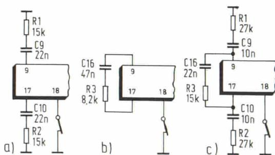
Fig. 4. Sono disponibili tre versioni circuitali per allargare la base stereo. Ciascuna versione ha i suoi pregi; tuttavia, quando si voglia autoconstruire il circuito, sarà opportuno scegliere la versione c.
