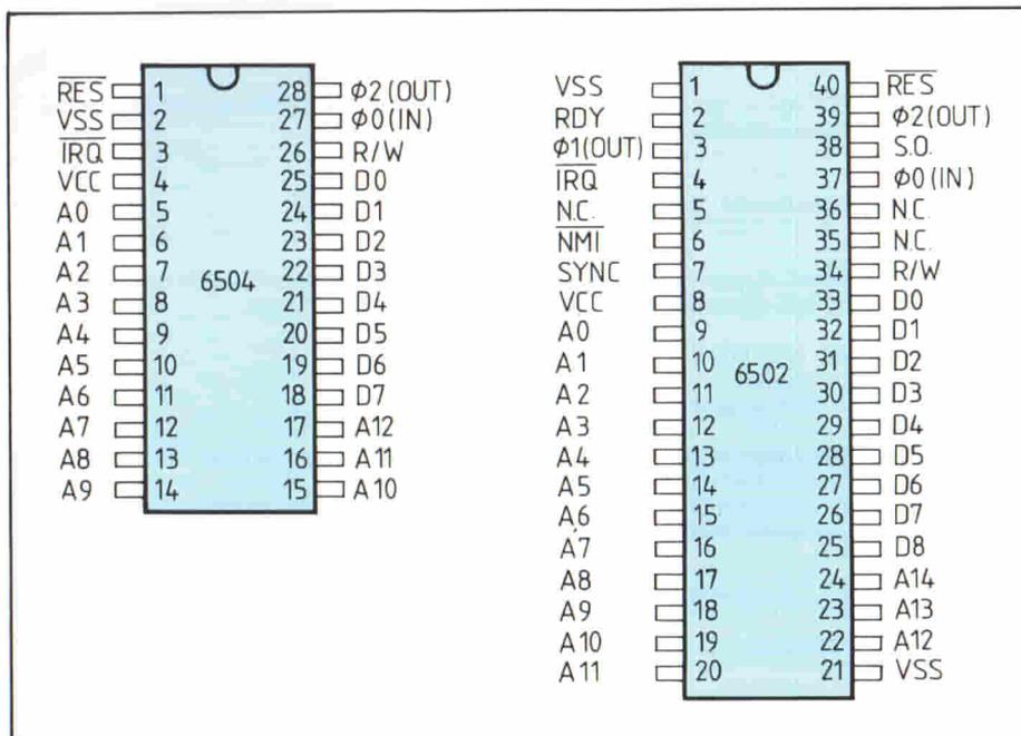
Fig. 1 - Il "pinout" del 6504 usato nell'ECC-65 e del software-compatibile 6502 usato in numerosi home- e personal-computer.
