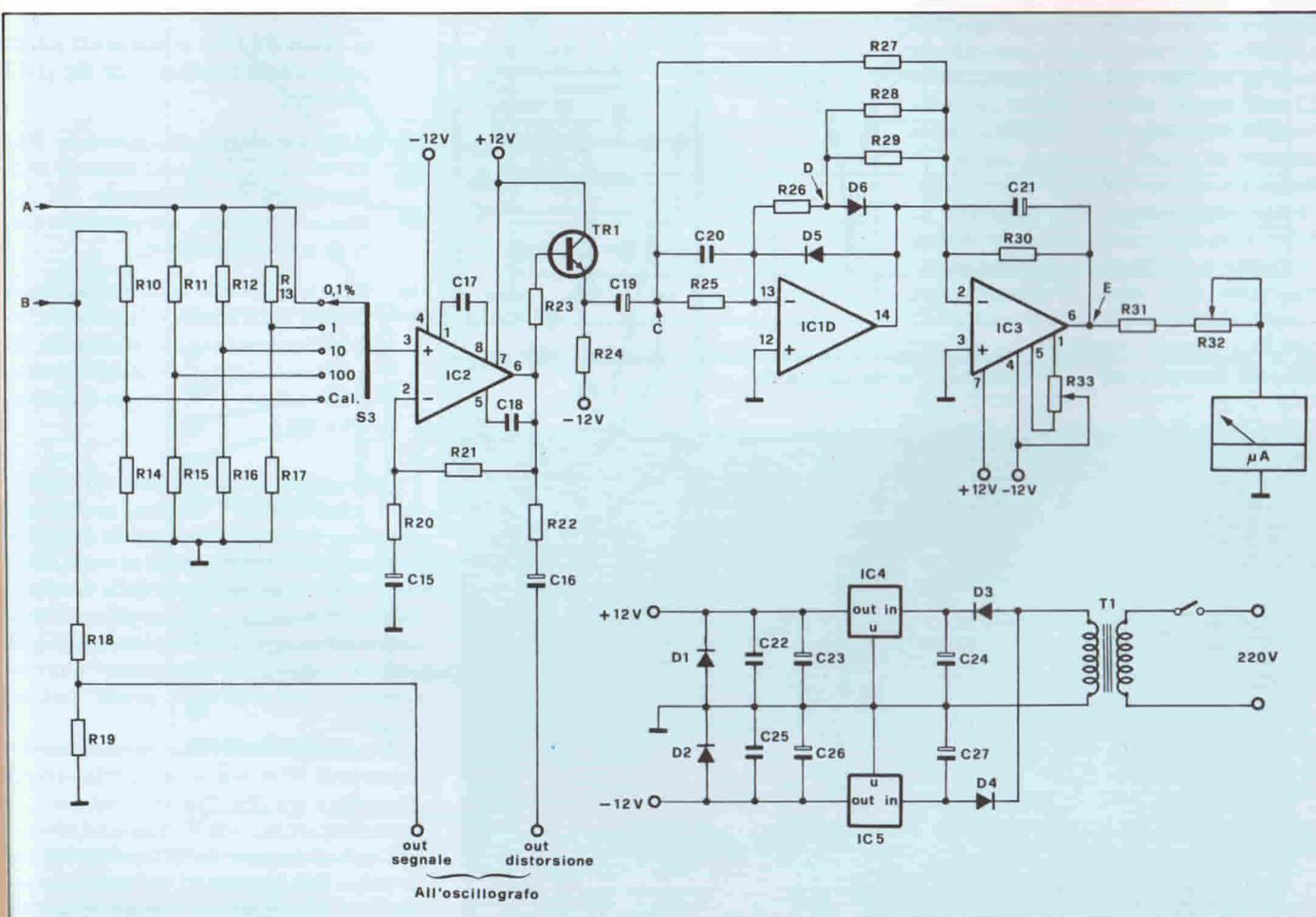
Fig. 2 - Schema elettrico del millivoltmetro del distorsionometro.
