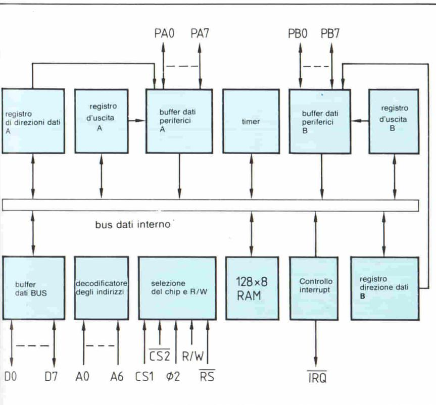
**Fig. 3 - Schema a blocchi interno del 6532. Le uscite del Port PB possono erogare fino a 3 mA.**
