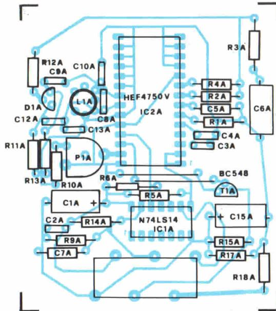
Fig. 6 - Disposizione dei componenti nello stampato di fig. 5.
