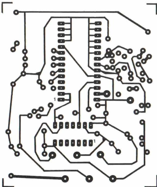
Fig. 5 - Circuito stampato dell'oscillatore di riga.
