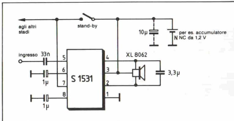
Fig. 2 - Esempio di applicazione dell'integrato S 1531.
