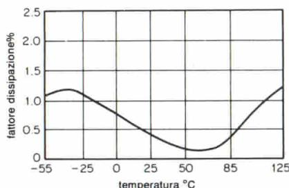
Fig. 6 - Variazione del fattore di dissipazione al variare della temperatura.
