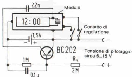
Fig. 1. Completamento del circuito per far funzionare l'orologio come conta-ore: sono necessari solo pochi componenti.
