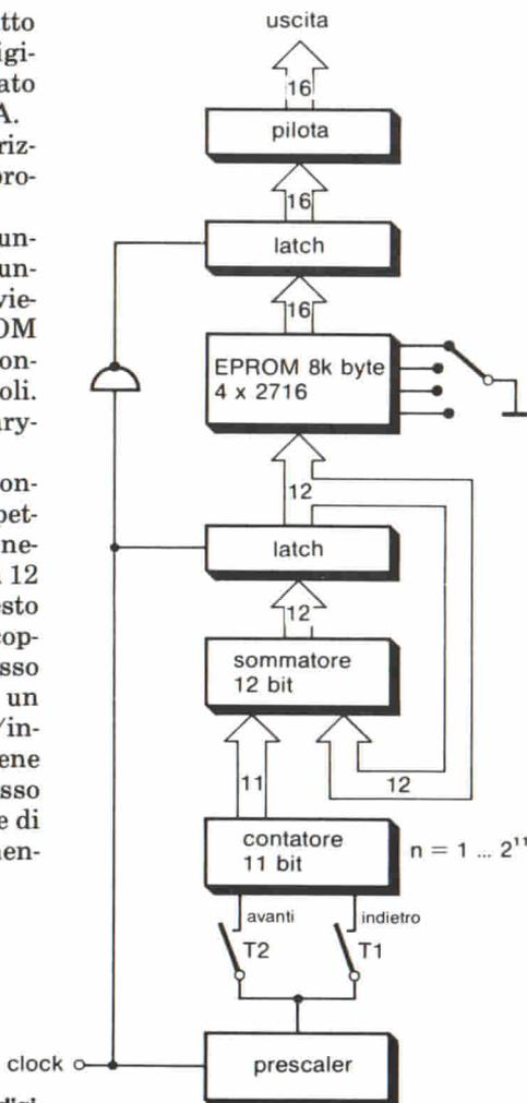
Fig. 1 - Schema a blocchi del generatore digitale di funzioni: nella EPROM potranno essere memorizzate funzioni di qualsiasi forma.
