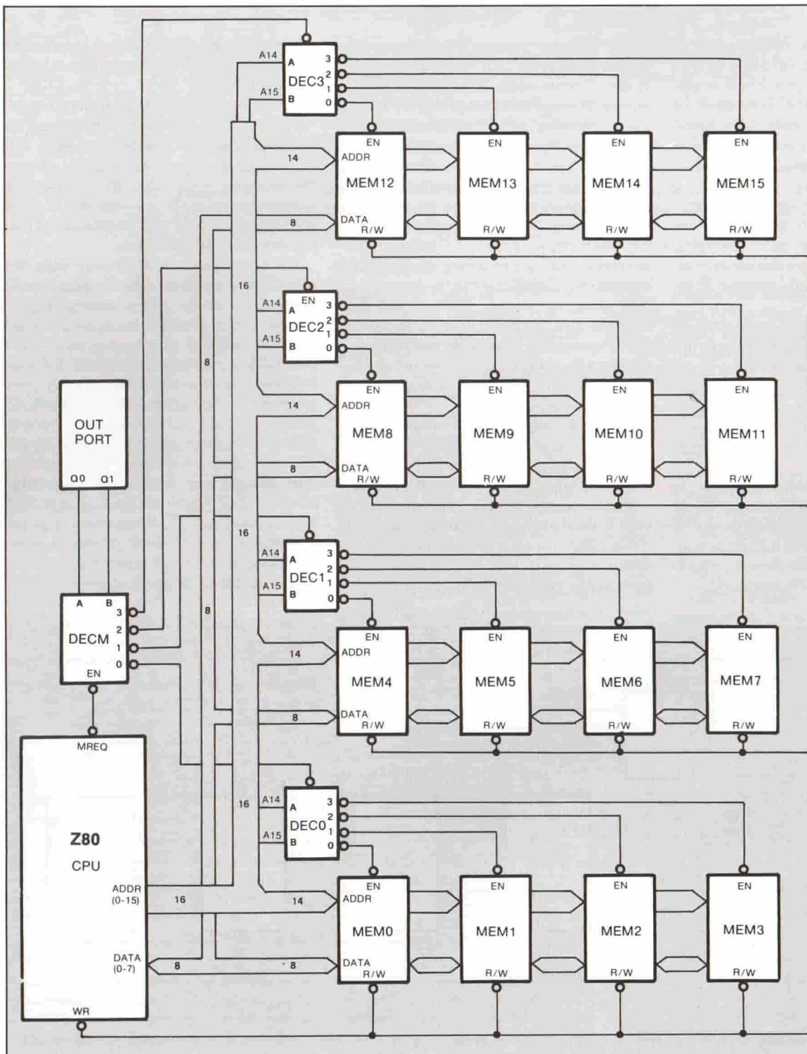
Fig. 2 - Mappaggio della memoria tramite port di uscita; ognuno dei quattro banchi ha una capacità pari a 64 Kbyte.
