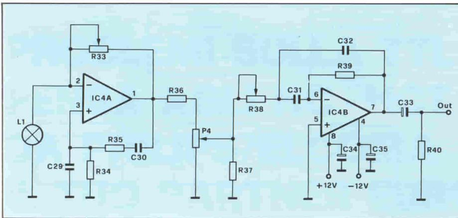
Fig. 6 - Schema elettrico dell'oscillatore sinusoidale.
