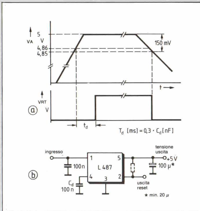
vesse assumere un valore inferiore a quello limite ammesso. Questo particolare circuito è contenuto nei regolatori L 487 e L 387. La figura 3 riporta il principio di funzionamento del regolatore e la figura 4 l'andamento nel tempo della funzione di reset. Il tempo di ritardo dell'impulso può essere programmato mediante un condensatore esterno.
