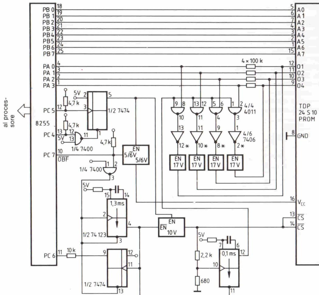
Fig. 1 - Schema del dispositivo per la programmazione delle PROM bipolari. In figura 2 sono illustrati i particolari dei generatori di tensione.
