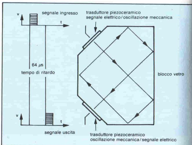
Fig. 13 - Struttura di una linea di ritardo per televisori PAL e indicazioni del percorso del segnale all'interno del vetro.
