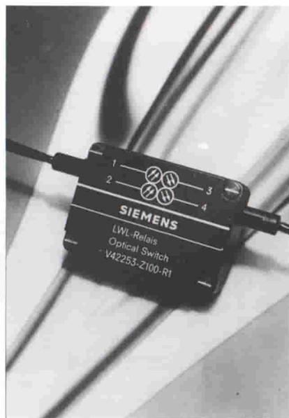
Nuovo relé di tipo pig-tail per commutazioni fra fibre ottiche. In posizione di lavoro, con ancora attratta, le due fibre si trovano esattamente una di fronte all'altra (la 1a allineata alla 2a, e la 3a alla 4a). Se l'ancora si riporta in posizione di riposo, le due fibre vengono scontate tra loro in modo da collegare la 1a alla 4a mentre la 2a e la 3a rimangono separate.
