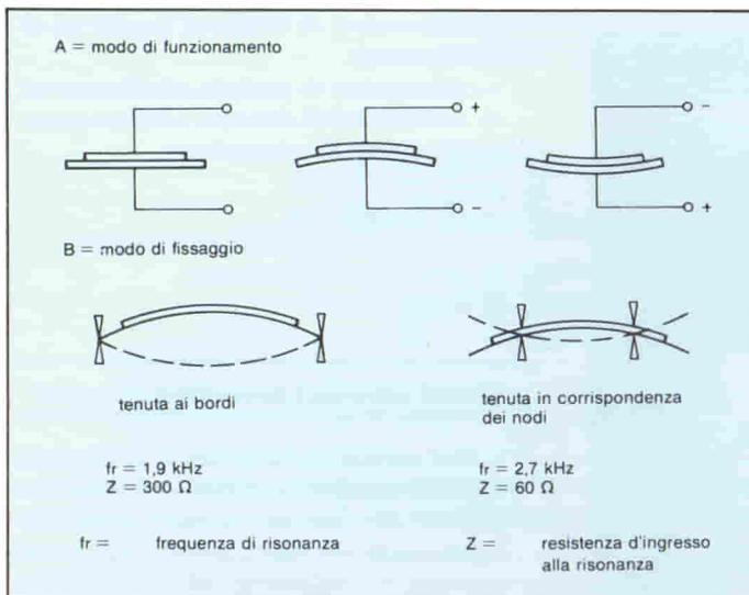
**Fig. 4 - Generatori di suono realizzati con dischetti piezoelettrici: a) struttura e funzionamento; b) sistemi di fissaggio del disco di ceramica sul supporto.**
