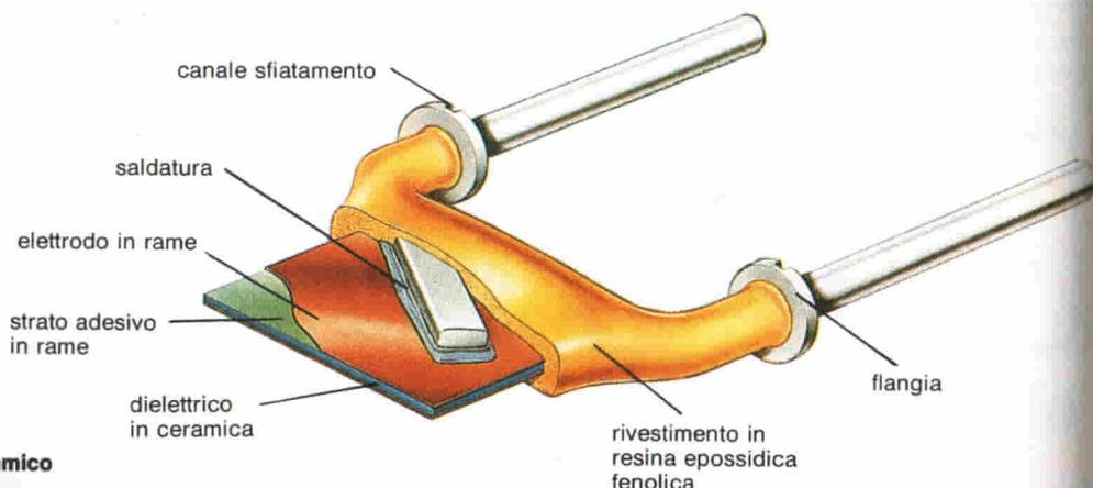
Fig. 1 - Spaccato di un condensatore ceramico piatto miniatura.
