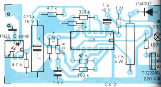
Fig. 7. Disposizione dei componenti sul circuito stampato per pilotare la lampadina. Questo circuito dovrà essere inserito in un astuccio di plastica, e dovranno essere prese tutte le precauzioni necessarie ad evitare scariche elettriche.
