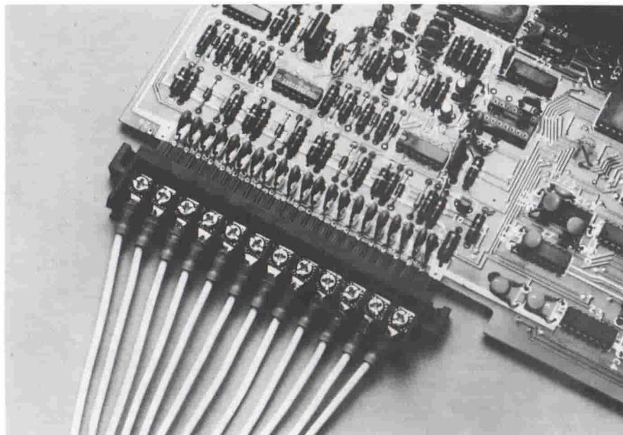
*I nuovi connettori di I/O per CS utilizzano un blocco di terminali del tipo a vite che garantisce una grande affidabilità di collegamenti.*
