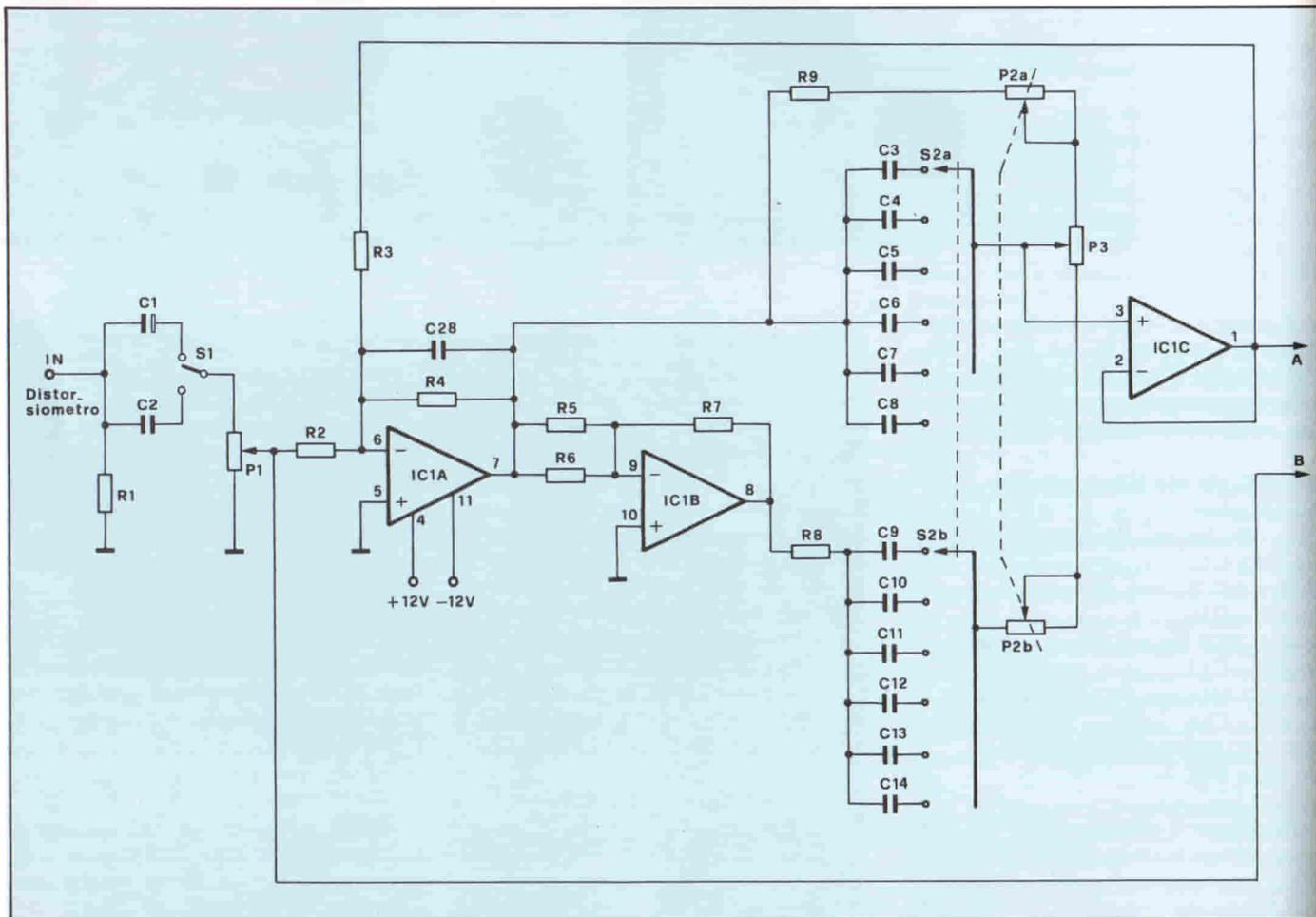
Fig. 1 - Circuito elettrico del filtro arresta-banda del distorsiometro.
