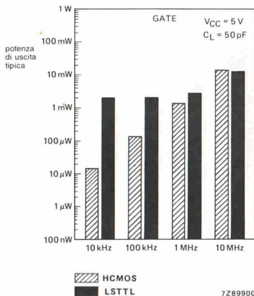
Fig. 4. Valori tipici di dissipazione in una porta in funzione della frequenza. Il grafico in tratteggio si riferisce ai c.i. integrati HCMOS.
