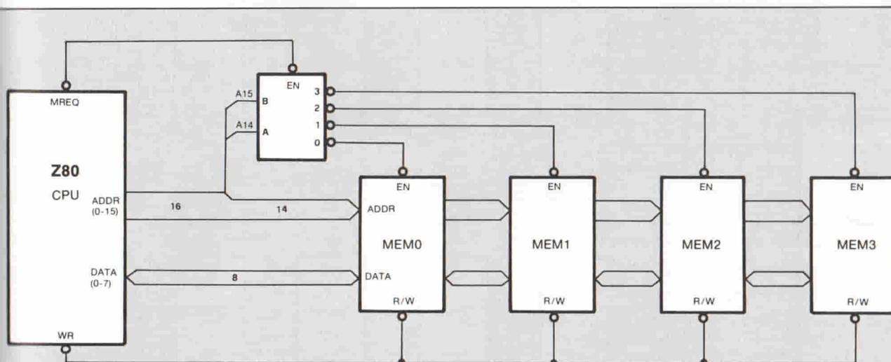
Fig. 1 - Selezione della memoria in un circuito standard da 64 Kbyte; ognuno dei quattro blocchi di memoria ha una capacità pari a 64 Kbyte.
