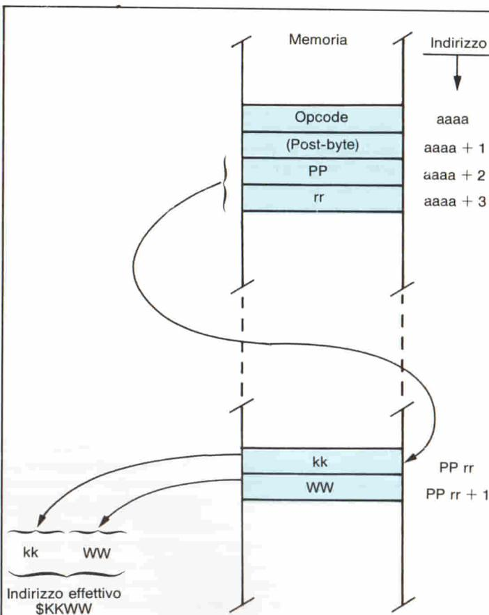
**Fig. 6 -** La figura mostra il meccanismo dell'indirizzamento indiretto. Si noti come l'EA ha un calcolo che richiede un passaggio in più, dato che è a sua volta contenuto in una coppia di celle, la prima delle quali si trova all'indirizzo specificato come operando dell'istruzione. Ovvero: dopo il Codice Operativo viene l'indicazione di un indirizzo, che è l'indirizzo ove NON troveremo il dato, bensì un indirizzo (l'EA) che finalmente punta al dato.
