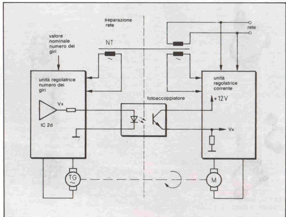
Fig. 7 - Sistema di separazione della tensione della rete basato su un fotoaccoppiatore.
