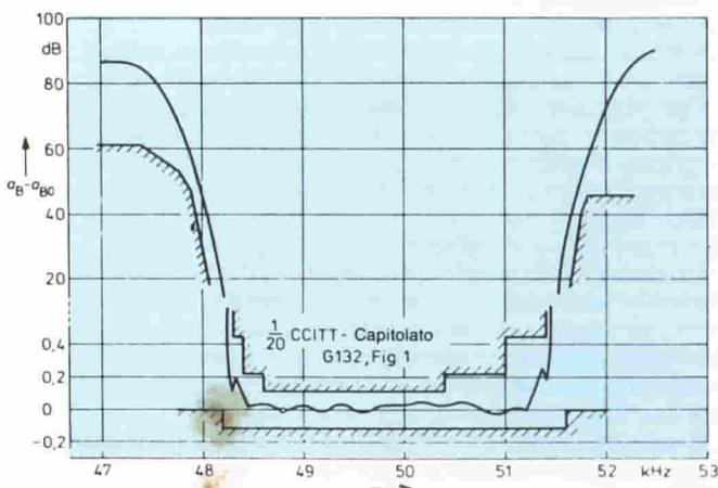
Fig. 11 - Curva passa-banda di un filtro di canale.
