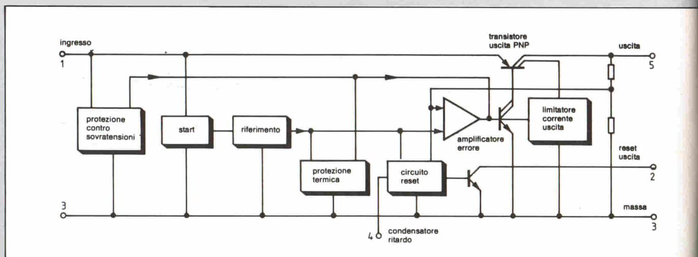
**Fig. 3 - Struttura interna di un regolatore a bassa caduta di tensione tra ingresso e uscita. Il transistore di potenza in serie possiede più terminali collettore uno dei quali viene utilizzato per il sistema di limitazione della corrente. È per questo motivo che si può fare a meno del resistore in serie normalmente usato per "monitorizzare" la corrente d'uscita.**
