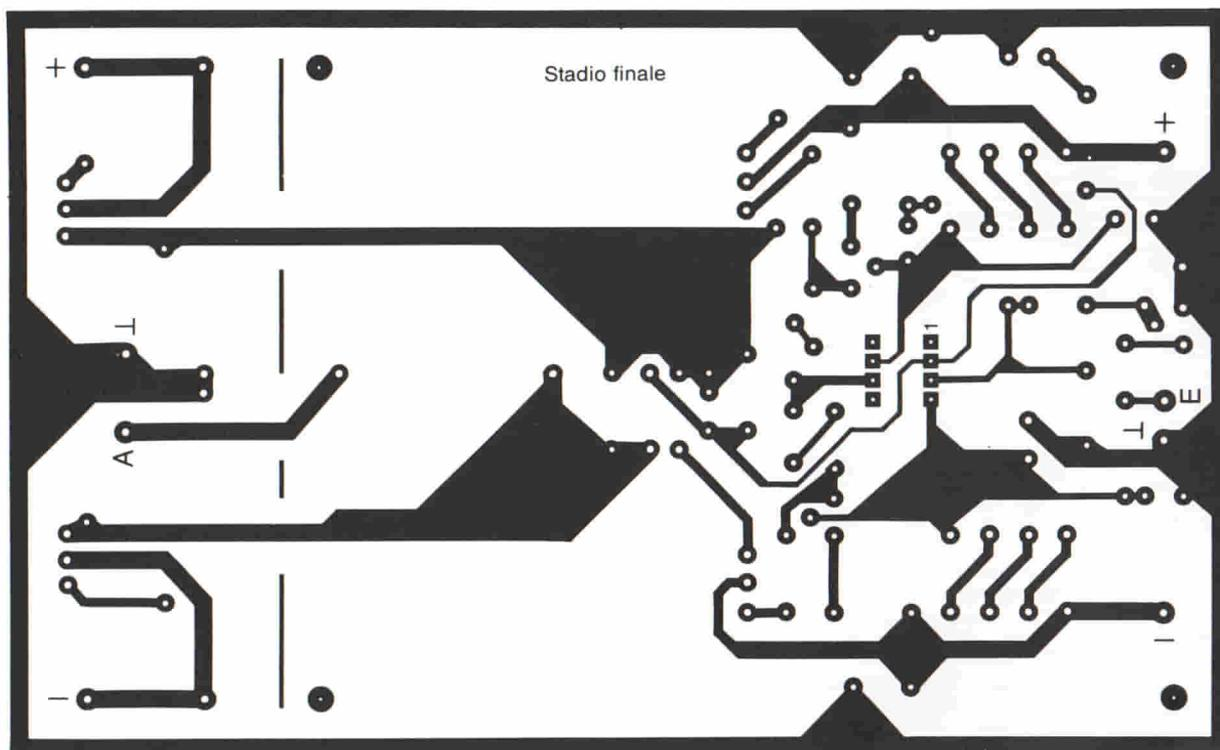
Fig. 2. Piste di rame del circuito stampato. La disposizione dei componenti non è troppo compatta, in modo da poter montare l'amplificatore su un circuito stampato in formato Europa.
