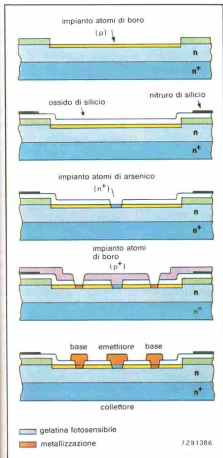
Fig. 2 - Fasi principali della costruzione del chip del transistor BFG 65.
