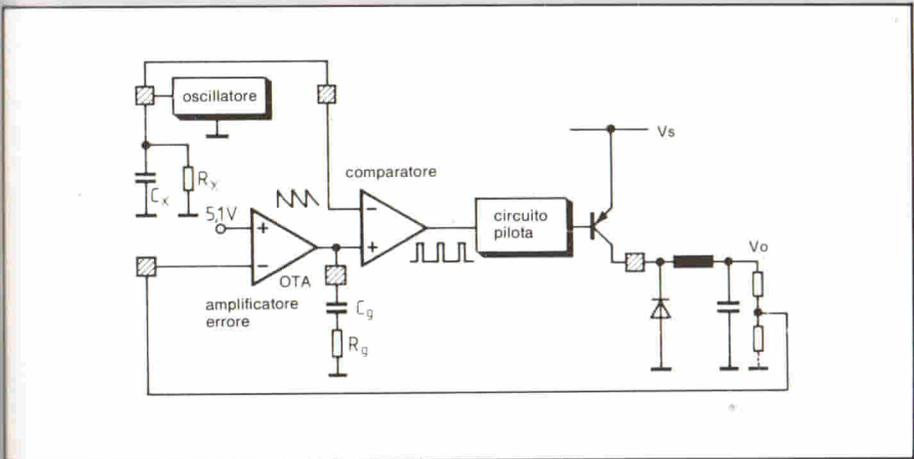
Fig. 8 - Anello di regolazione nel regolatore L 296.
