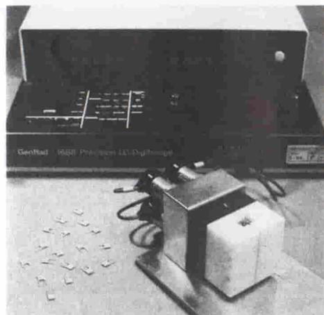
**Controllo delle caratteristiche elettriche (valore della capacità, tg $\delta$  e resistenza di isolamento) effettuato dal Reparto Controllo di qualità.**
