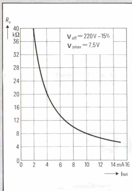
Fig. 2 - Grafico da utilizzare per il dimensionamento del resistore in serie alla rete  $R_v$ .
