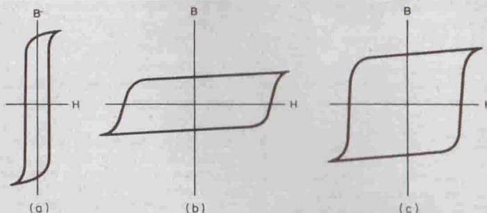
Fig. 2 - Forme tipiche assunte dai cicli di isteresi di alcuni materiali. In (a) occorre una debole forza coercitiva per neutralizzare un elevato valore di magnetismo residuo. In (b) occorre una elevata forza coercitiva per eliminare un basso valore di magnetismo residuo. È il ciclo tipico dei magneti permanenti. In (c) occorre una forza coercitiva elevata per neutralizzare un elevato valore di magnetismo residuo. Anche questo è un ciclo di isteresi tipico di altri magneti permanenti.
