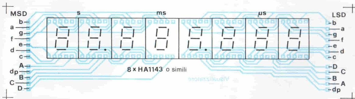
Fig. 6. Disposizione dei componenti sul circuito stampato del display: il collegamento con la basetta principale avverrà mediante piattina multipolare.
