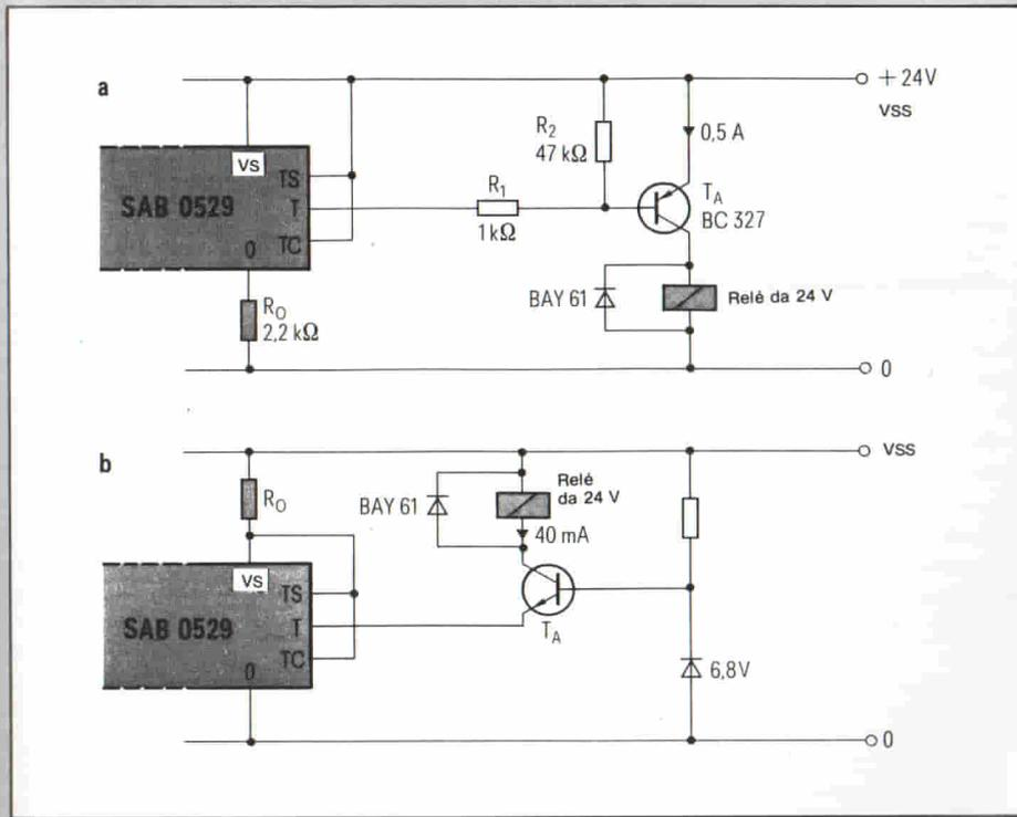
Fig. 12 - Timer per tempi lunghi dove per il comando del relè viene utilizzato un transistorore bipolare.
