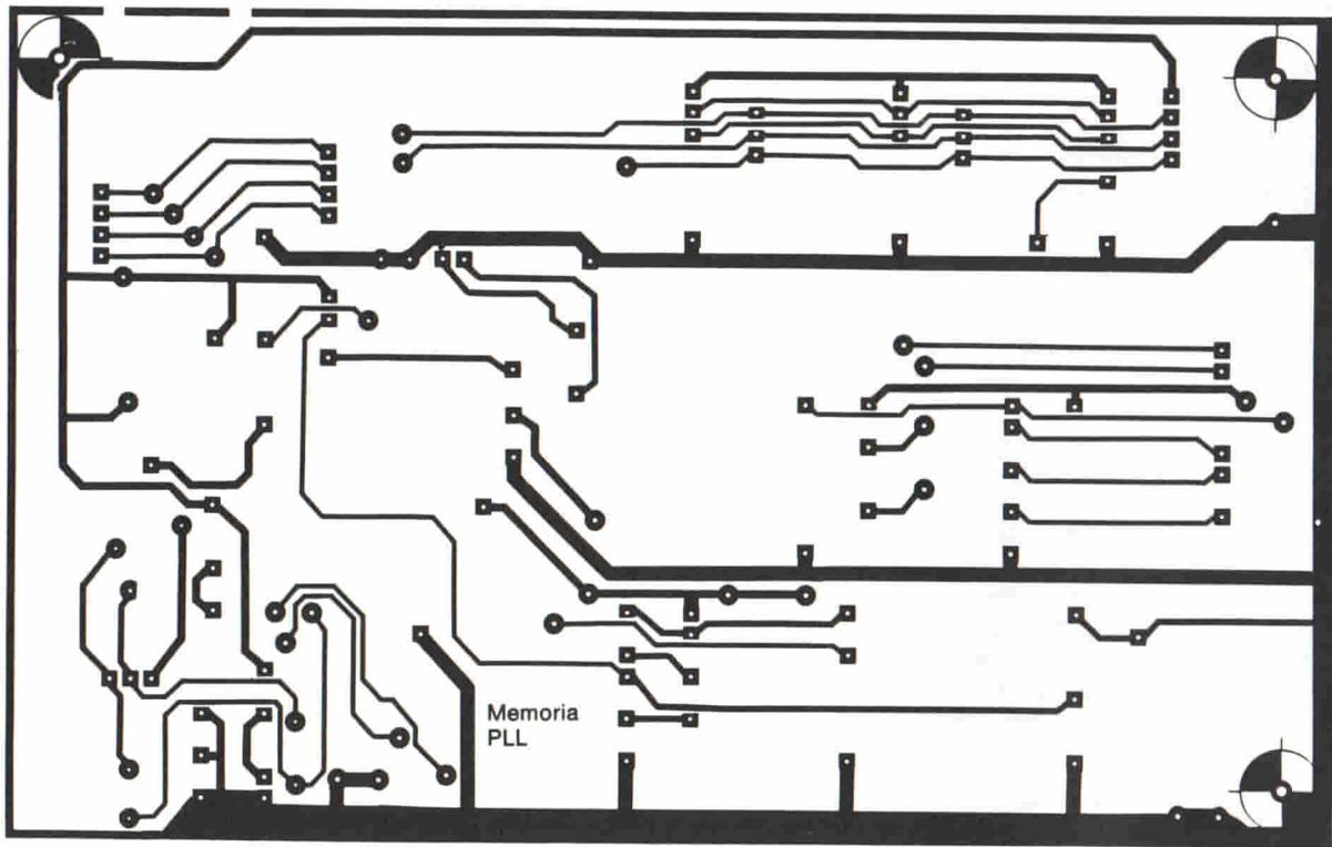
Fig. 5 - Piste di rame sul lato componenti.
