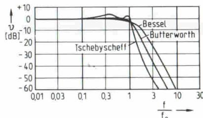
Fig. 2. Esempi di caratteristiche di diversi filtri.
