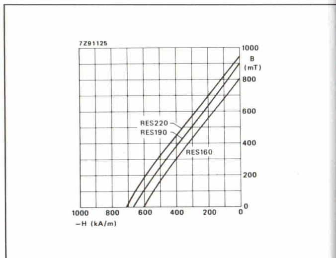
**Fig. 1 - Andamento delle caratteristiche B-H nel secondo quadrante del ciclo di isteresi di alcune gradazioni di magneti permanenti al cobalto e alle terre rare. Il secondo quadrante del ciclo di isteresi si riferisce alla forza di smagnetizzazione ( $-H$ ) che occorre applicare al materiale magnetizzato affinché esso perda completamente la primitiva magnetizzazione. È chiamato appunto il quadrante della smagnetizzazione.**
