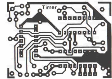
Fig. 2. Piste di rame del circuito stampato. L'altezza della basetta è pressochè uguale a quella di una mini-batteria da 9 V completa di clip.
