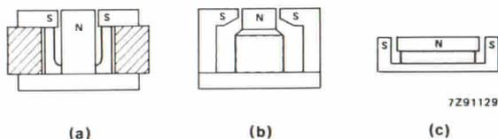
Fig. 4 - Dimensioni relative di alcuni sistemi magnetici per altoparlanti realizzati in (a) con magneti permanenti ceramici (Ferroxdure) FXD 330; in (b) con magneti a base di leghe Ticonal 550; in (c) con magneti permanenti al cobalto e alle terre rare (RES). L'ultimo sistema magnetico (c), non soltanto possiede dimensioni più ridotte ma permette di schermare meglio il campo magnetico prodotto dal RES, per cui risulterà particolarmente adatto ad essere impiegato in apparecchiature miniaturate.
