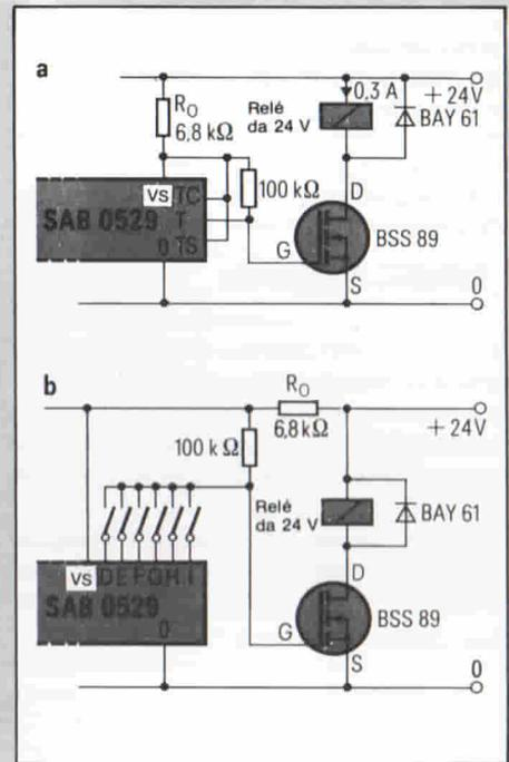
Fig. 13 - Timer per tempi lunghi dove per il comando del relè viene utilizzato un transistorore FET/MOS (SIPMOS). a = T utilizzato come uscita; terminali da D a I, utilizzati come uscita.
