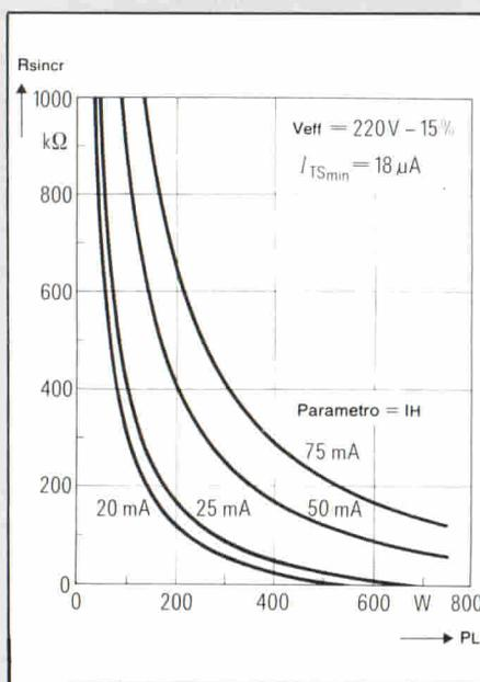
Fig. 10 - Resistore di sincronizzazione R<sub>sincr.</sub> in funzione del carico PL con la corrente di mantenimento I<sub>H</sub> data come parametro.
