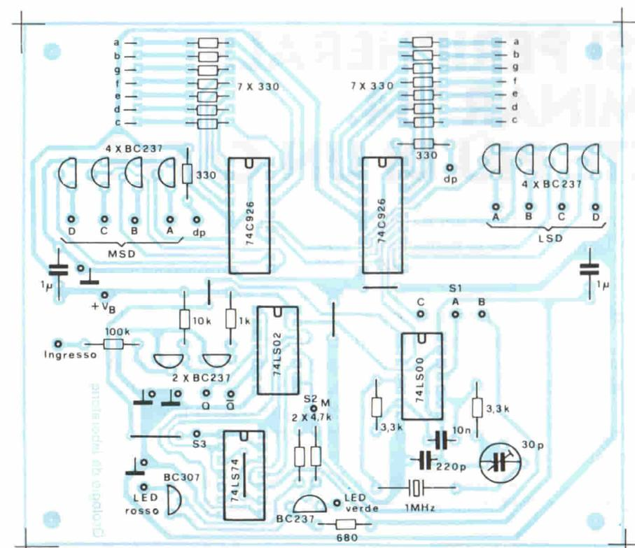
Fig. 5. Disposizione dei componenti sul circuito stampato principale. Allo scopo di permettere eventuali modifiche delle frequenze di clock, il quarzo dovrà essere montato su uno zoccolo.
