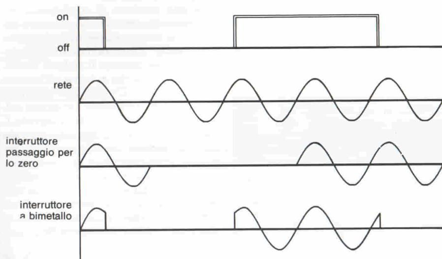
Fig. 1 - Illustrazione del concetto di interruzione della tensione di rete in corrispondenza del suo passaggio per lo zero. Partendo dall'alto: indicazione dell'interruttore; tensione alternata della rete; azione sulla tensione della rete di un interruttore che interrompe (o chiude) il circuito in corrispondenza del passaggio per lo zero della tensione della rete; azione sulla stessa tensione di rete di un interruttore a bimetallo.
