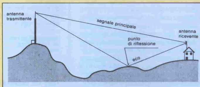
**Fig. 7 - Schematizzazione della formazione dell'effetto eco.**
