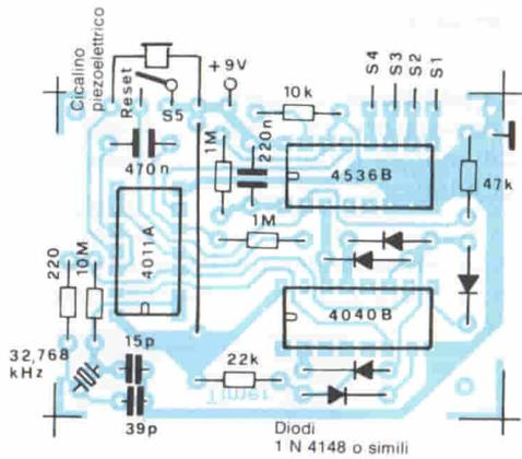
Fig. 3. Disposizione dei componenti. La porta logica dovrà essere del tipo 4011A, che permette di far funzionare stabilmente l'oscillatore quarzato.
