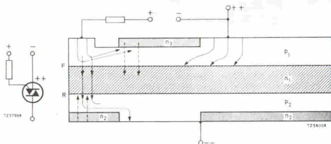
Fig. 9 - Le polarità delle tensioni applicate agli elettrodi principali sono qui cambiate (siamo infatti nel III° quadrante). Il triac s'innescò con un impulso positivo sul gate (+, -).
