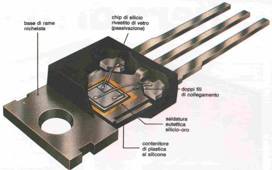
**Fig. 5 - Spaccato di un triac di media potenza. Il contenitore è di plastica (TO-220). Il chip è rivestito di vetro (passivazione).**
