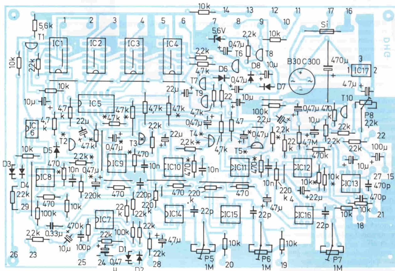
Fig. 5. Disposizione dei componenti sul circuito stampato principale. A causa del montaggio compatto le saldature dovranno essere eseguite con particolare attenzione.
