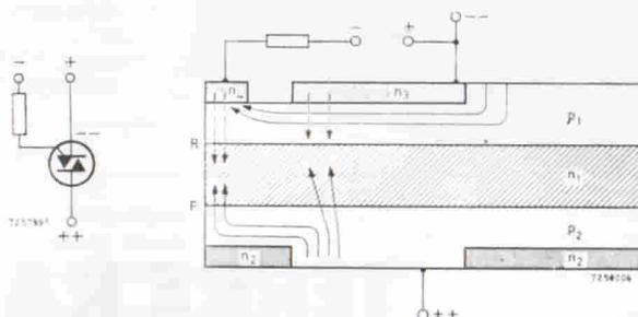
Fig. 8 - Condizioni identiche a quelle di fig. 7 per ciò che riguarda la polarità delle tensioni applicate agli elettrodi principali. Il triac entra in conduzione anche con un impulso negativo sul gate (-, +).
