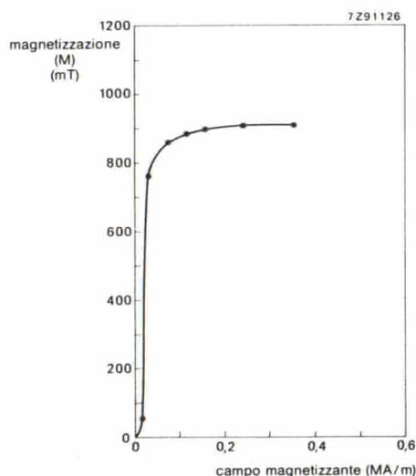
Fig. 2 - Curva di magnetizzazione iniziale (1° quadrante del ciclo di isteresi) in un magnete RES 190 smagnetizzato in precedenza per via termica. Il materiale raggiunge la saturazione magnetica già con bassi valori del campo magnetizzante.
