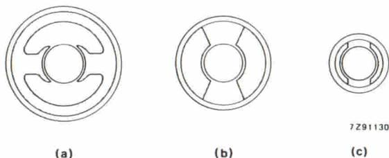
Fig. 3 - Sezione di motori con armatura (indotto) dello stesso diametro e con identici valori della caratteristica velocità-coppia. In (a), lo statore è formato da un avvolgimento; in (b) da magneti permanenti ceramici (Ferroxdure), in (c) da magneti permanenti RES. Si notino, a parità di prestazioni, le dimensioni via via decrescenti assunte dal motore.
