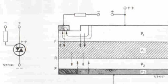
Fig. 10 - Condizioni delle tensioni agli elettrodi principali identiche a quelle della figura 9. Il triac viene innescò anche con un segnale negativo sul gate (-, +).
