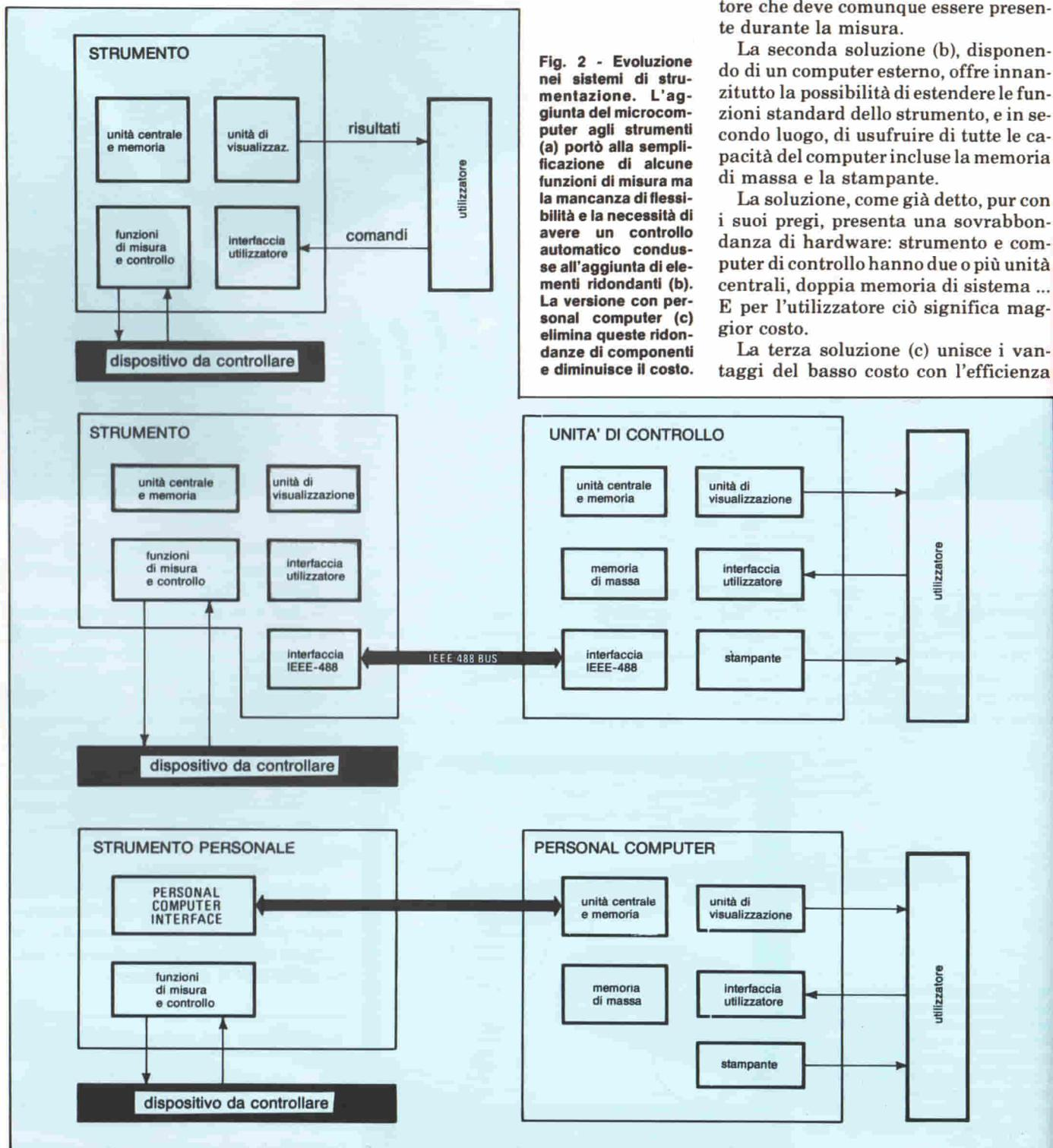
Fig. 2 - Evoluzione nei sistemi di strumentazione. L'aggiunta del microcomputer agli strumenti (a) portò alla semplificazione di alcune funzioni di misura ma la mancanza di flessibilità e la necessità di avere un controllo automatico condusse all'aggiunta di elementi ridondanti (b). La versione con personal computer (c) elimina queste ridondanze di componenti e diminuisce il costo.
