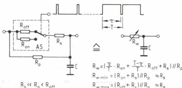
Fig. 3. Schema di un filtro costruito con il sistema a commutatore.
