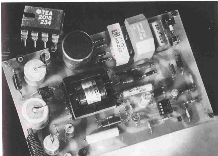
Circuito di controllo TEA2018 fornito in package DIL plastico ad 8 pin.
