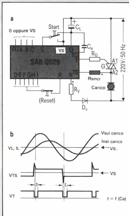
Fig. 9 - Sistema di sincronizzazione mediante corrente. a = circuito previsto nel caso di carichi induttivi, capacitivi e ohmici; b = forme d'onda caratteristiche di questo circuito (C<sub>e</sub> collegato a TC).
