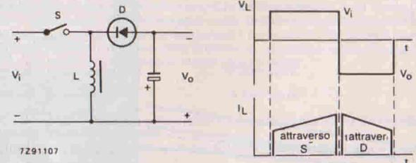
Fig. 2 - Schema semplificato di convertitore cc/cc forward. S = transistoro-interruttore. L = induttore.
