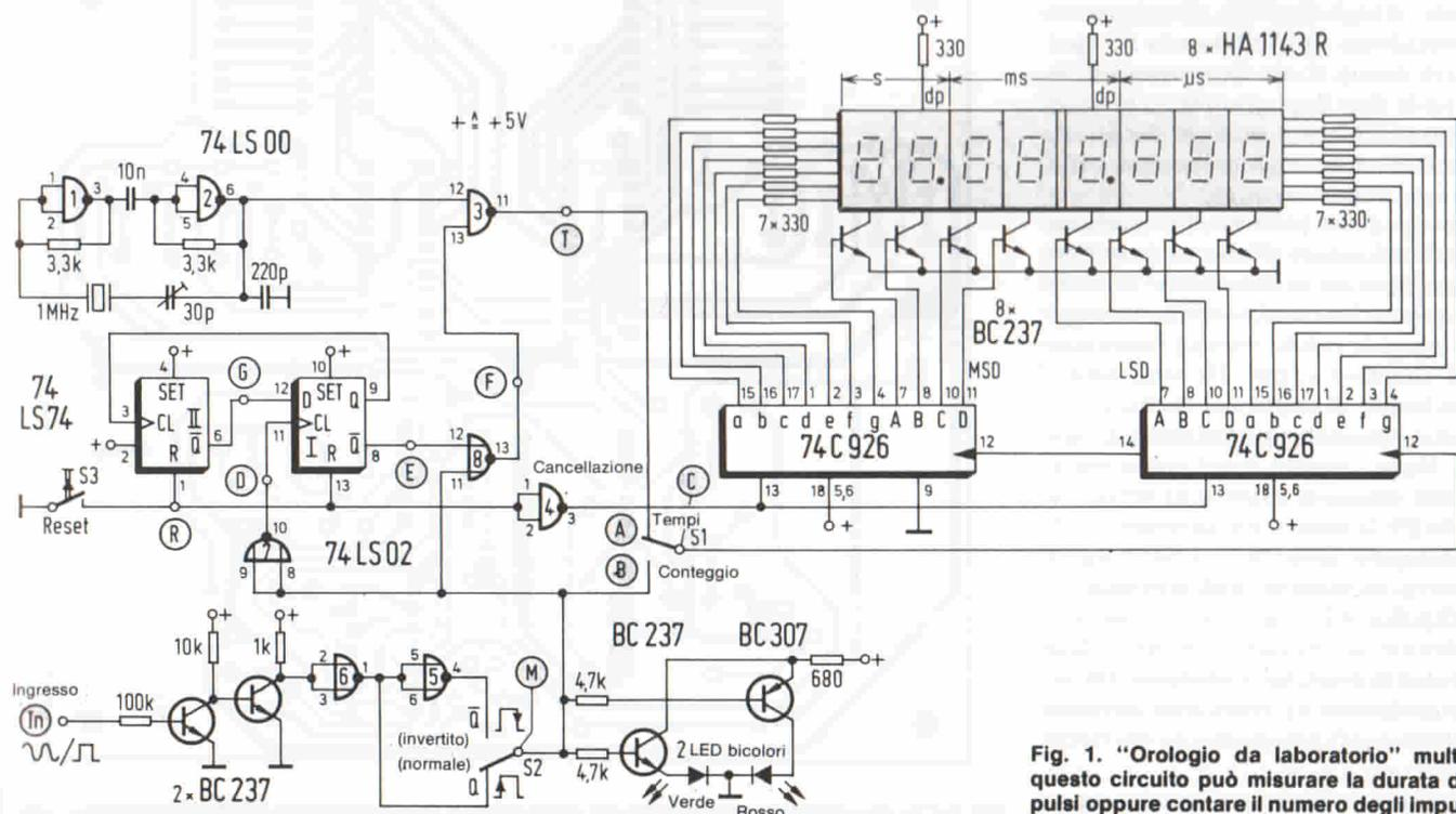
Fig. 1. "Orologio da laboratorio" multiuso: questo circuito può misurare la durata di impulsi oppure contare il numero degli impulsi in un intervallo di tempo.
