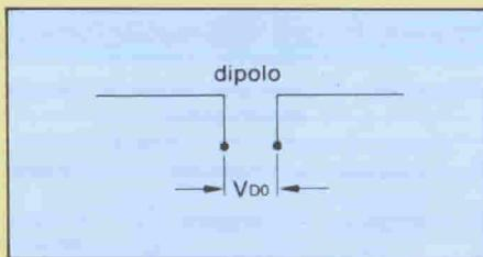
Fig. 4 - Schematizzazione di un dipolo semplice non collegato al carico (e cioè all'ingresso del ricevitore).
