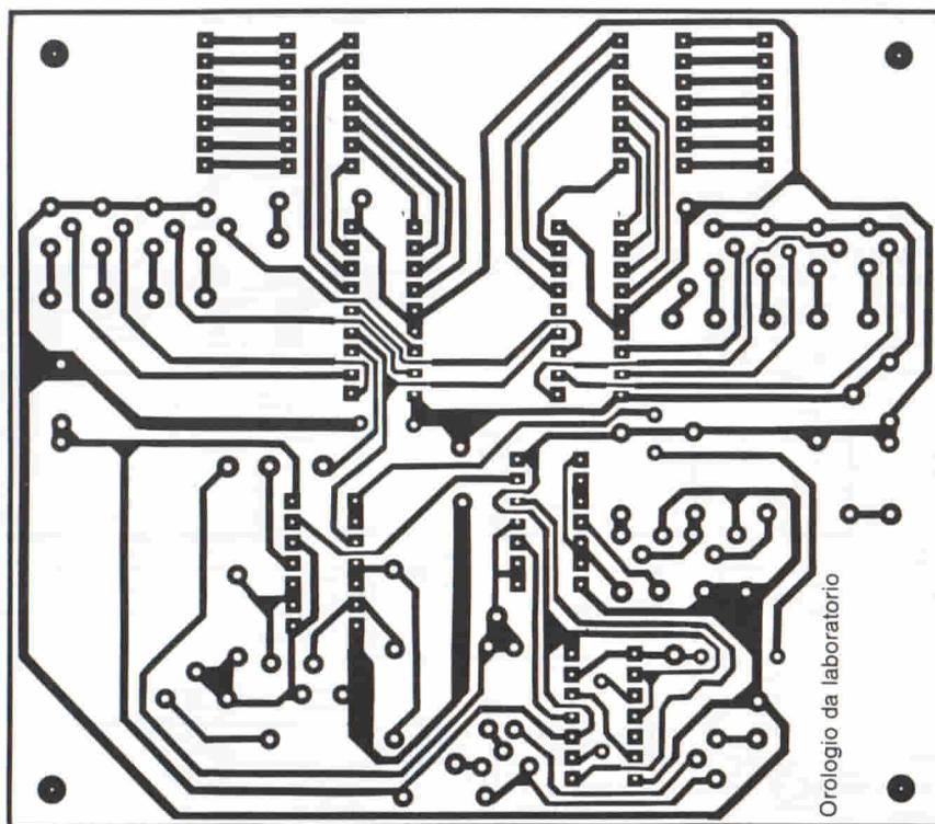
Fig. 3. Circuito stampato per la sezione di pilotaggio: su di esso verranno montati tutti i componenti, fatta eccezione per il visualizzatore.
