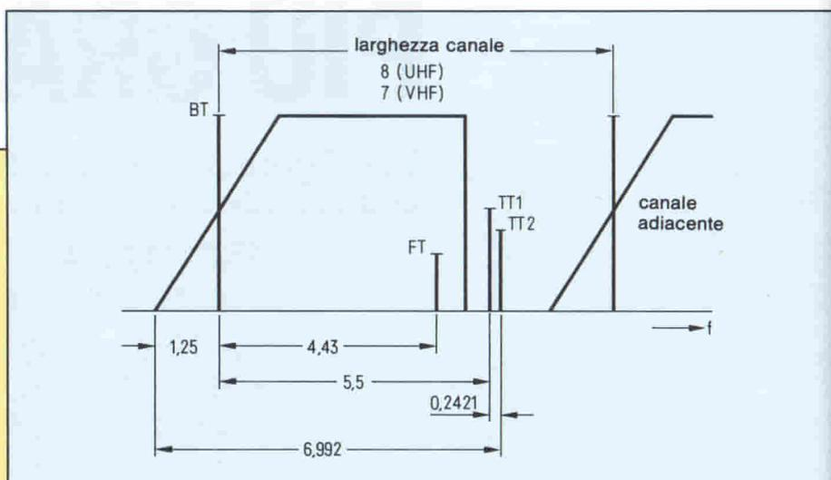
Fig. 1 - Struttura di un canale TV.
