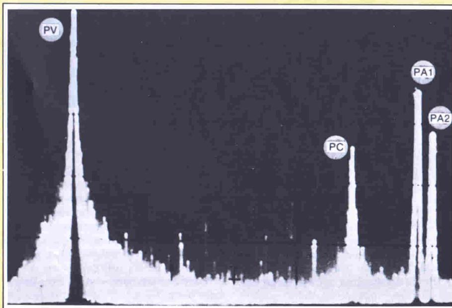
**Fig. 2 - Struttura di un canale TV, come quella schematizzata in figura 1, osservata sullo schermo di un analizzatore di spettro.**
