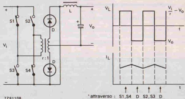
Fig. 4 - Schema semplificato di convertitore cc/cc push-pull.
