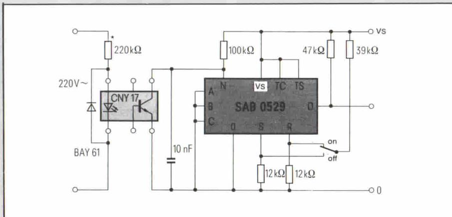
Fig. 16 - Timer per tempi lunghi azionato mediante fotoaccoppiatore.
