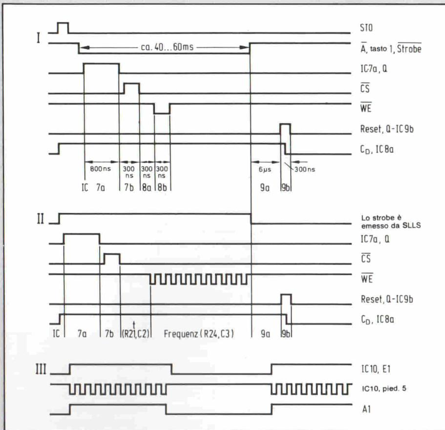
Fig. 3 - Diagramma degli impulsi; I) scrittura dei dati; II) funzionamento con contatore avanti/indietro; III) inversione dell'informazione d'uscita ed eliminazione delle frequenze di disturbo.
