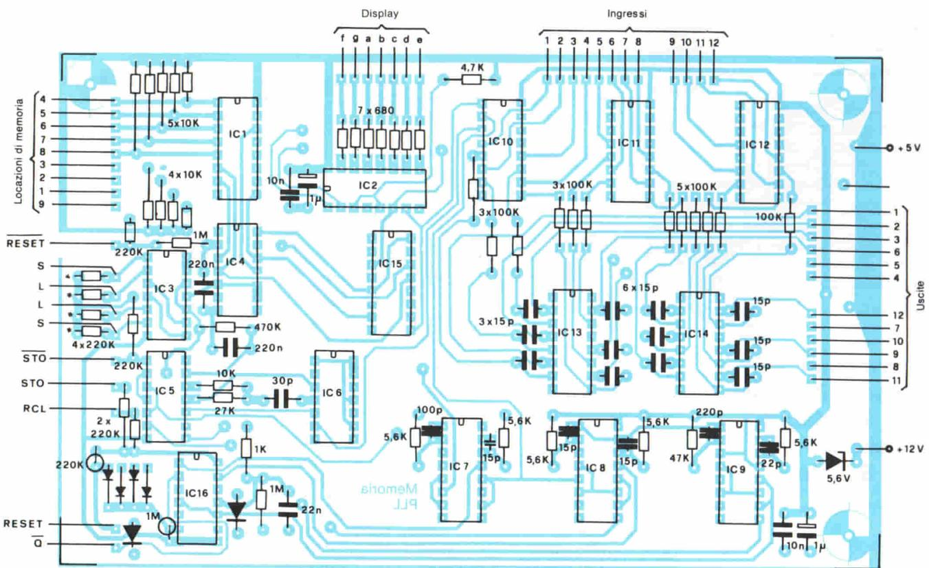
Fig. 6 - Disposizione dei componenti sul circuito stampato del memorizzatore di stazioni. I resistori contrassegnati da un asterisco sono già montati nel contatore avanti/indietro.
