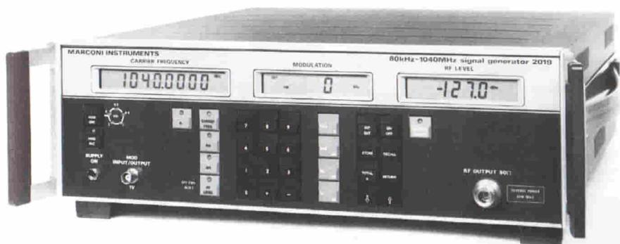
Generatore di segnali 10 kHz ÷ 1040 MHz della Marconi Instruments.
