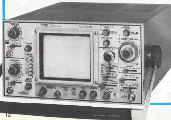
Oscilloscopio CS-1040, a 3 canali e a 6 tracce, con larghezza di banda di 40 MHz e sensibilità di 1 mV/div.
