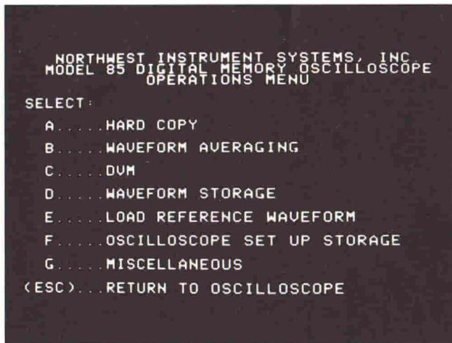
Fig. 3 - Per predisporre e controllare uno strumento "personal", le funzioni più comuni sono memorizzate su dischetti ed organizzate come un semplice "menu". Le funzioni del "menu" possono essere richiamate con la semplice pressione di un singolo testo.
