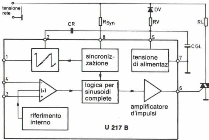
Fig. 3 - Funzioni contenute nel c.i. U 217 B.
