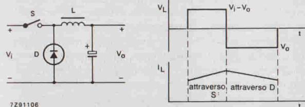
Fig. 3 - Schema semplificato di convertitore cc/cc fly-back.
