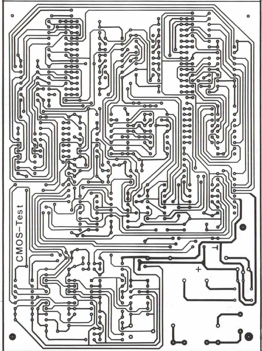
Fig. 7. Piste di rame del circuito stampato. Le dimensioni della basetta sono adattate al contenitore Teko 363. Lo spazio libero potrà essere utilizzato per montare uno stabilizzatore di tensione.
