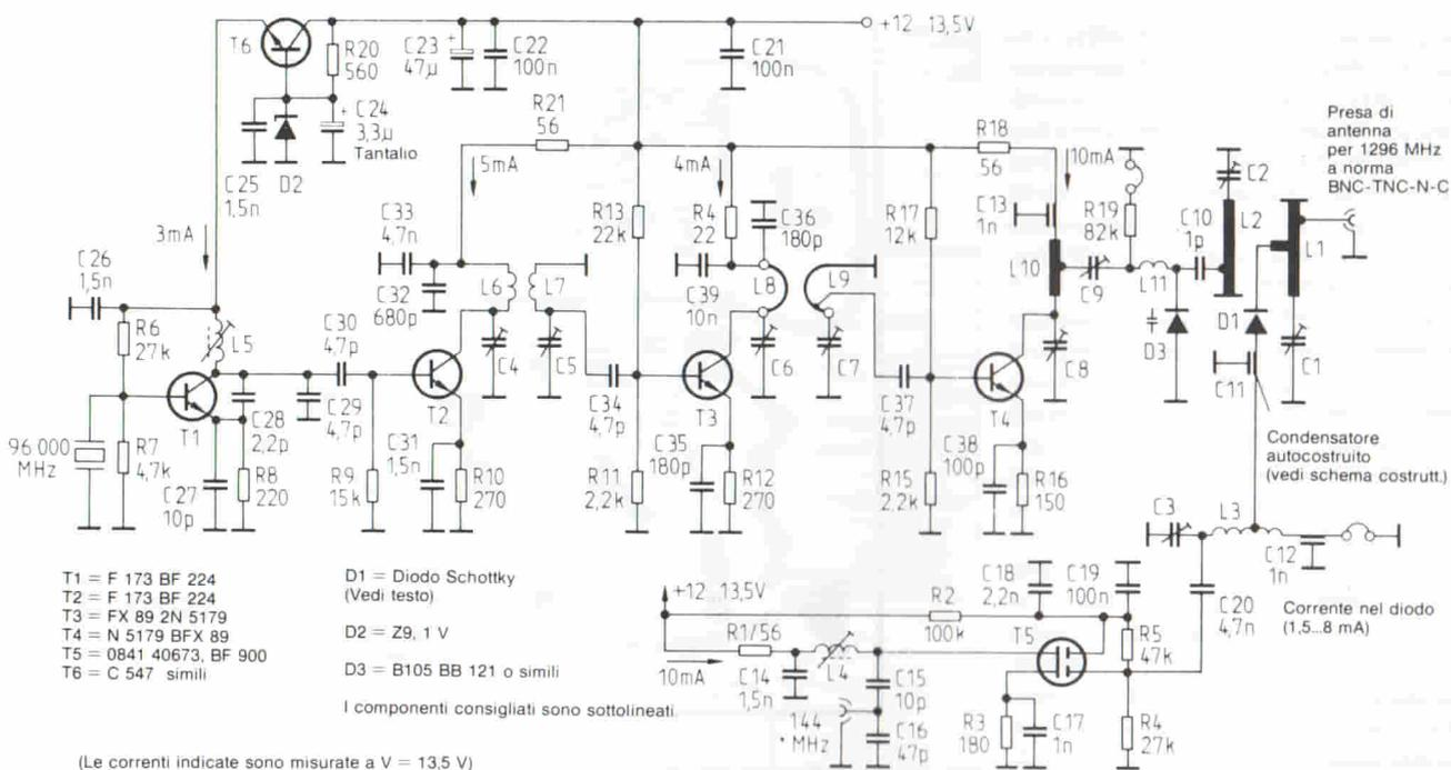
Fig. 2. Schema completo del convertitore.
