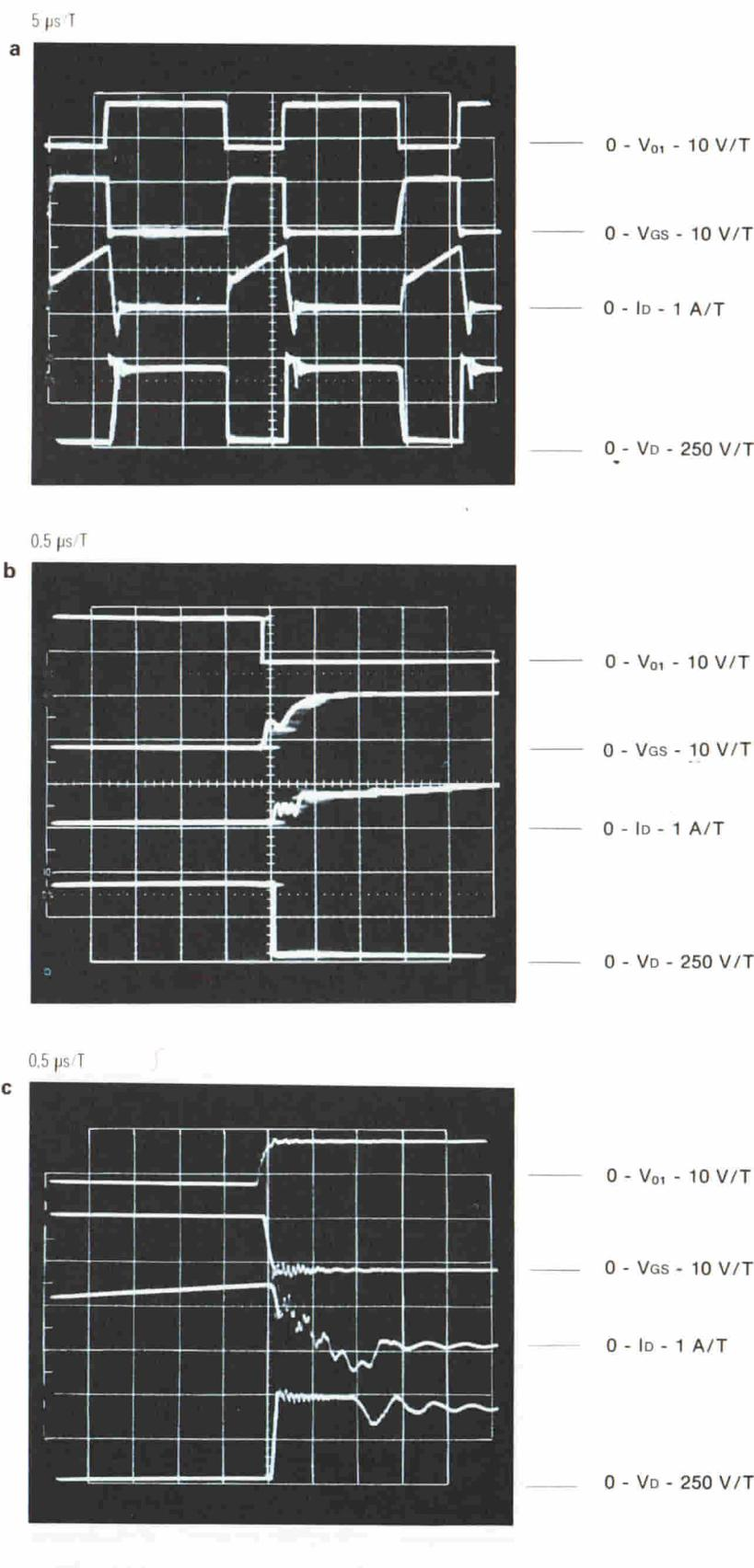
**Fig. 3 -** (a) Andamento del segnale di pilotaggio del transistore-interruttore, e delle relative correnti e tensioni a cui esso dà luogo. Nelle figure 3b e 3c, gli oscillogrammi sono stati espansi per evidenziare il loro reale andamento al momento in cui il transistore-interruttore viene portato in conduzione (in b), e nel momento in cui viene bloccato (in c).
