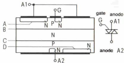
**Fig. 3 - Struttura completa del triac e relativo simbolo.**
