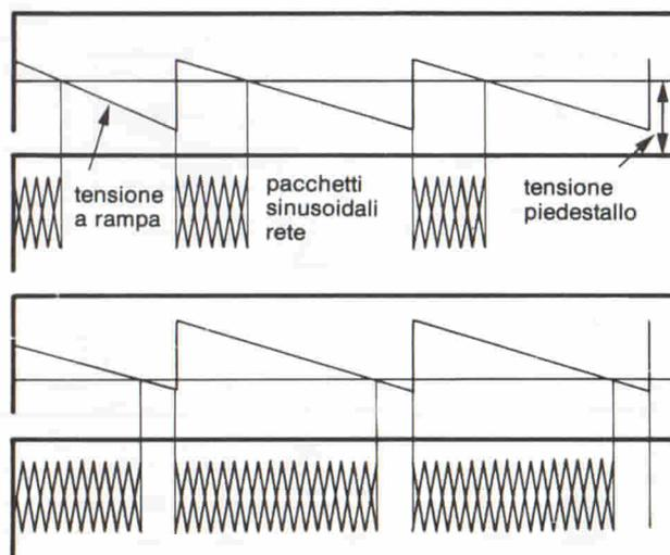
Fig. 2 - Illustrazione del concetto di controllo proporzionale nel tempo. In questo caso, nel carico vengono immessi pacchetti più o meno lunghi di onde sinusoidali della tensione della rete. È il particolare punto d'incrocio della tensione detta di piedestallo con il dente di sega (o tensione a rampa) che determina la lunghezza del treno di sinusoidi della tensione di rete immesse nel carico.
