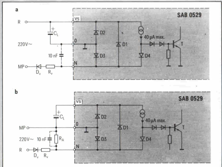
Fig. 14 - Struttura dei circuiti interni relativi all'ingresso N. a = base dei tempi ottenuta con R (fase) applicata a  $V_S$ . b = base dei tempi ottenuta con MP (neutro o terra) collegato alla massa del timer.
