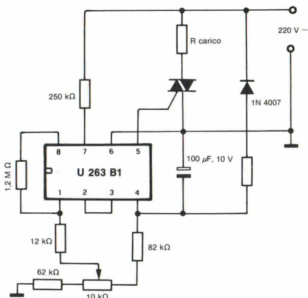
**Fig. 5 - Esempio di applicazione del c.i. U 263 B1. Anche questo è un controllo di temperatura a due punti nel quale ad un certo punto (e precisamente quando ci si avvicina al valore di temperatura desiderata) entra in funzione il sistema di controllo proporzionale. Il sensore in questo caso è incorporato nel chip dell'integrato. (Schema originale AEG-Telefunken).**
