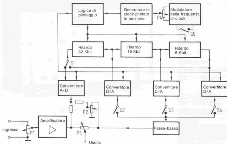
Fig. 1. Schema a blocchi dell'apparecchio digitale per eco.
