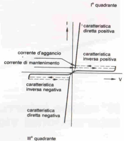
**Fig. 6 - Curve caratteristiche del triac. Il triac lavora esclusivamente nel I° e nel III° quadrante. In entrambi i quadranti, fino alla tensione di breakover, il triac si comporta come un diodo polarizzato in senso inverso (caratteristica inversa, positiva o negativa). Superata la tensione di breakover, il triac conduce fortemente in entrambi i quadranti (caratteristica diretta, positiva o negativa).**
