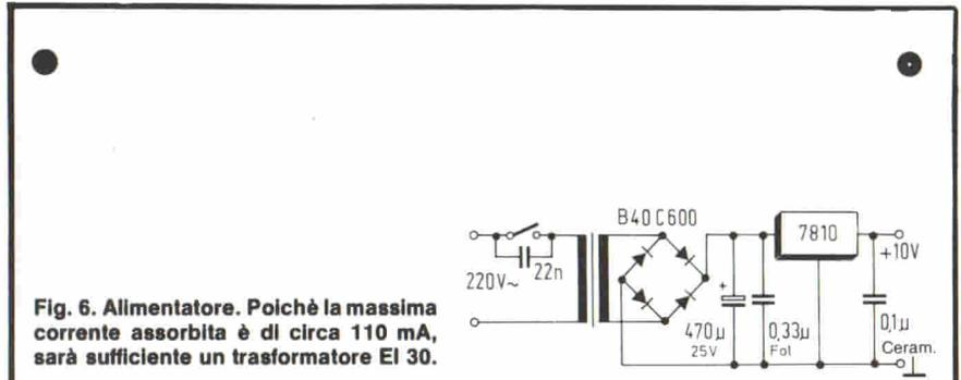
Fig. 6. Alimentatore. Poiché la massima corrente assorbita è di circa 110 mA, sarà sufficiente un trasformatore EI 30.
