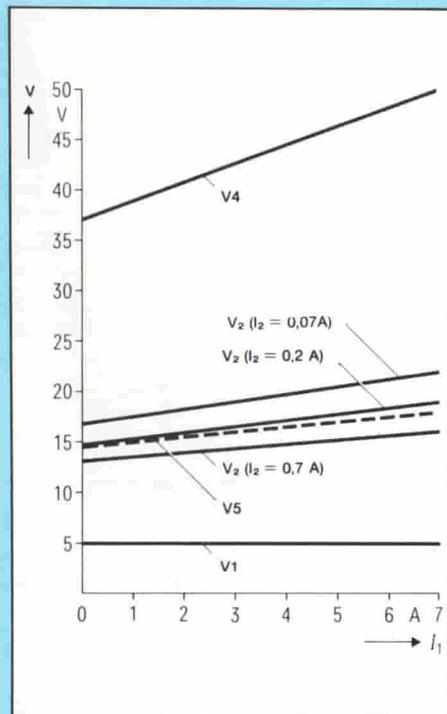
Fig. 4 - Andamento delle tensioni di uscita in funzione della corrente di uscita I1 (l'andamento delle tensioni V2, V3, V4 e V5 si riferisce ai valori di corrente indicati). Si noti come soltanto la tensione di uscita V1 risulti perfettamente stabilizzata fino ad una corrente di carico di 7 A.
