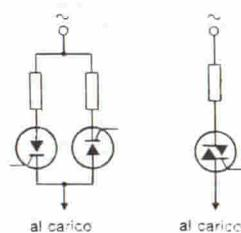
Fig. 1 - Il funzionamento del triac corrisponde a due tiristori collegati in antiparallelo.
