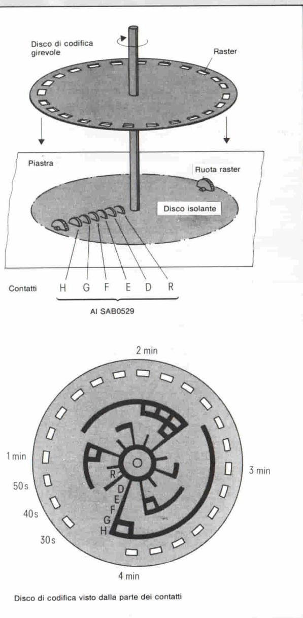
Fig. 6 - Esempio di interruttore di codifica realizzato su piastra di circuito stampato.
