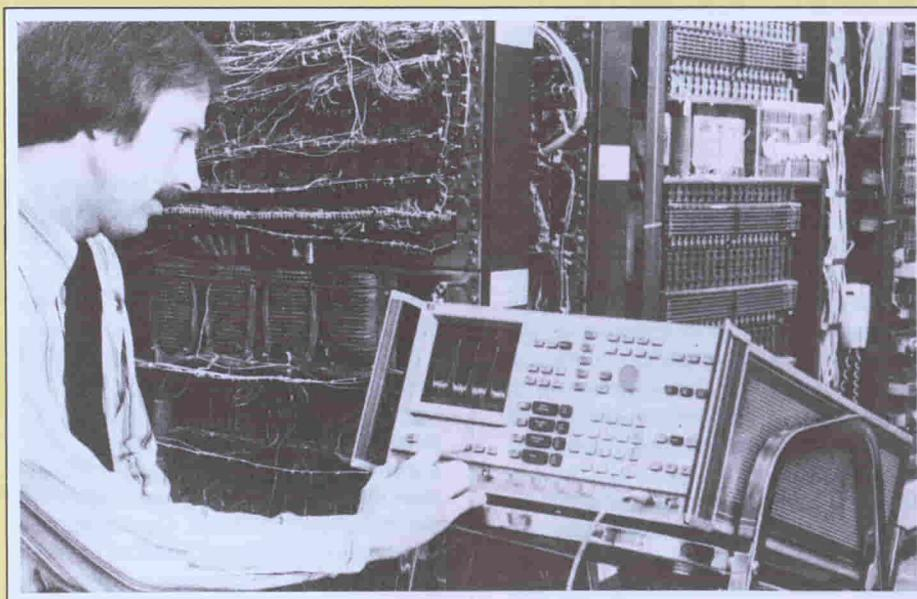
**Esame dello spettro di un segnale VHF/UHF.** (Foto Hewlett-Packard).
