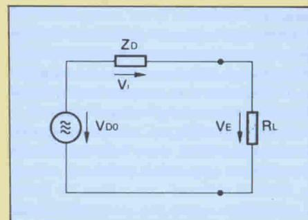
Fig. 6 - Circuito equivalente di un dipolo collegato all'ingresso di un televisore ( $R_L$ ).
