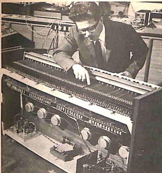
Fig. 3 - Vista interna del pianoforte elettronico.
