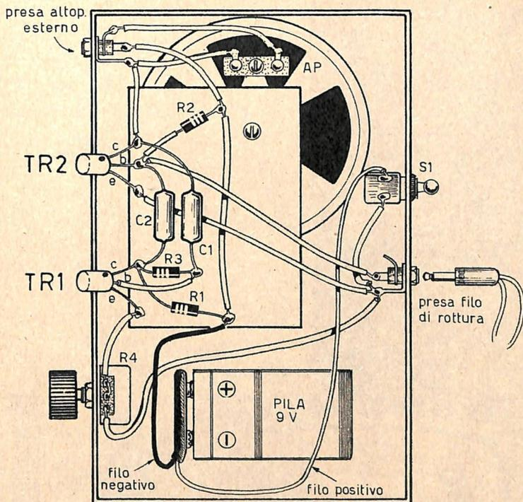
**Fig. 4 - Piano di cablaggio della sirena antifurto interamente montata in un contenitore di plastica. Si noti la presenza del comando di sensibilità rappresentato dal potenziometro R4.**
