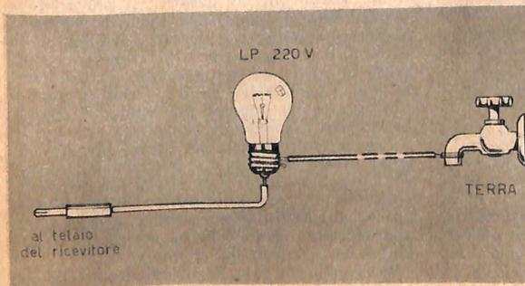
Fig. 5 - Per il corretto funzionamento del microfono magnetico occorre far in modo che sul telaio metallico dell'apparecchio radio non sia presente la tensione di rete. Il controllo si effettua collegando una lampadina di basso wattaggio fra la tubatura dell'acqua e il telaio del ricevitore.
