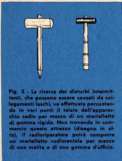
**Fig. 3 -** La ricerca dei disturbi intermittenti, che possono essere causati da collegamenti laschi, va effettuata percuotendo in vari punti del telaio dell'apparecchio radio per mezzo di un martelletto di gomma rigida. Non trovando in commercio questo attrezzo (disegno in alto), il radioriparatore potrà comporre un martelletto rudimentale per mezzo di una matita e di una gomma d'ufficio.
