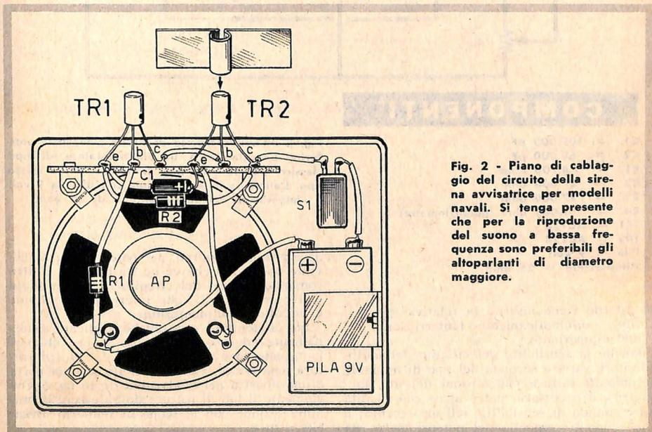
Fig. 2 - Piano di cablaggio del circuito della sirena avvisatrice per modelli navali. Si tenga presente che per la riproduzione del suono a bassa frequenza sono preferibili gli altoparlanti di diametro maggiore.
