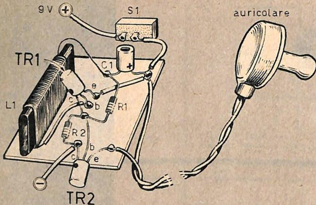
Fig. 4 - Il piccolo apparato ricevente, composto dalla bobina di ricezione e dal semplice amplificatore a transistor, verrà inserito in un piccolo contenitore di materiale isolante da conservare nel taschino della giacca.
