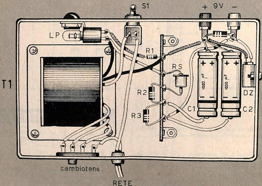
Fig. 2 - Piano di cablaggio dell'alimentatore stabilizzato per mezzo dell'impiego di un diodo zener.
