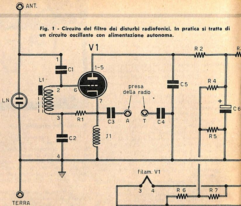
Fig. 1 - Circuito del filtro dei disturbi radiofonici. In pratica si tratta di un circuito oscillante con alimentazione autonoma.
