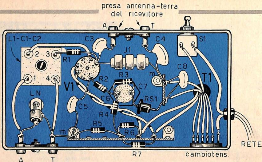
Fig. 2 - Piano di cablaggio del circuito trappola osservato nella parte di sotto del telaio metallico.
