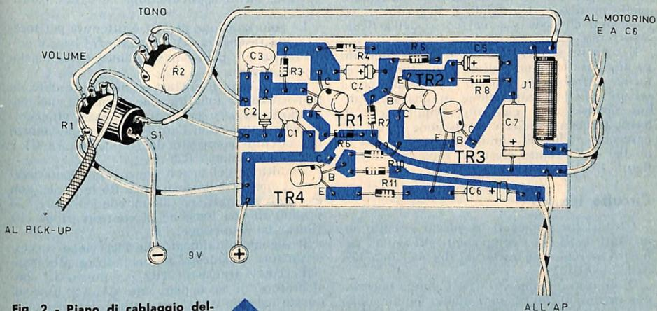
Fig. 2 - Piano di cablaggio dell'amplificatore di bassa frequenza realizzato su circuito stampato. Si tenga presente che le piste di rame sono viste in trasparenza.
