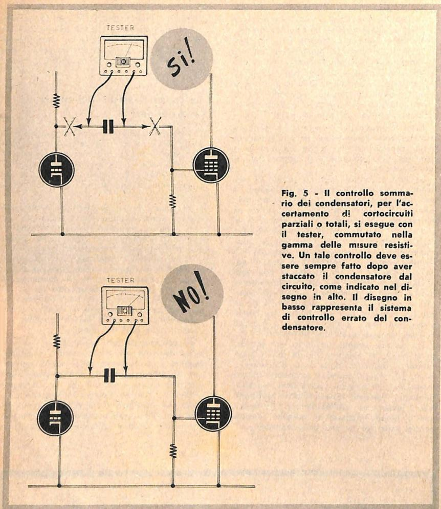
Fig. 5 - Il controllo sommario dei condensatori, per l'accertamento di cortocircuiti parziali o totali, si esegue con il tester, commutato nella gamma delle misure resistive. Un tale controllo deve essere sempre fatto dopo aver staccato il condensatore dal circuito, come indicato nel disegno in alto. Il disegno in basso rappresenta il sistema di controllo errato del condensatore.
