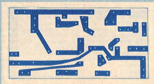
Fig. 3 - Circuito stampato visto dal lato delle piste di rame.
