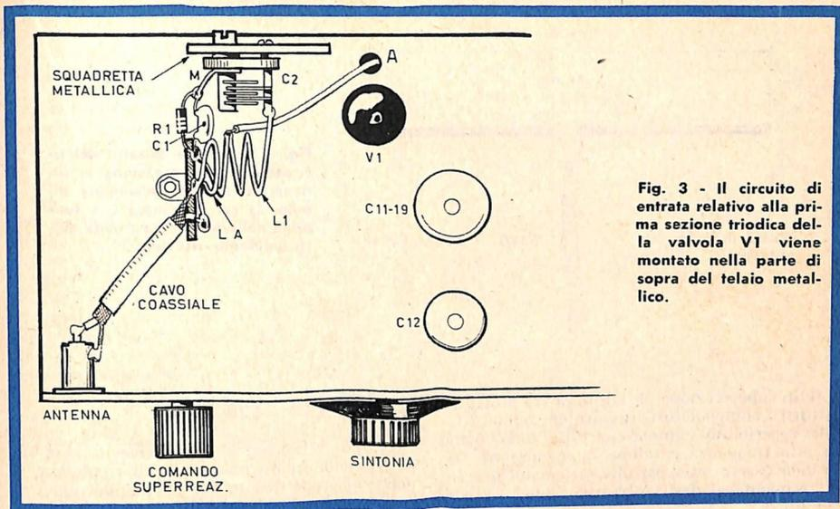
Fig. 3 - Il circuito di entrata relativo alla prima sezione triodica della valvola V1 viene montato nella parte di sopra del telaio metallico.
