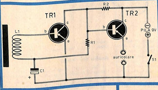
Fig. 3 - Il primo circuito di amplificatore è concepito per il collegamento con un auricolare ad alta impedenza; il secondo circuito di amplificatore, quello a due transistor, è concepito per l'ascolto in auricolare a bassa impedenza.
