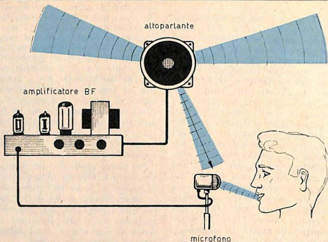
**Fig. 6 - In questo disegno risulta interpretato chiaramente il famoso effetto Larsen. I suoni provenienti dall'altoparlante vengono captati dal microfono ed amplificati, in una sequenza di successivi processi di amplificazione, fino alla creazione di un vero e proprio urlo.**
