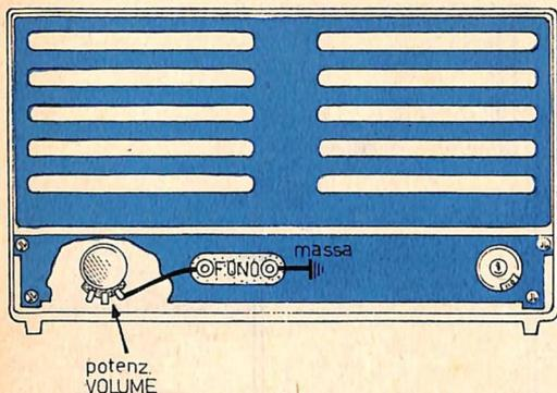
Fig. 1 - In ogni apparecchio radio una delle due boccole della presa-fono è collegata con il telaio metallico dell'apparecchio radio; l'altra boccola è collegata con uno dei terminali estremi del potenziometro di volume.
