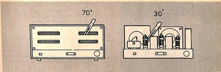
**Fig. 2 - Un eccesso di temperatura, all'interno del ricevitore radio, può essere causa di disturbi e rumorosità. Ogni radio riparatore scrupoloso fa sempre bene a rilevare la temperatura interna dell'apparecchio radio a valvole introducendo in esso un termometro nel modo indicato nei disegni qui sopra riportati.**
