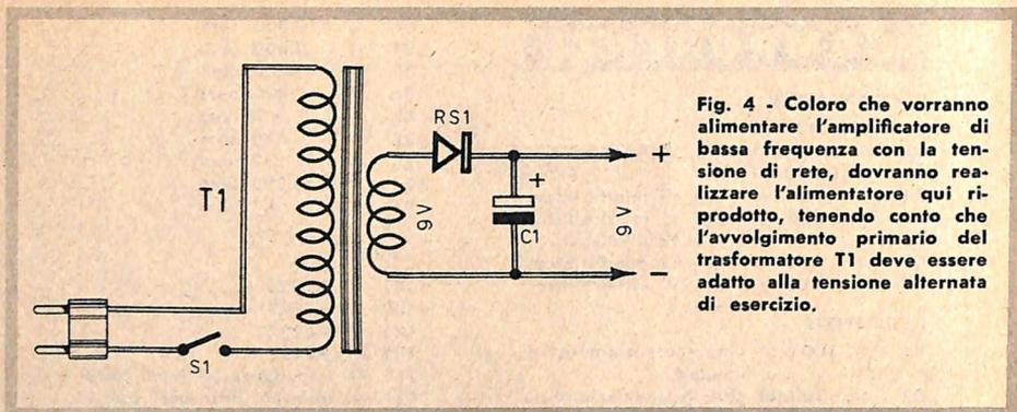
Fig. 4 - Coloro che vorranno alimentare l'amplificatore di bassa frequenza con la tensione di rete, dovranno realizzare l'alimentatore qui riprodotto, tenendo conto che l'avvolgimento primario del trasformatore T1 deve essere adatto alla tensione alternata di esercizio.
