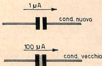
Fig. 4 - I condensatori, invecchiando, alterano il preciso funzionamento di un circuito radioelettrico. Essi possono presentare cortocircuiti, fughe o interruzioni. Anche la capacità, col passare del tempo, può alterarsi, interferendo sul preciso funzionamento del circuito.
