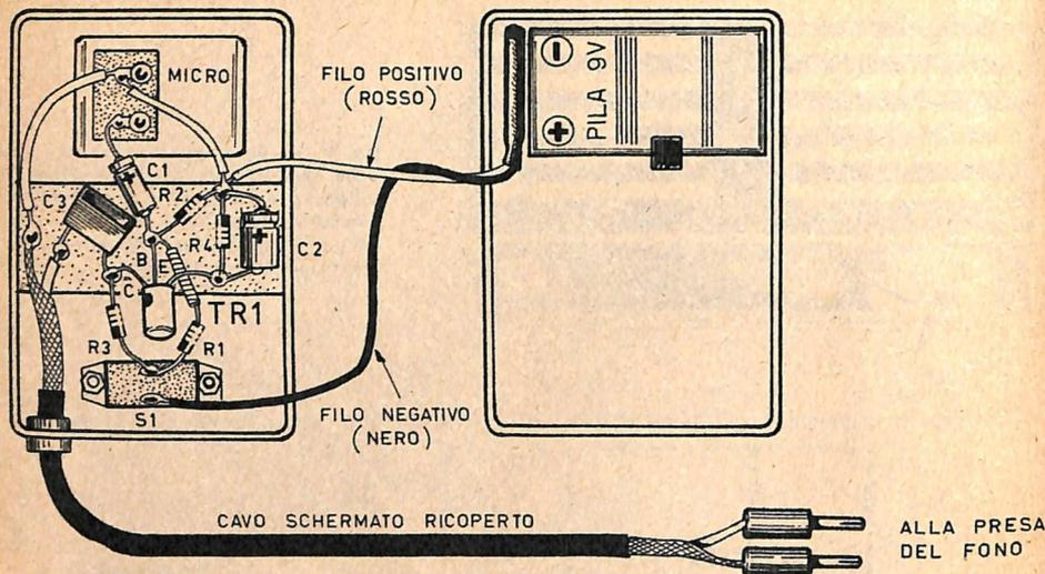
Fig. 3 - Il preamplificatore di bassa frequenza deve essere realizzato dentro un contenitore di plastica, servendosi, per il cablaggio, di una bassetta di bachelite di forma rettangolare; anche la pila a 9 V è inserita dentro lo stesso contenitore. Il conduttore della tensione positiva è rappresentato dalla calza metallica del cavetto che fuoriesce dal contenitore di plastica.
