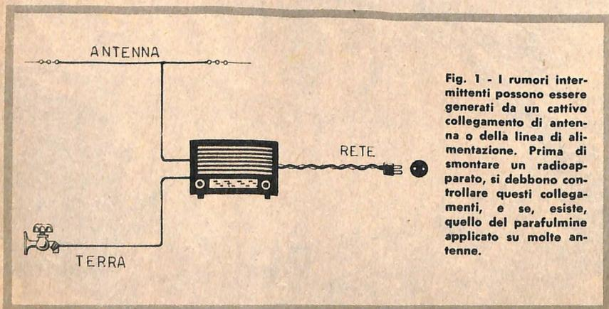
**Fig. 1** - I rumori intermittenti possono essere generati da un cattivo collegamento di antenna o della linea di alimentazione. Prima di smontare un radioapparato, si debbono controllare questi collegamenti, e se, esiste, quello del parafulmine applicato su molte antenne.
