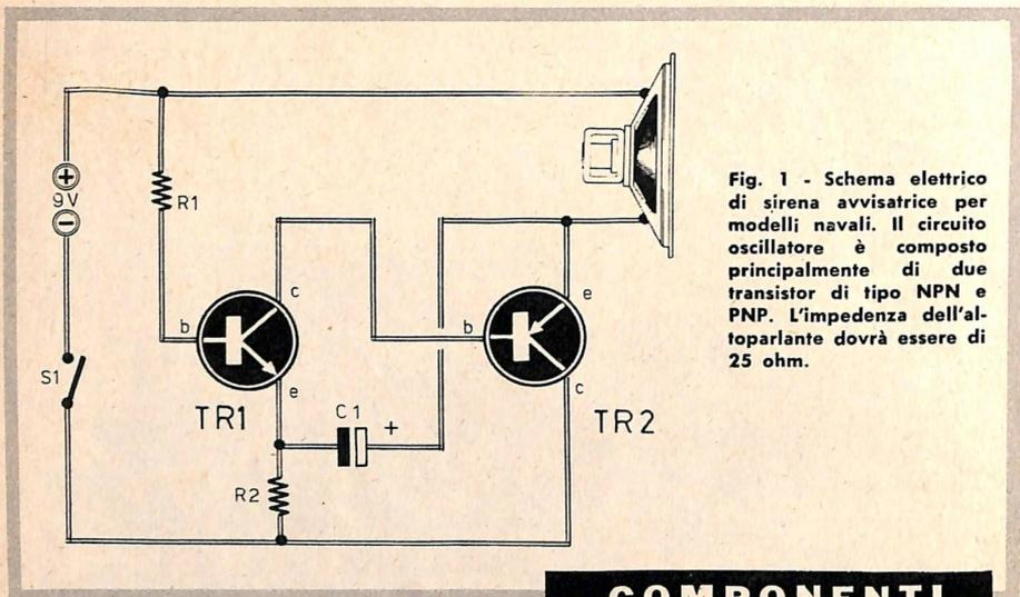
Fig. 1 - Schema elettrico di sirena avvisatrice per modelli navali. Il circuito oscillatore è composto principalmente di due transistor di tipo NPN e PNP. L'impedenza dell'altoparlante dovrà essere di 25 ohm.
