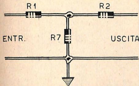
**Fig. 1 - Esempio di attenuatore di segnale di tipo a «T», che conviene sempre realizzare e impiegare in abbinamento con le linee di trasmissione asimmetriche.**
