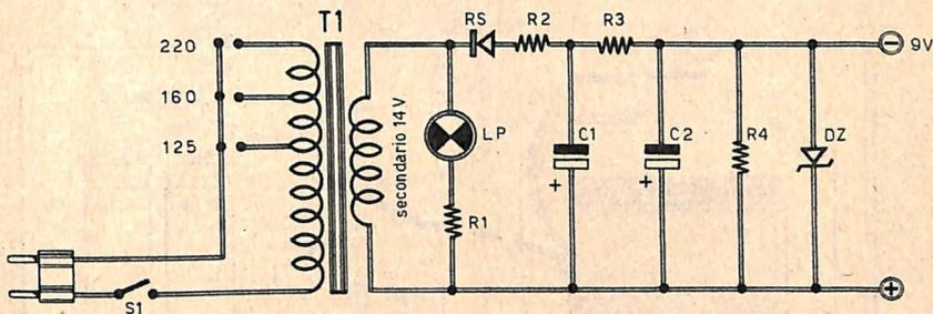
Fig. 1 - Schema elettrico dell'alimentatore stabilizzato per apparati a circuito transistorizzato.
