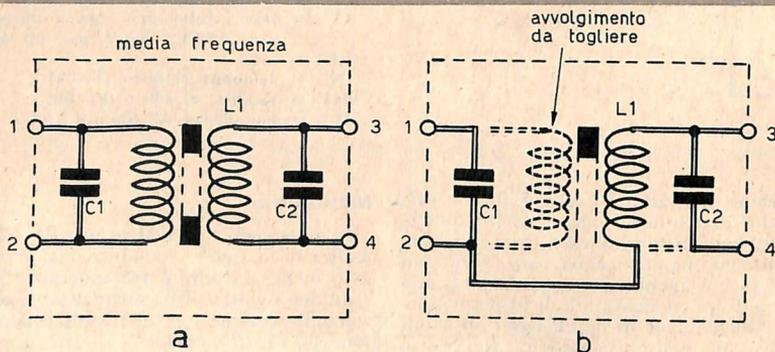
Fig. 3 - La bobina L1 del circuito oscillante è ricavata da un trasformatore di media frequenza (a), sul quale dovranno essere apportate le apposite modifiche descritte nel testo (b).
