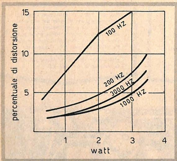
Fig. 3 - Curve caratteristiche della distorsione dell'amplificatore ibrido in funzione della potenza di uscita alle varie frequenze.
