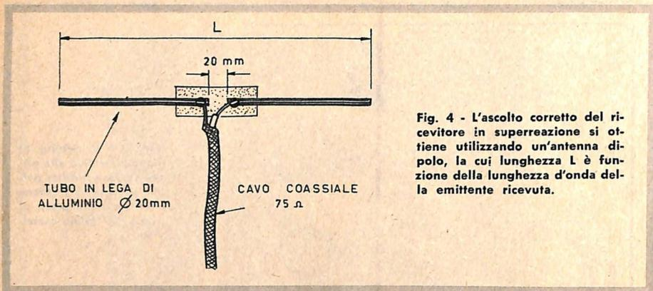
Fig. 4 - L'ascolto corretto del ricevitore in superreazione si ottiene utilizzando un'antenna dipolo, la cui lunghezza  $L$  è funzione della lunghezza d'onda della emittente ricevuta.
