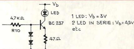
Figura 3. Come pilotare un Led.
