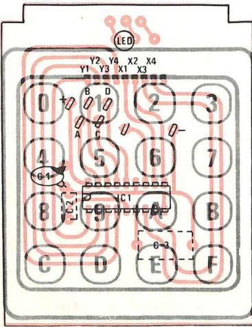
Figura 13. Disposizione dei componenti.
