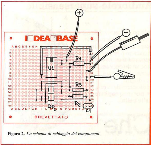
Figura 2. Lo schema di cablaggio dei componenti.
