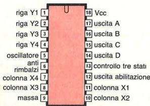
Figura 3. Piedinatura funzionale del CMOS decodificatore
