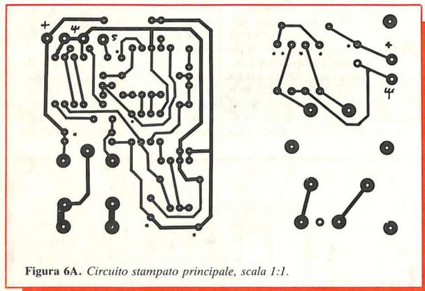
Figura 6A. Circuito stampato principale, scala 1:1.
