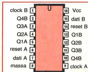
**Figura 7.** Piedinatura funzionale del registro di scorrimento CMOS.
