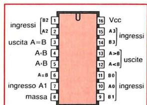
**Figura 5.** Piedinatura funzionale del comparatore CMOS 74C85.
