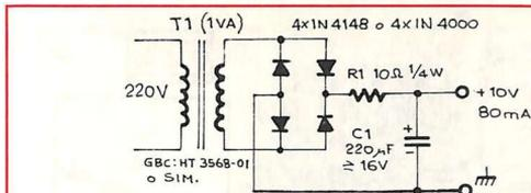
Figura 2. Un semplice circuito alimentatore.
