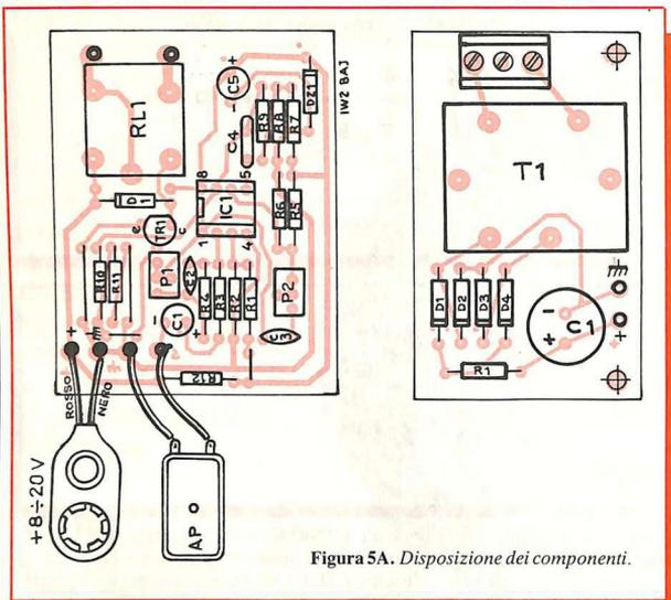
Figura 5A. Disposizione dei componenti.
