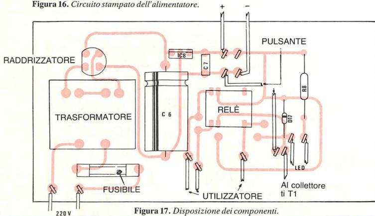
Figura 17. Disposizione dei componenti.
