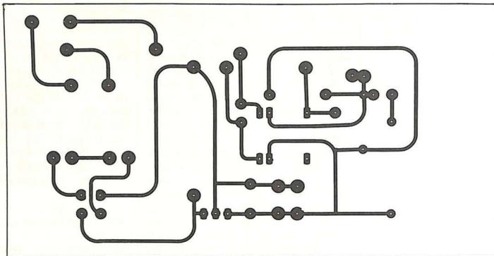
Figura 16. Circuito stampato dell'alimentatore.
