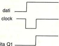
Figura 10. Inversione del segnale di clock.
